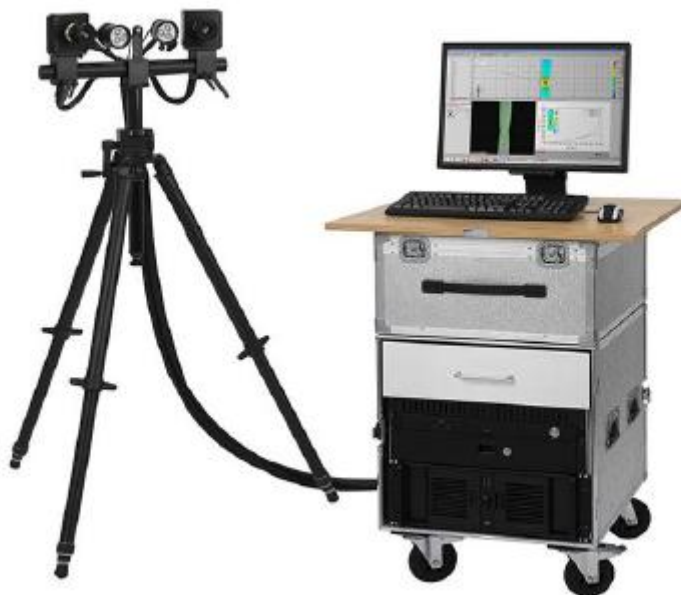
Slika 12. Optički mjerni sustav Aramis [6]
