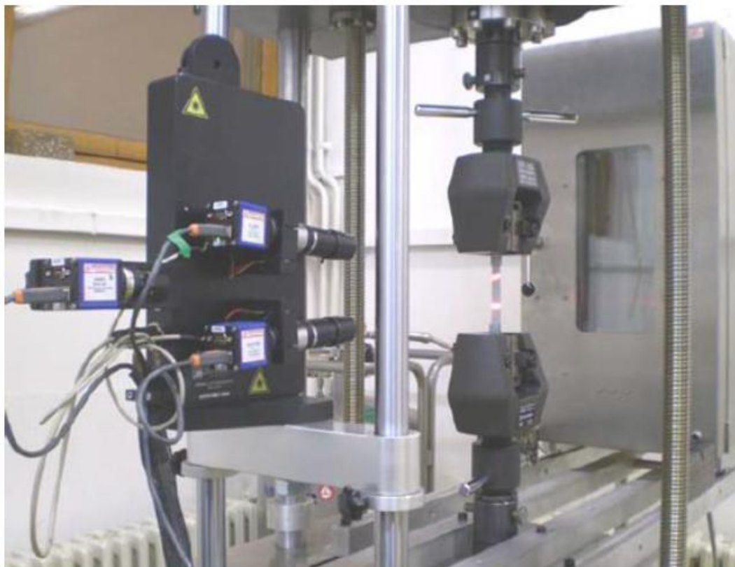
Slika 7. Mjerenje laserskim ekstenzometrom
