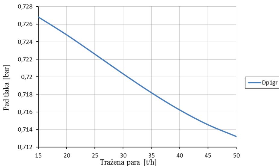
Slika 23. Promjena pada tlaka uslijed gravitacijskog utjecaja
