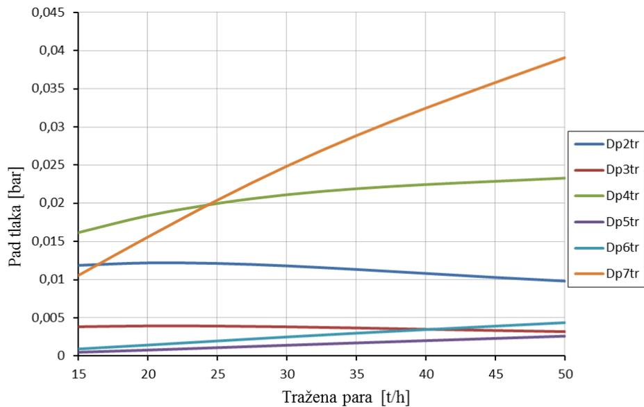
Slika 27. Pad tlaka uslijed trenja u uzlaznim cijevima
