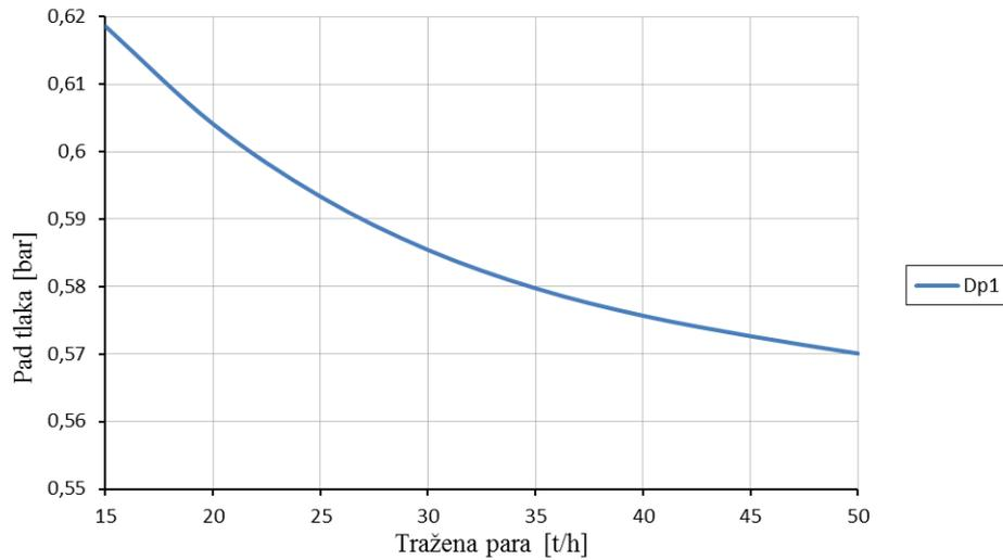
Slika 25. Ukupni pad tlaka u silaznim cijevima
