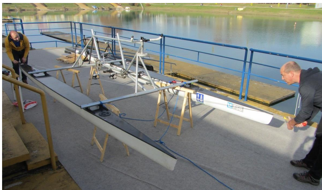
Slika 6. Mjerenje dijagonala trupova
