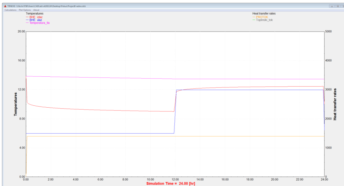
Slika 15. Test hlađenja tla 12 sati
