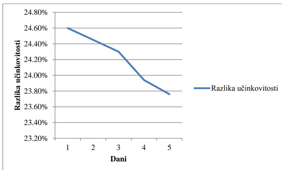
Slika 27. Razlika učinkovitosti između sustava koji koriste BIT i sustava sa zrakom hlađenim kondenzatorom
