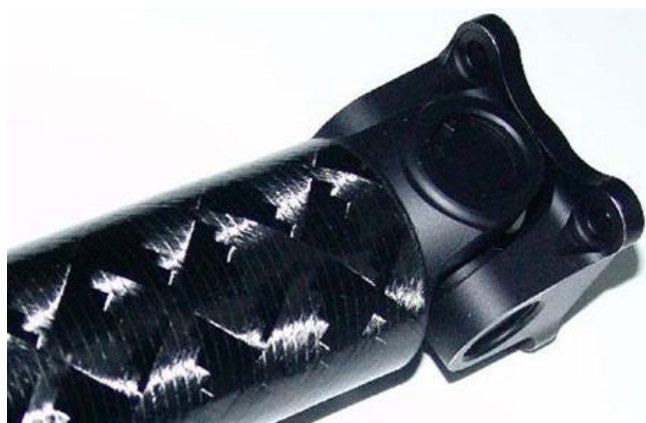
Slika 19. Primjer adhezijskog spoja
