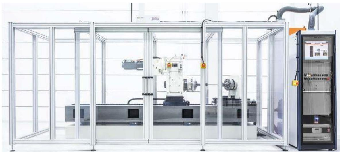
*Slika 27. Uredaj za staticko ispitivanje vratila*
