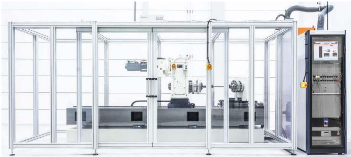
Slika 27. Uređaj za statičko ispitivanje vratila
