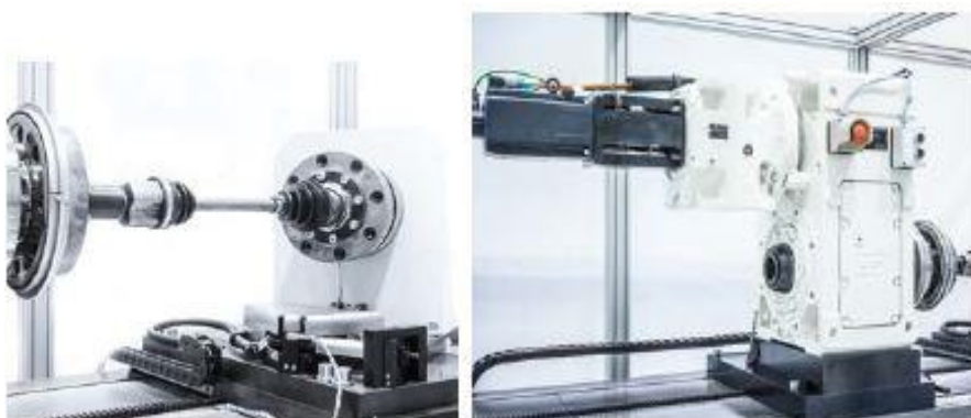
Slika 28. Jedinica za savijanje i uvijanje vratila
