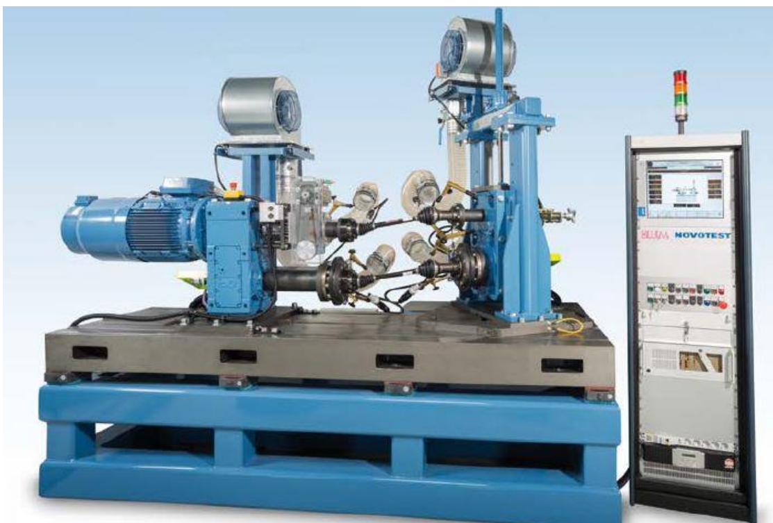
Slika 29. Dinamička kidalica tvrtke Blum - Novotest
