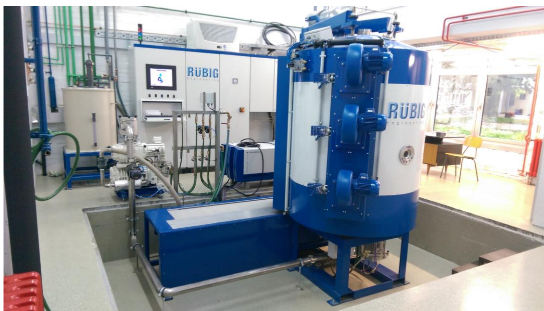
Slika 3.3 Uređaj za prevlačenje Rübiger PC 70/90
