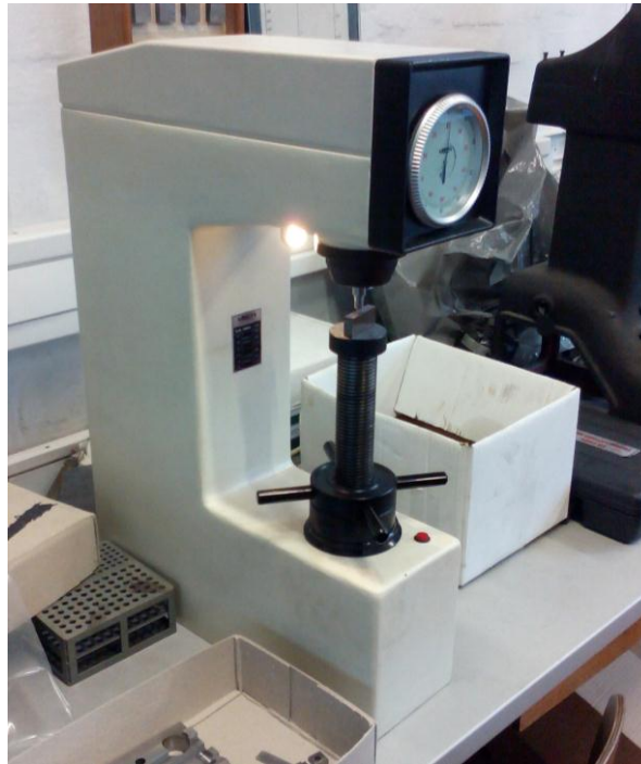
Slika 3.11 Rocwellov tvrdomjer u laboratoriju za toplinsku obradu FSB-a
