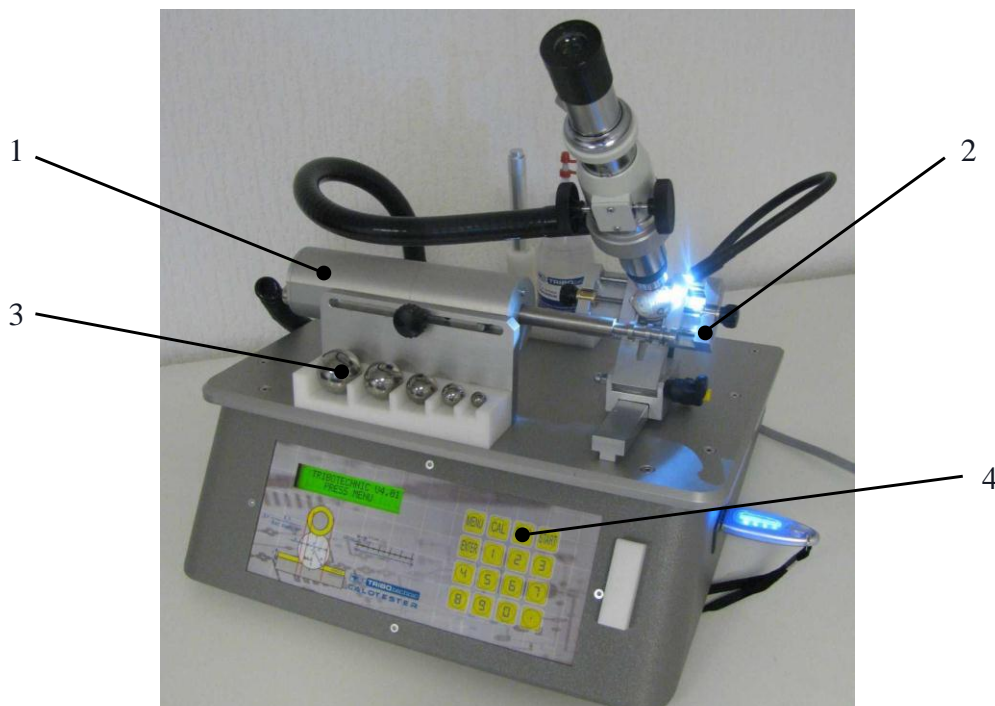
Slika 3.7 Kalotester tvrtke TRIBOtechnik [12]
