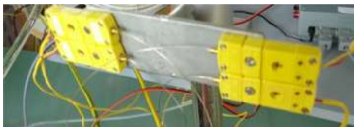
Slika 40. Osjetnik temperature (termopar) K – tip [2].
