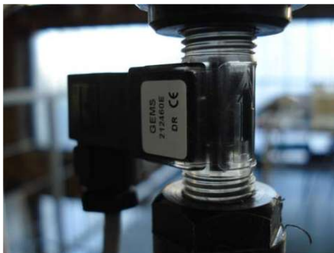
Slika 42. Mjerni osjetnik protoka: FT – 210 [2].
