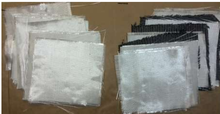
Slika 27. Slojevi staklenih i ugljičnih ojačanja
