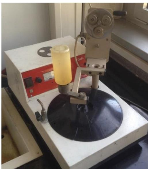
Slika 29 Uređaj za pripremu metalografskih uzoraka poliranjem
