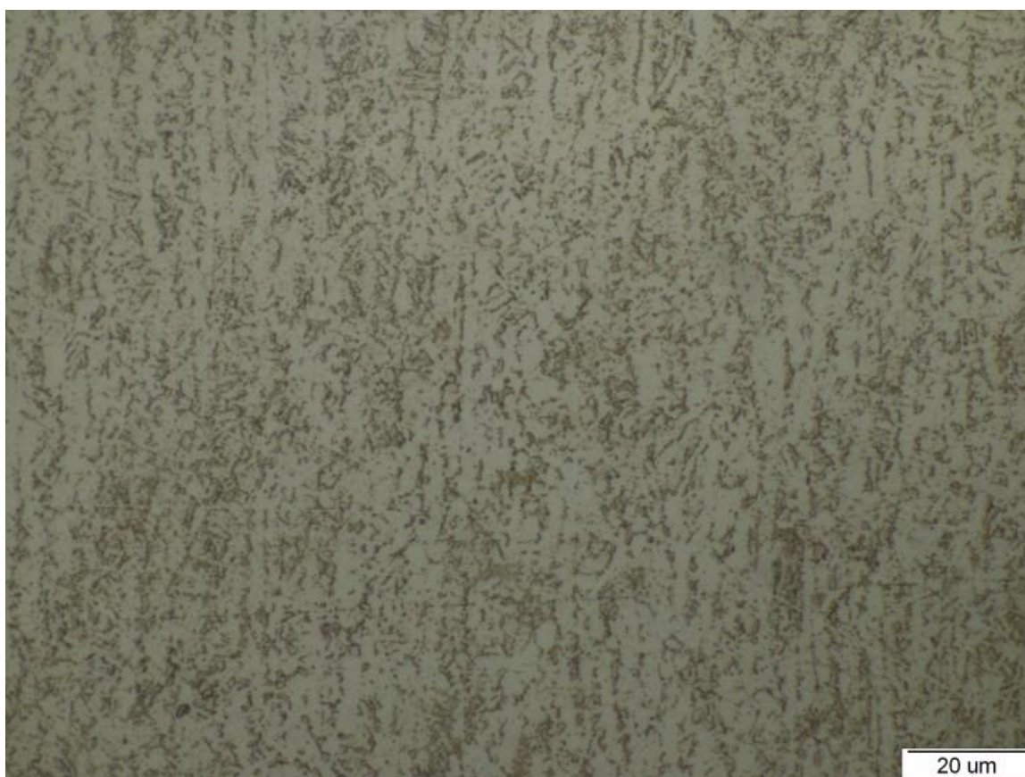
Slika 30 Jezgra uzorka Ti6Al4V legure na svjetlosnom mikroskopu pri povećanju 1000:1
