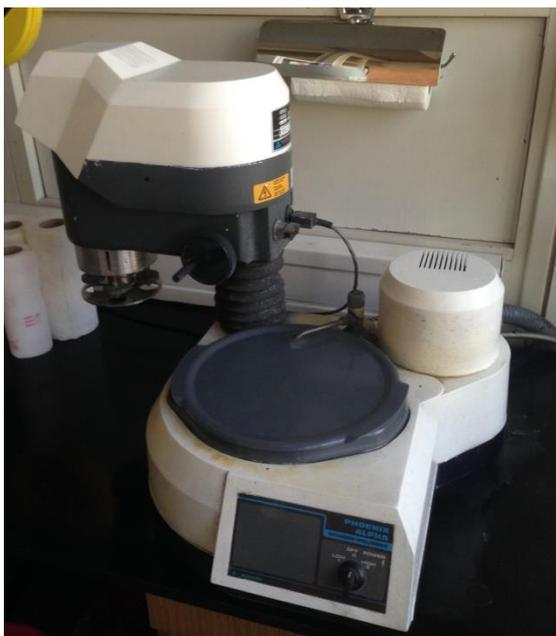
Slika 28 Uređaj za strojno brušenje metalografskih uzoraka
