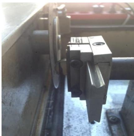
Slika 26 Metalografska rezalica s dijamantnom reznom pločom
