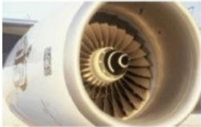
Slika 5 Mlazni motor izrađen od titanove legure [1]
