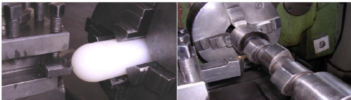
Slika. 10. Profilno tokarenje (lijevo) i neokruglo tokarenje (desno) [8]
