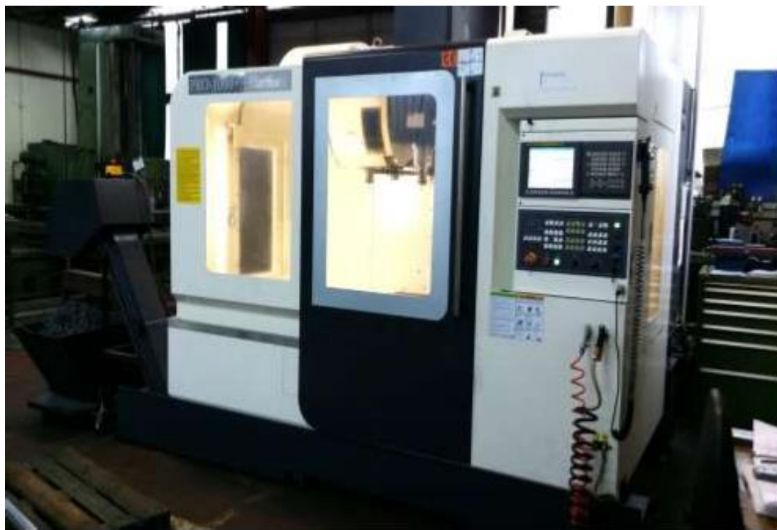
Slika. 22. Troosna CNC glodalica Hartford PRO 1000 [21]
