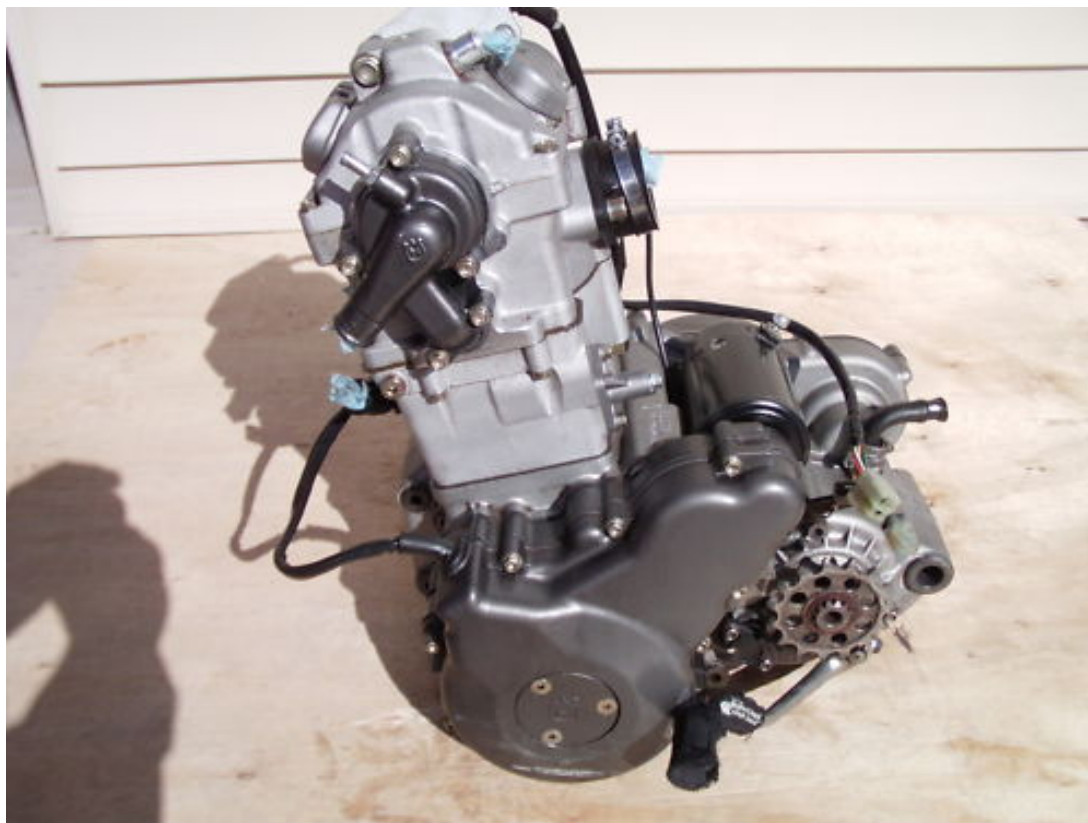
Slika 4. Jednocilindrični motor proizvođača Husqvarna, mase 42 kg
