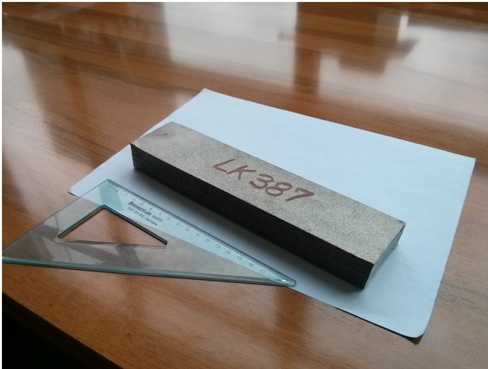
Slika 30. Odljevak od dupleks nehrđajućeg čeličnog lijeva
