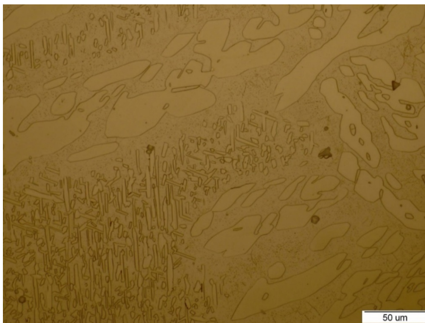
Slika 25. Mikrostruktura dupleks nehrđajućeg čeličnog lijeva
