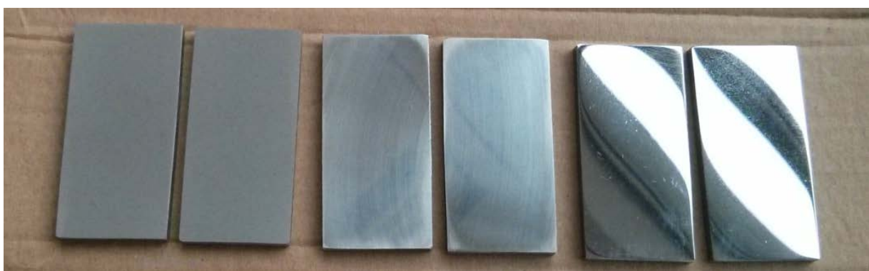
Slika 53. Pjeskareni, brušeni i polirani uzorci
