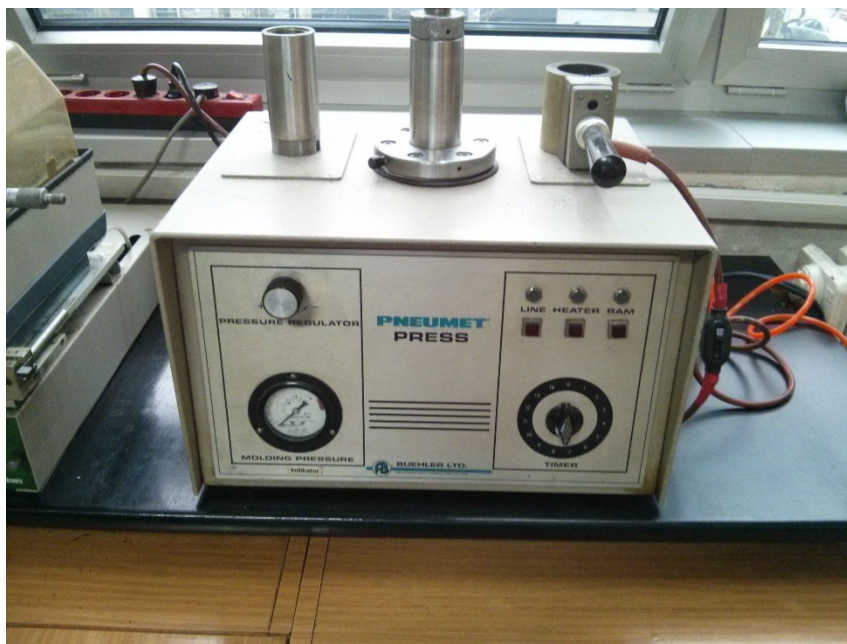
Slika 33. uređaj za ulijevanje Buehler Pneumett Press
