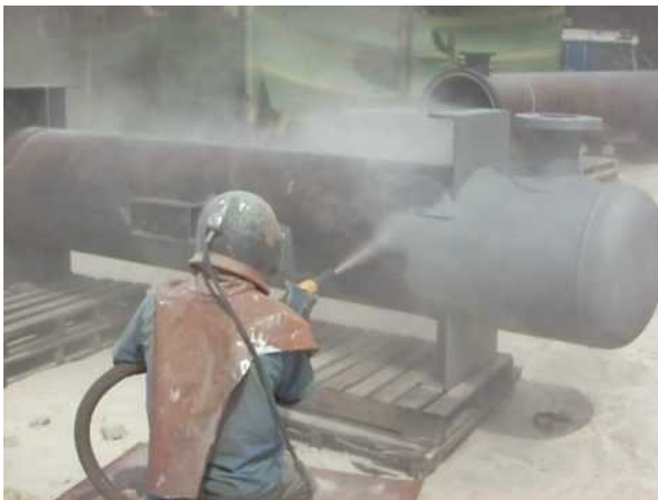
Slika 4. Postupak obrade mlazom [6]
