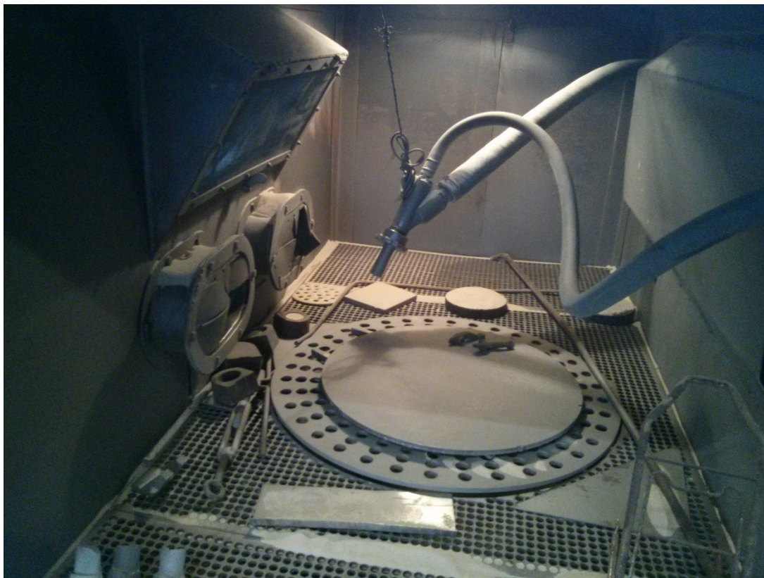
Slika 51. Unutrašnjost uređaja za pjeskarenje
