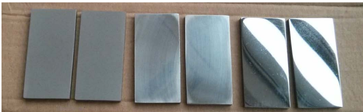
Slika 53. Pjeskareni, brušeni i polirani uzorci
