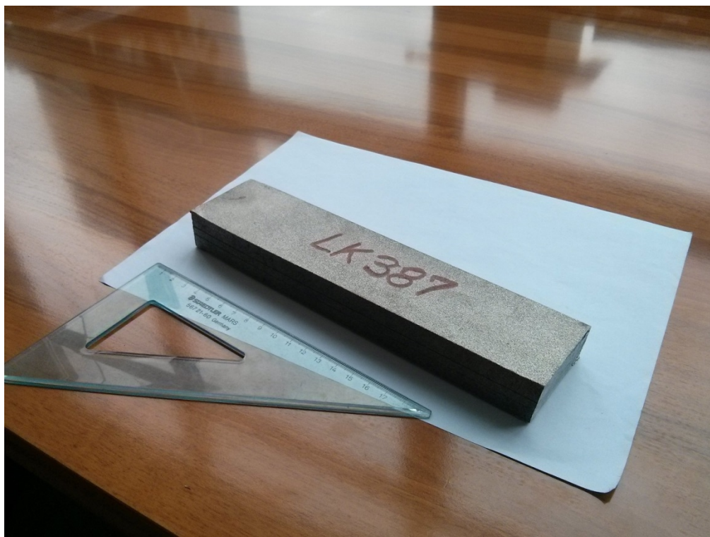
Slika 30. Odljevak od dupleks nehrđajućeg čeličnog lijeva
