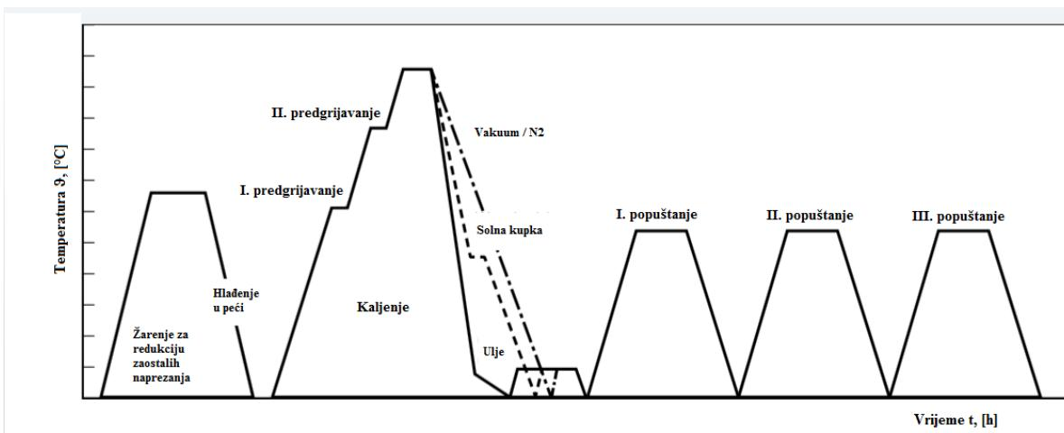
Slika 4. Dijagram postupka klasične toplinske obrade čelika K490MC [3]
