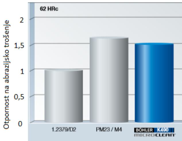
**Slika 10.** Otpornost na abrazivsko trošenje čelika K490 u odnosu na uobičajene alatne čelike za hladni rad [3]
