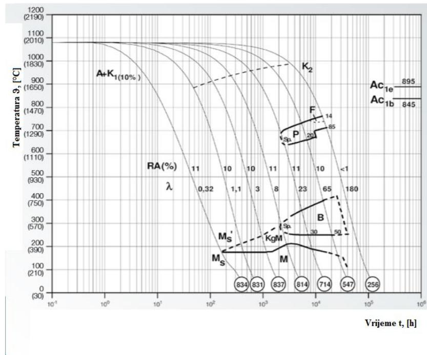
Slika 2. Kontinuirani TTT dijagram alatnog čelika K490MC [3]
