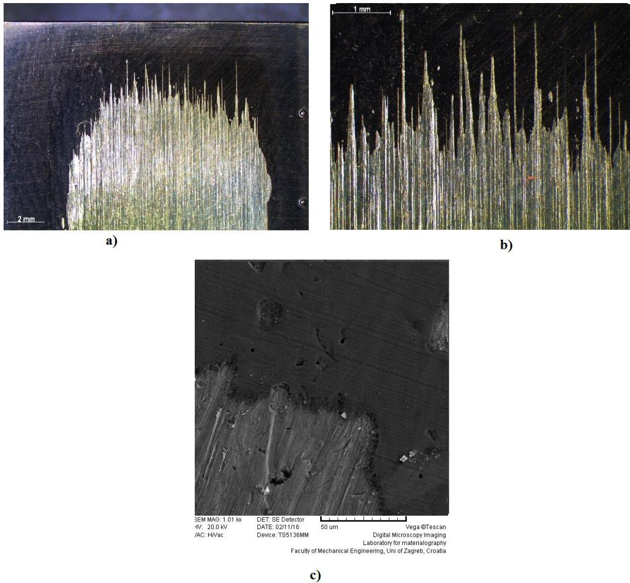
**Slika 41.** a) *Trag trošenja na uzorku BX4 s povećanjem 7,88:1*
