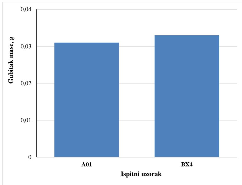
**Slika 39.** Uкупni gubitak mase abrazijom uzorka A01 i BX4 nakon 500 okretaja kotača metodom trošenja „suhu pjesak/gumeni kotač“
