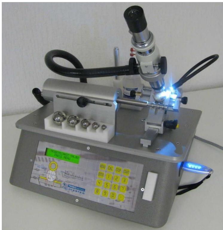
Slika 32. Uređaj za ispitivanje debljine prevlake na FSB-u
