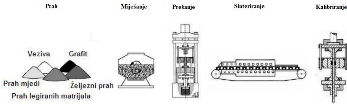
**Slika 1.** Postupak proizvodnje čelika metalurgijom praha [2]
