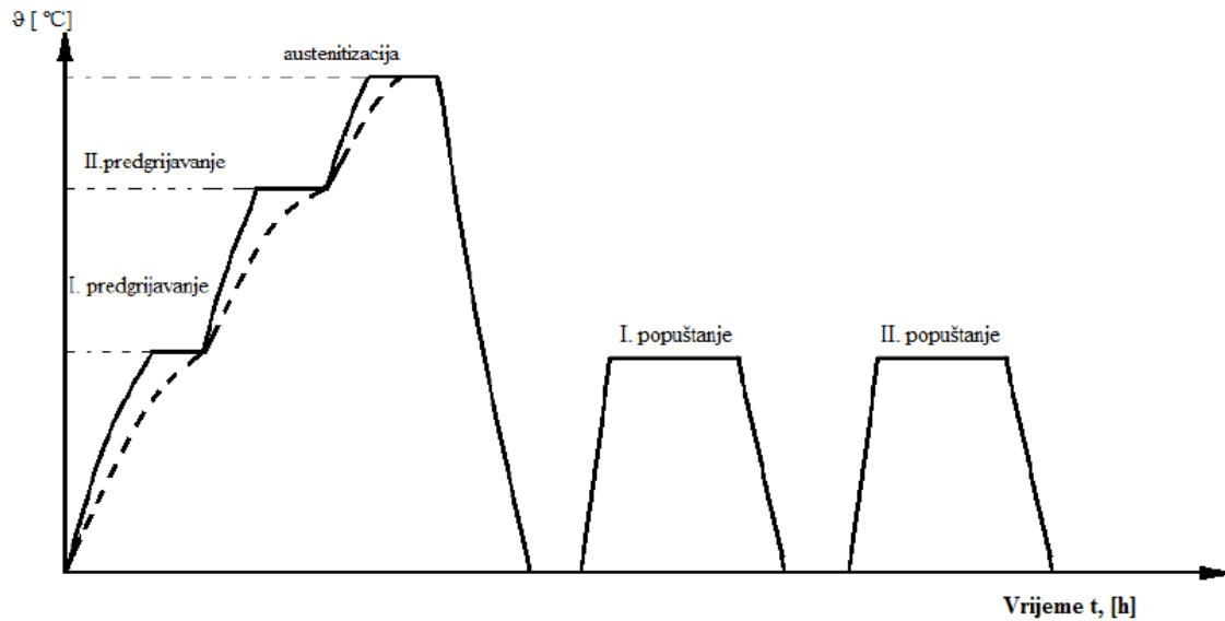
**Slika 27.** Shematski prikaz toplinske obrade uzorka A01
