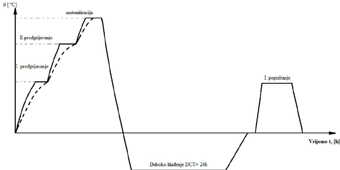
**Slika 28.** Shematski prikaz toplinske obrade uzorka BX4
