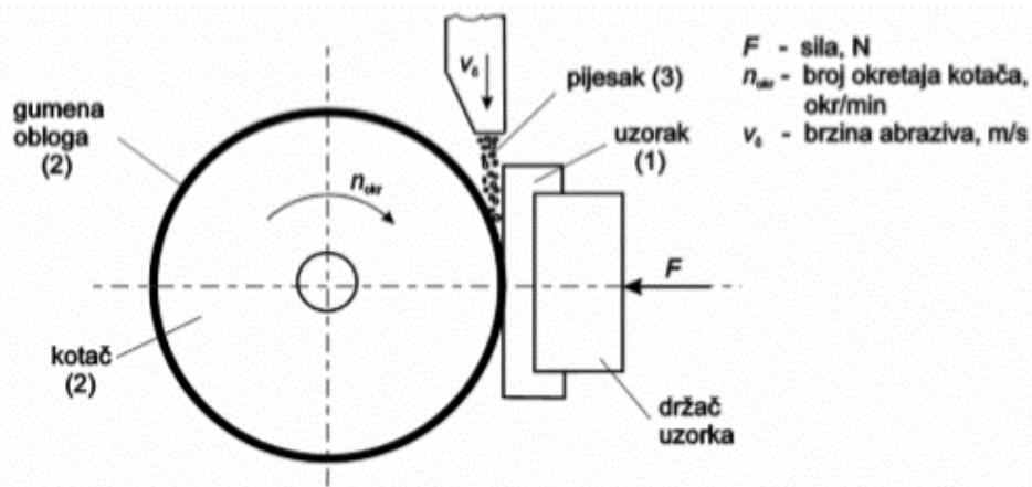
**Slika 23. Skica uređaja „suhu pijesak/gumeni kotač“ [15]**
