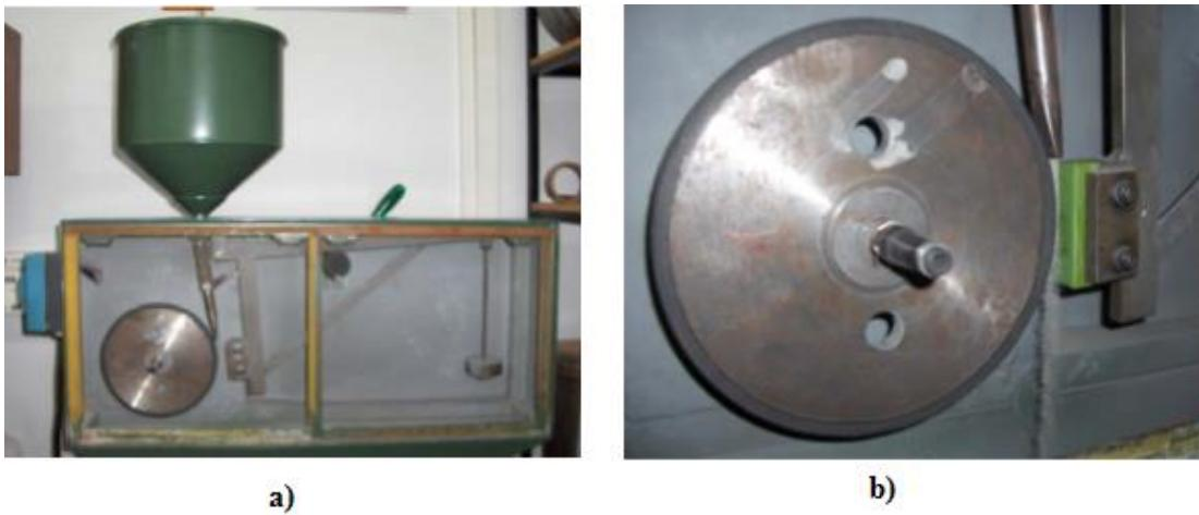
**Slika 25.** Uredaj (a) i detalj uređaja (b) za ispitivanje metodom „suhu pjesak/gumeni kotač“ [15]
