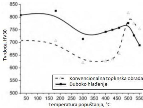
**Slika 6.** Dijagram ovisnosti tvrdoće o temperaturi popuštanja kod konvencionalno i dubokim hlađenjem obrađenih čelika [4]
