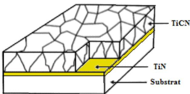
**Slika 13.** Shematski prikaz strukture PACVD prevlake TiN/TiCN
