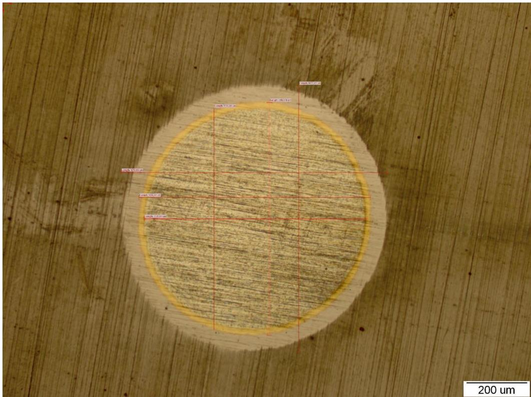
**Slika 36.** Prikaz kalote na svjetlosnom mikroskopu
