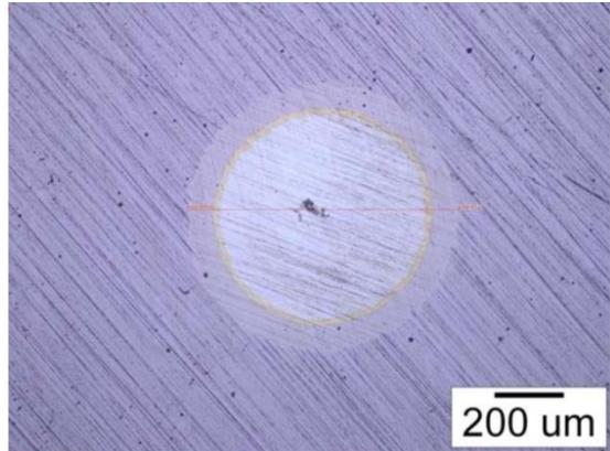
**Slika 21.** Površina uzorka nakon ispravno provedenog ispitivanja kalotestom [13]
