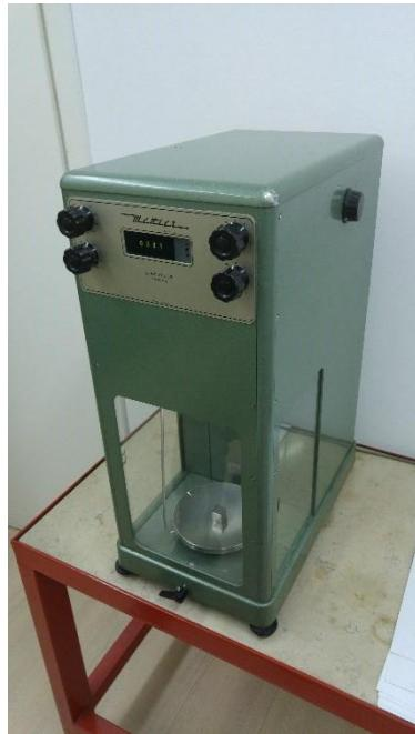
**Slika 35.** Vaga "Mettler" Zurich (Laboratorij za tribologiju FSB-a)
