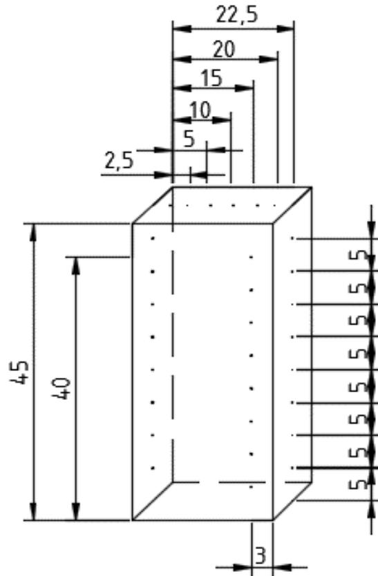
**Slika 31.** Prikaz položaja otiska pri ispitivanju adhezivnosti prevlake
