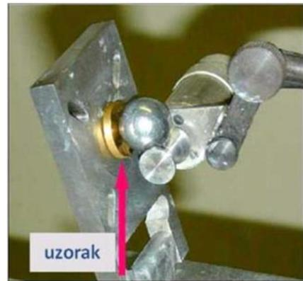
**Slika 19.** Uzorak postavljen na uređaju za ispitivanje debljine prevlake [13]
