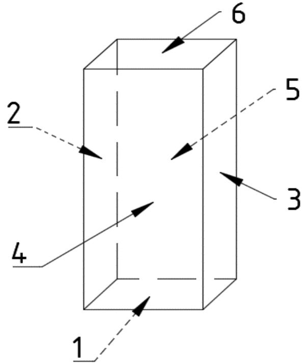
**Slika 30.** Prikaz označavanja površina ispitnog uzorka
