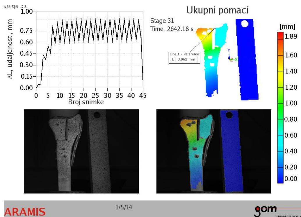
**Slika 25.** Promjena duljine frakturne pukotine modela sa Synthes dorzalnim pločicama za svaki 100-ti ciklus opterećenja
