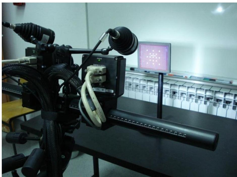
Slika 16. Kalibracija sustava s kalibracijskim objektom CP20 90x72
