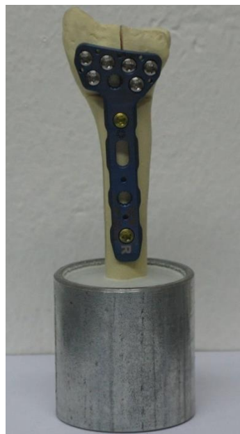
Slika 11. Model sa Zrinski pločicom nakon polimerizacije PMMA
