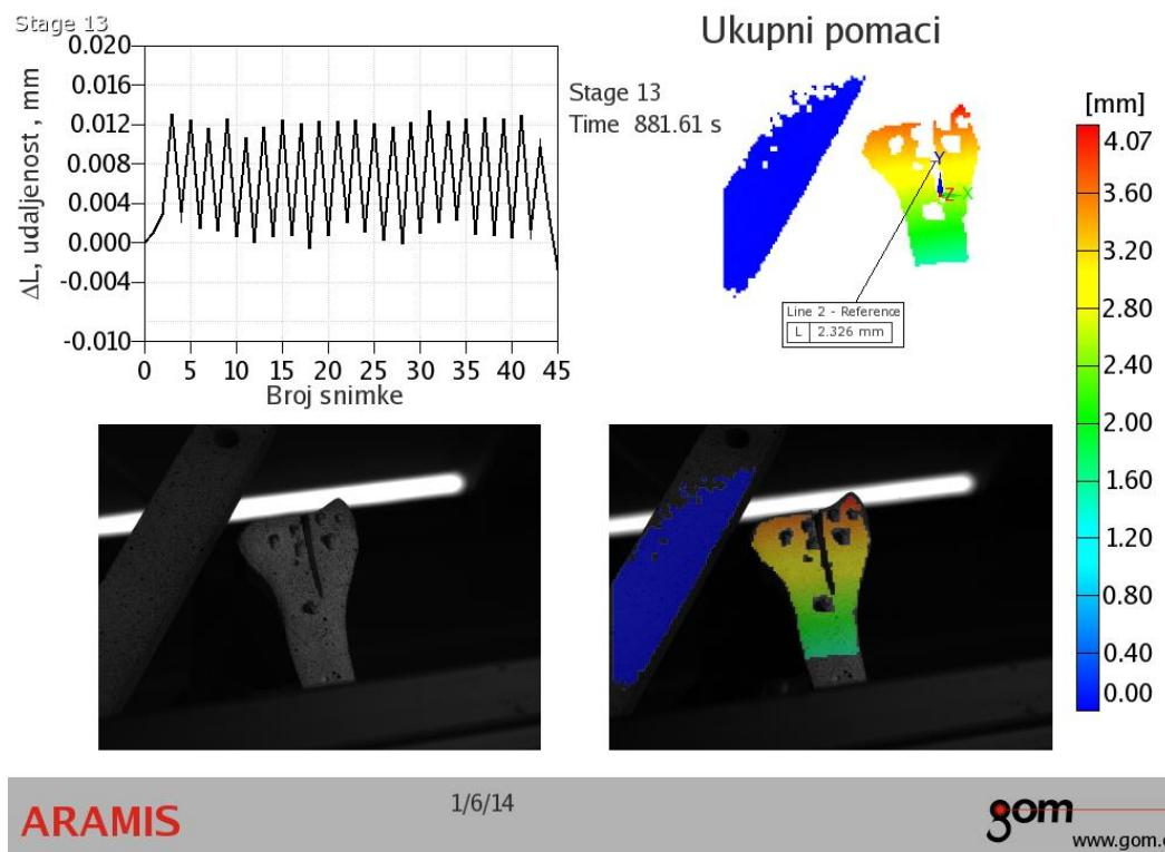
**Slika 29. Promjena duljine frakturne pukotine modela sa Synthes dorzalnim pločicama za svaki 100-ti ciklus**
