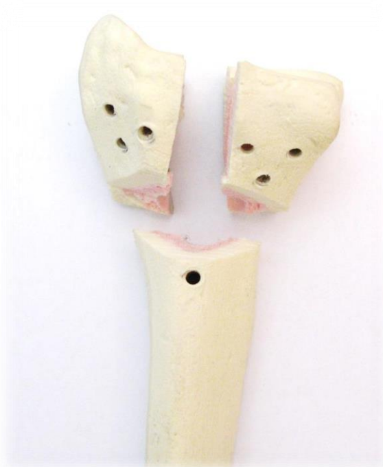
Slika 6. Model umjetne kosti nakon osteotomije
