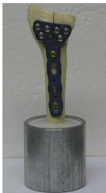
Slika 11. Model sa Zrinski pločicom nakon polimerizacije PMMA
