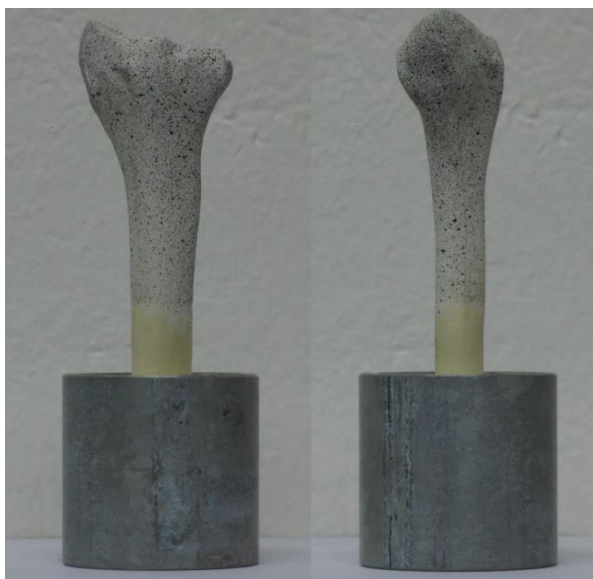
Slika 14. Ispitni modeli distalnog radijusa nakon nanošenja teksture
