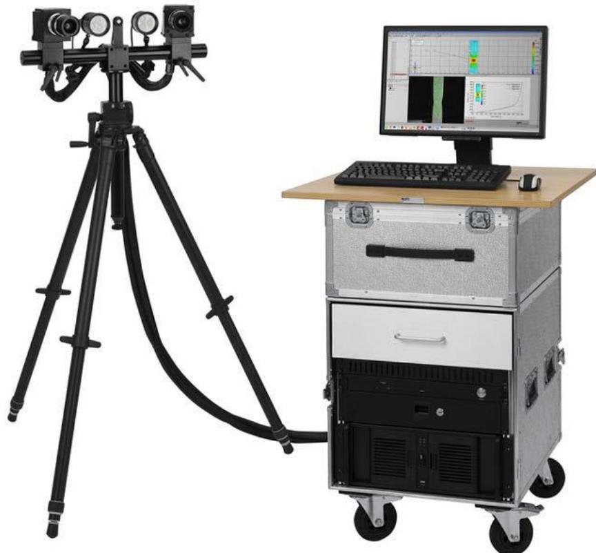
**Slika 13. Optički mjerni sustav Aramis**
