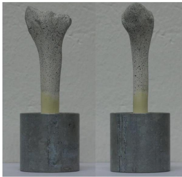
**Slika 14. Ispitni modeli distalnog radijusa nakon nanošenja teksture**
