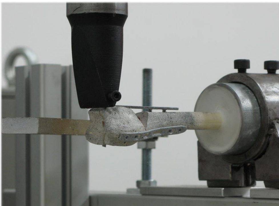
Slika 20. Eksperimentalni postav pri dorzalnom savijanju
