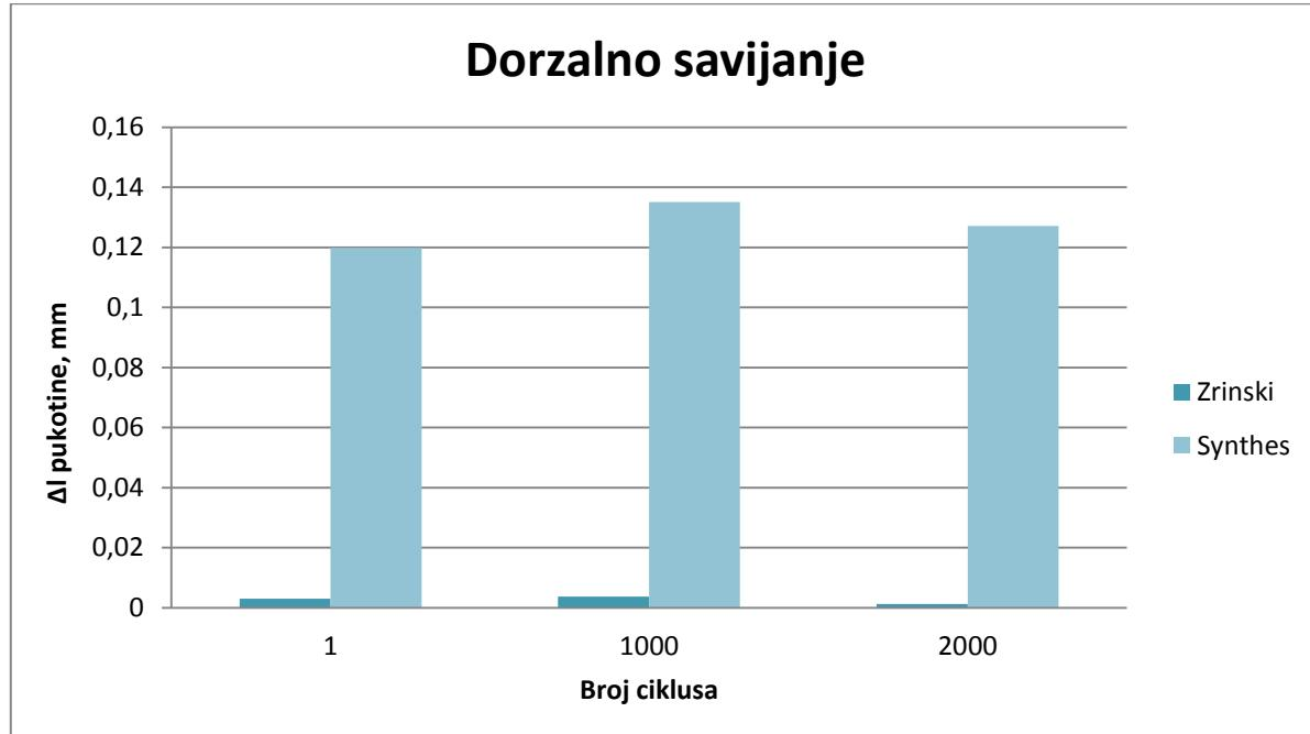
Slika 31. Usporedba srednjih vrijednosti promjene duljine pukotine kod modela sa Synthes i Zrinski pločicama pri dorzalnom savijanju
