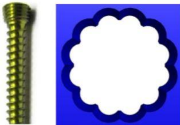
Slika 7. Vijak s narezanom glavom i oblik rupe za vijak na novokonstruiranoj pločici tvrtke Zrinski
