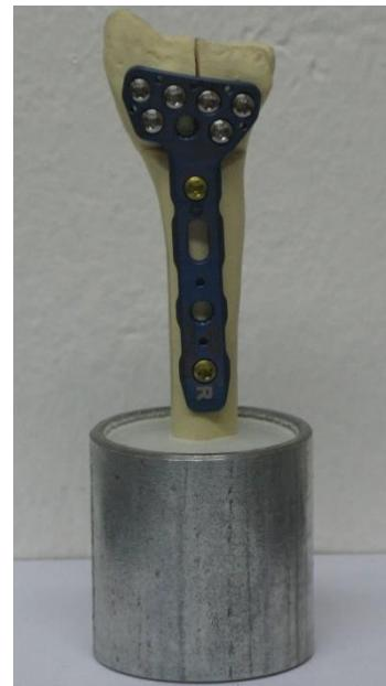
**Slika 11.** Model sa Zrinski pločicom nakon polimerizacije PMMA
