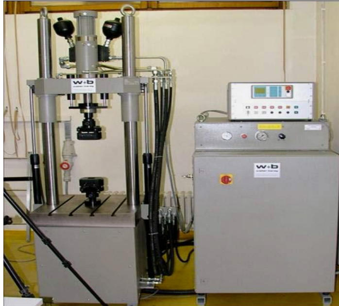
Slika 12. Servo-hidraulička umaralica Walter+Bai LFV-50-HH
