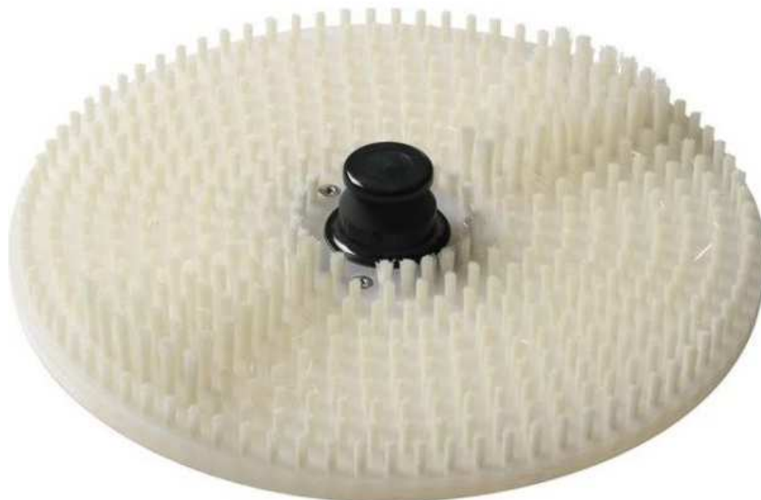
Slika 10 Ploča za ljuštenje PPC [5]
