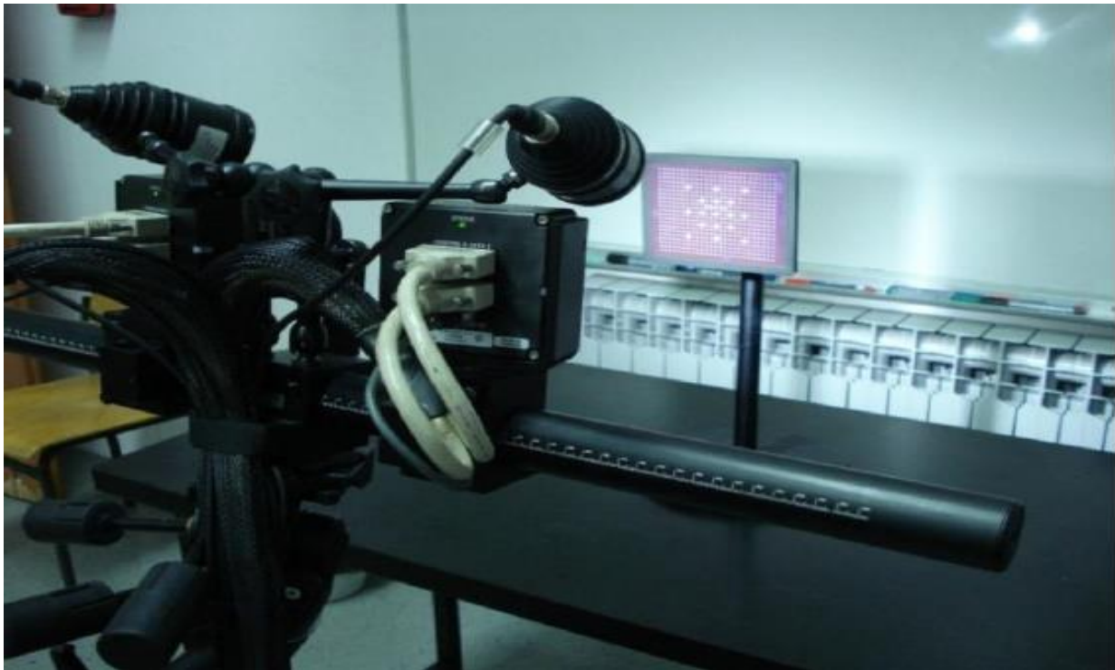
Slika 17. Kalibracija optičkog sustava Aramis
