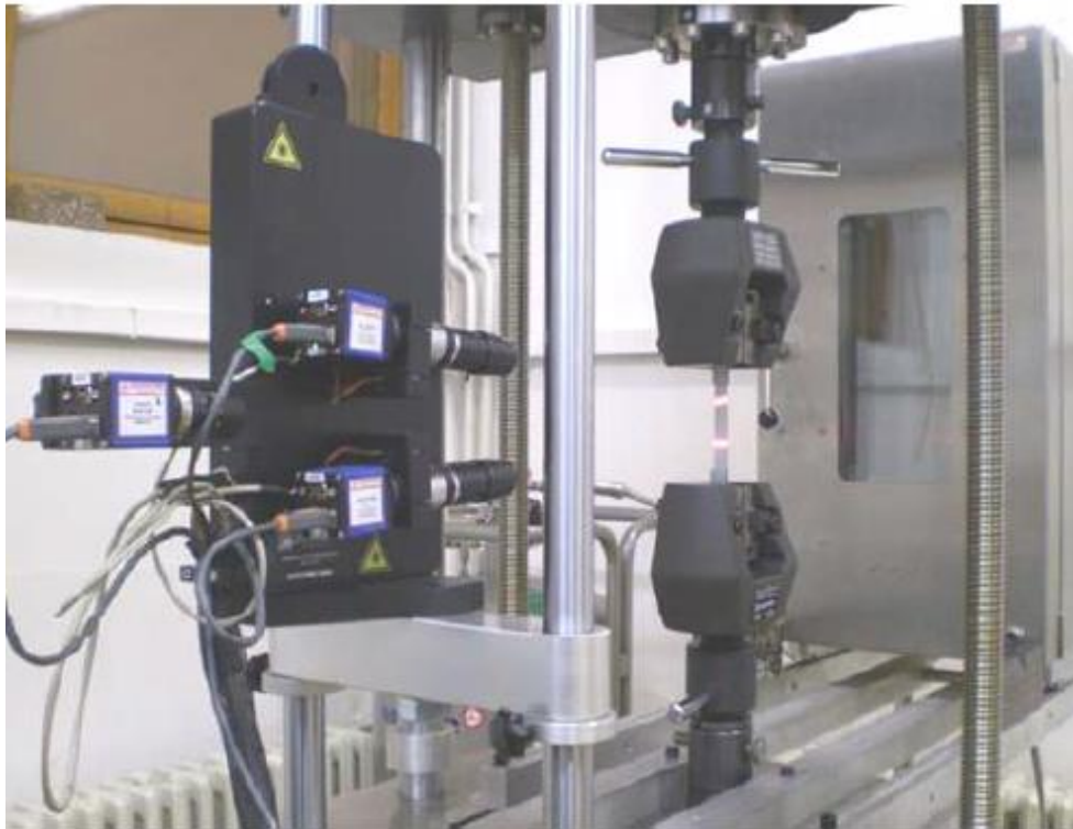
Slika 6. Mjerenje pomaka laserskim ekstenzometrom [1]
