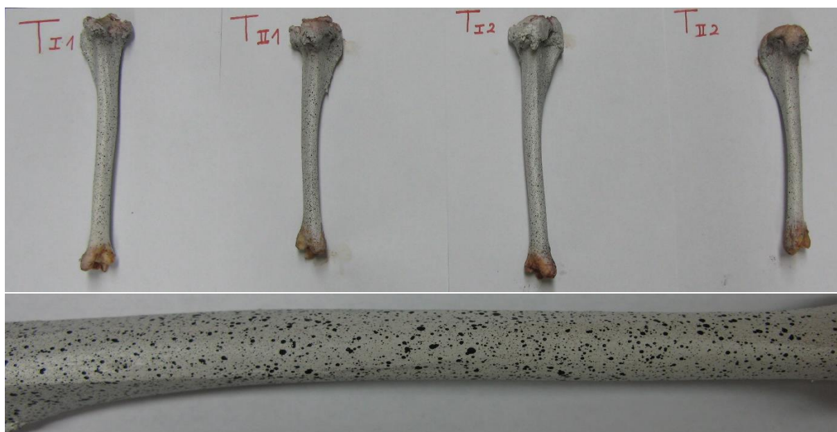
Slika 20. Dobiveni stohastički uzorak na ispitnim uzorcima
