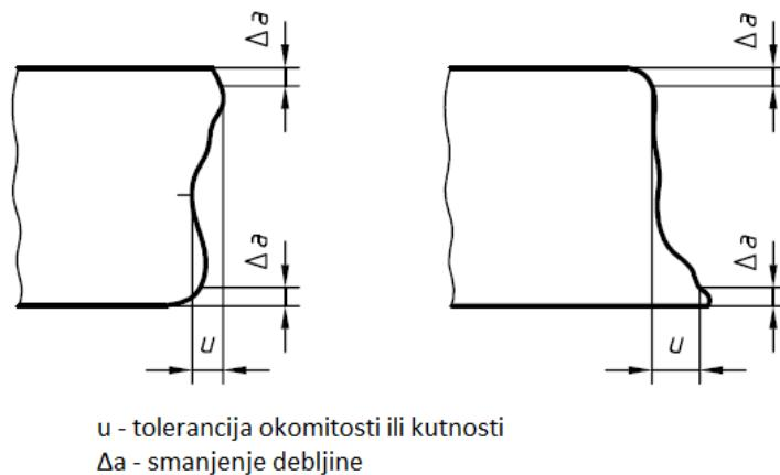
Slika 24. Prikaz tolerancije okomitosti, vertikalni rez [10]
