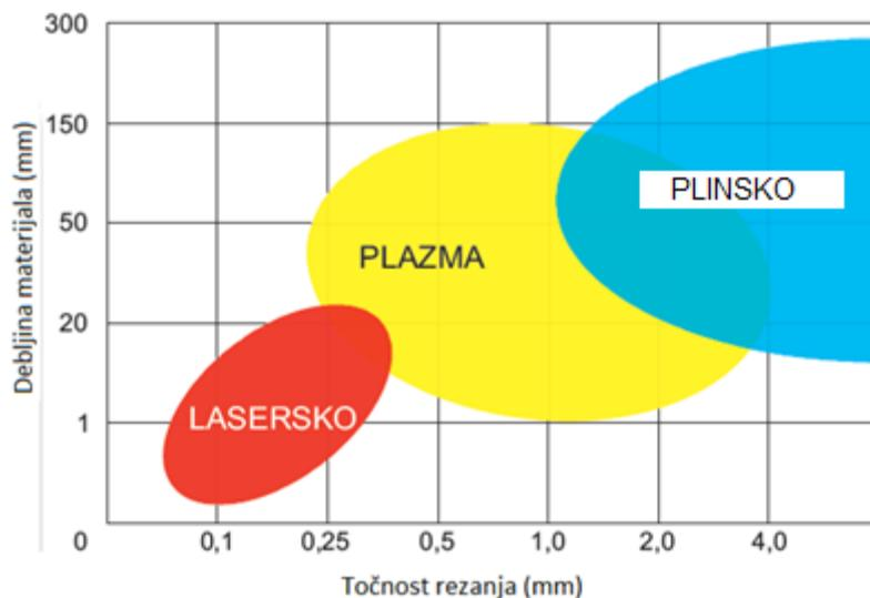
Slika 20. Prikaz točnosti primjenom toplinskih postupaka rezanja [8]
