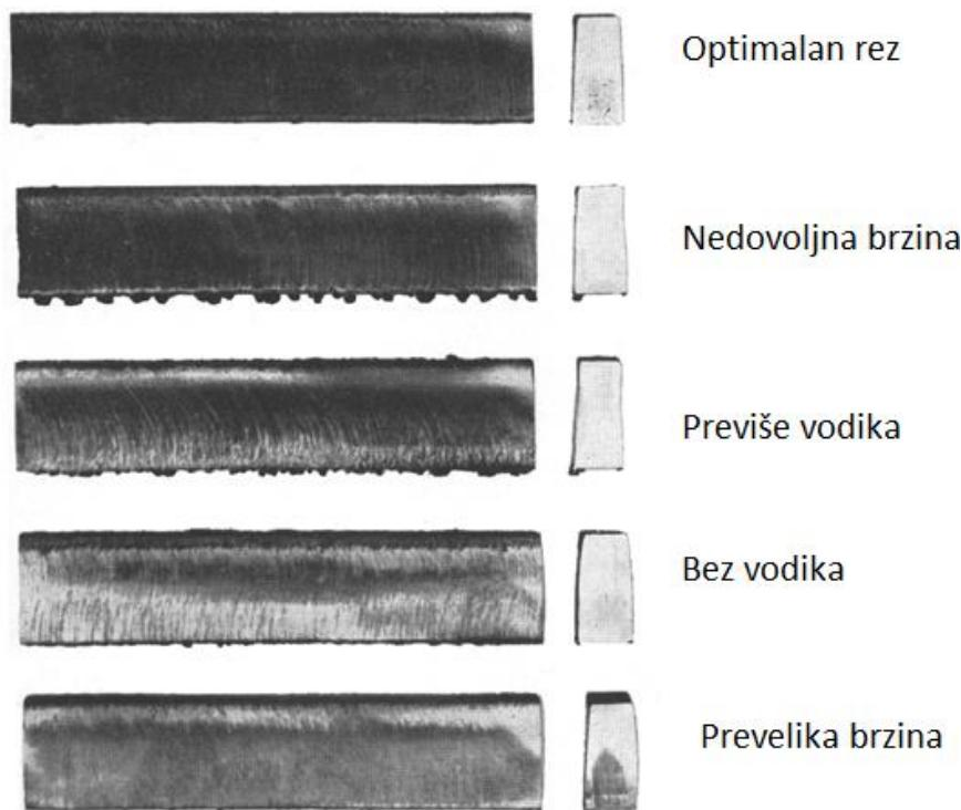
Slika 17. Prikaz različitih presjeka rezova u ovisnosti o izabranim parametrima [1]
