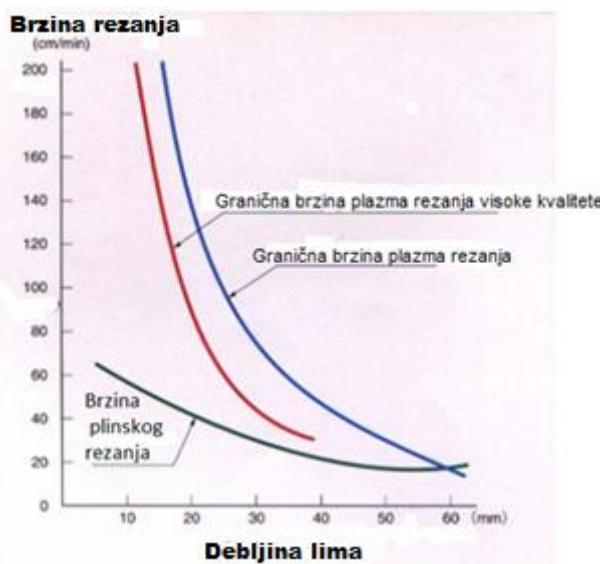
Slika 16. Ovisnost brzine rezanja o debljini materijala [1]
