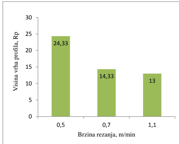
Slika 36. Prikaz ovisnosti visine vrha profila (Rp) i brzine rezanja (debljina 10 mm)
