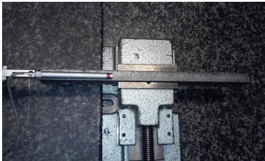
Slika 34. Mjerenje hrapavosti na uzorcima
