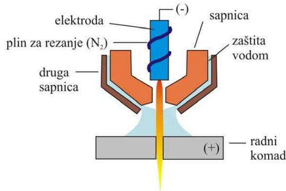
Slika 12. Rezanje plazmom s vodenom zaštitom [1]
