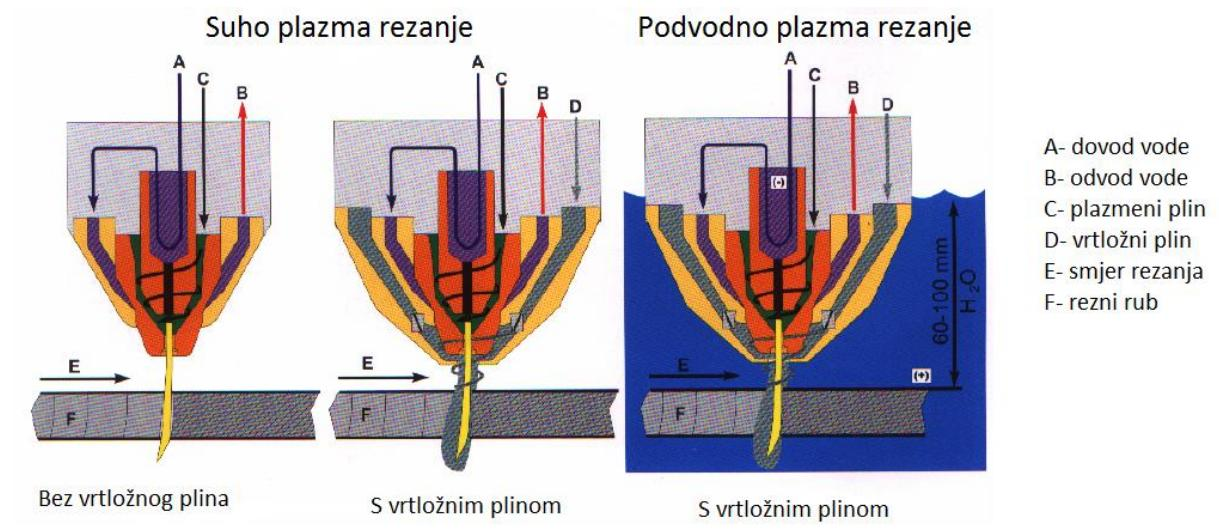
Slika 18. FF gorionici s "vrtložnim" sekundarnim plinom [1]
