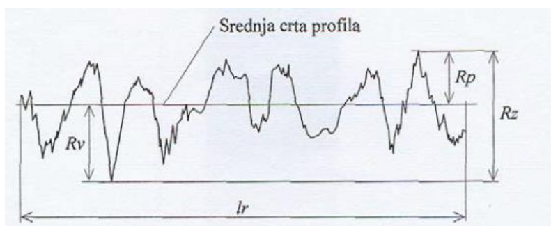
Slika 29. Prikaz najveće visine profila unutar referentne duljine ( R_z ) [11]
