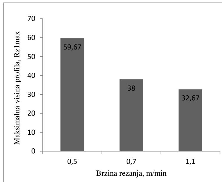
Slika 40. Prikaz ovisnosti maksimalne visine profila ( $Rz_1$ <sub>max</sub>) i brzine rezanja (debljina 10 mm)
