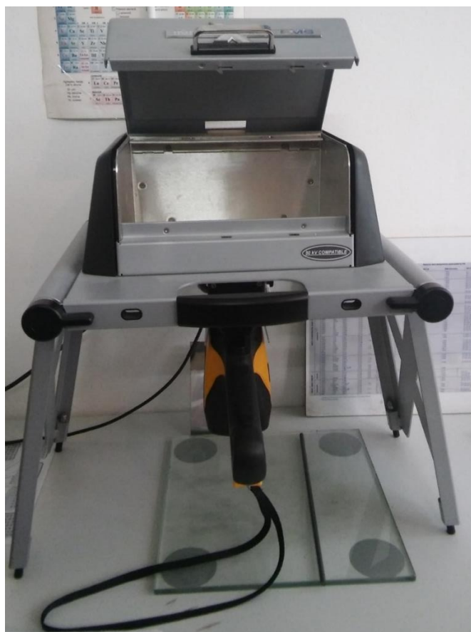
Slika 4.10: Uređaj za rendgensku fluorescentnu analizu, XRF
