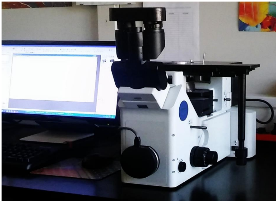
Slika 4.7: Svjetlosni mikroskop „Olympus GX 51“
