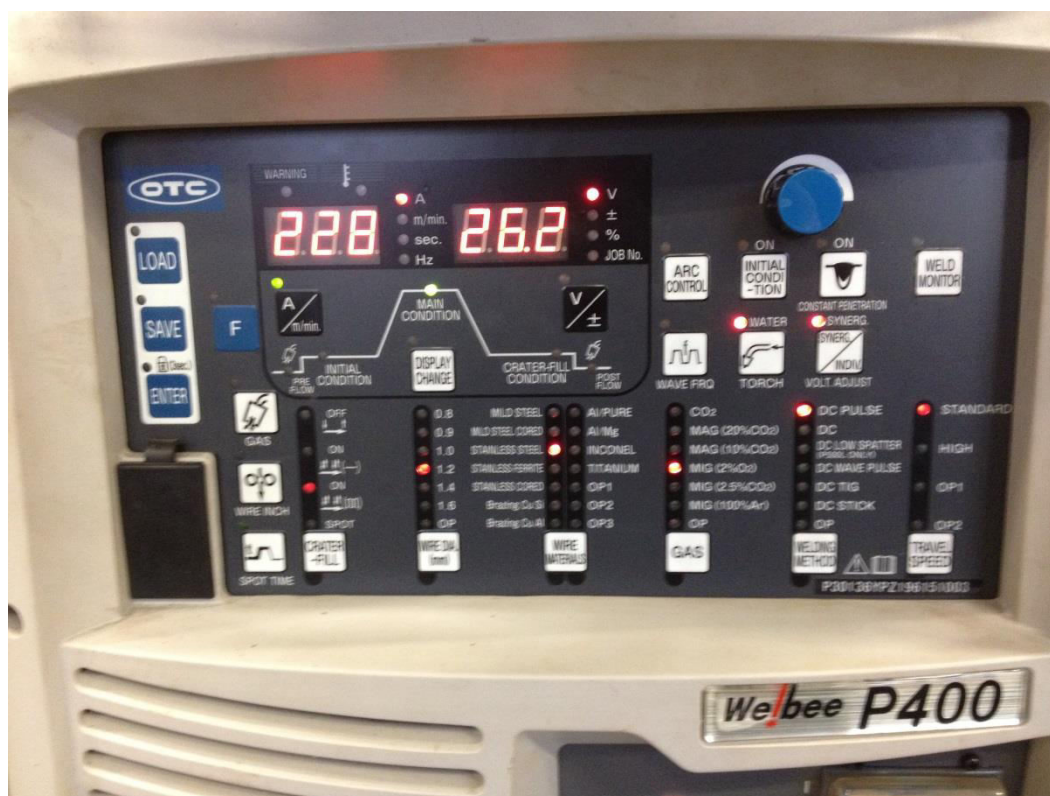
Slika 24. Podešeni parametri za zavarivanje uzorka „B“
