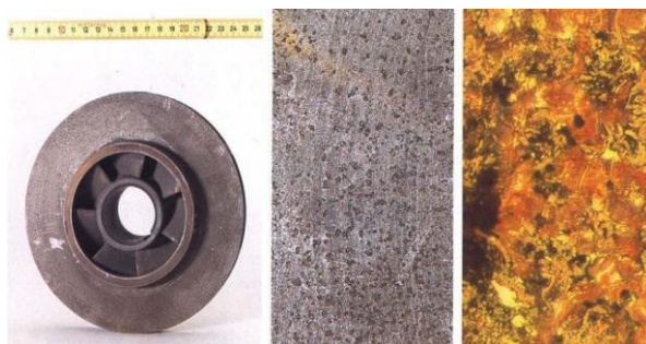
Slika 4. Grafitizacija sivog lijeva [6]
