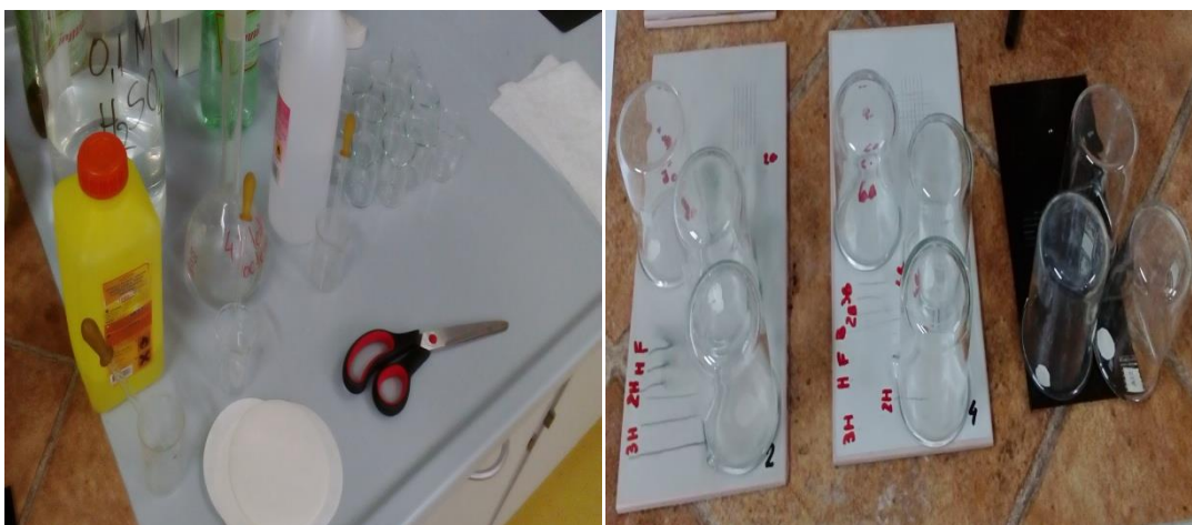
Slika 29. Ispitivanje otpornosti premaza prema agresivnim otopinama [14]
