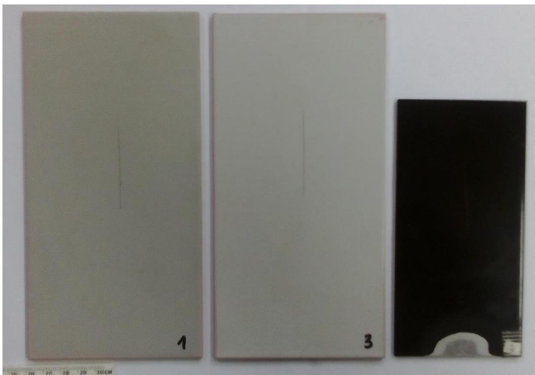
Slika 18. Ispitni uzorci prije stavljanja u slanu komoru [14]
