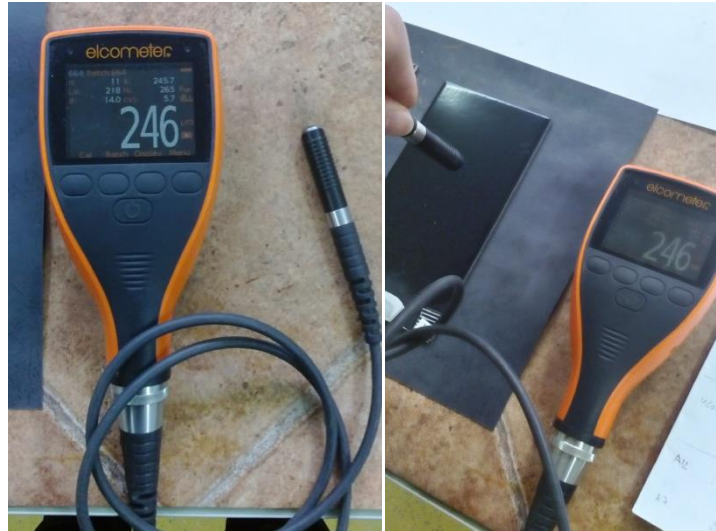
Slika 14. Uređaj za mjerenje debljine suhog sloja premaza [14]
