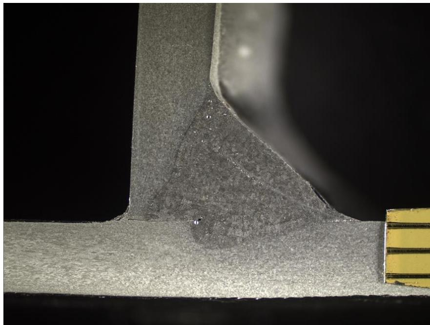
Slika 13. Primjer poroznosti i nedovoljnog protaljivanja zavara aluminijске legure [11]
