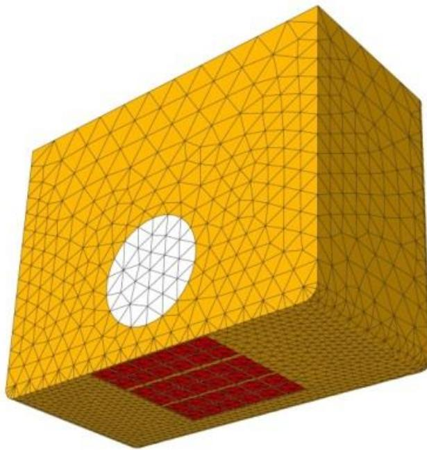
Slika 1. Izgled modela nastalog metodom konačnih elemenata [1]
