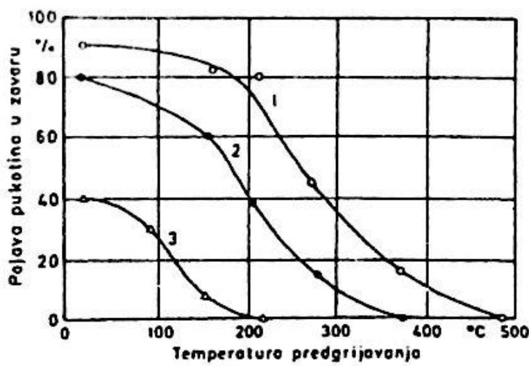
Slika 15. Utjecaj na pojavu toplih pukotina u ovisnosti o temperaturi predgrijavanja i dodatnom materijalu za leguru AlMg 2,5 (1 – dodatni materijal AlMgMn, 2 – dodatni materijal AlMg 2,5, 3 – dodatni materijal AlMg 3,5) [8]
