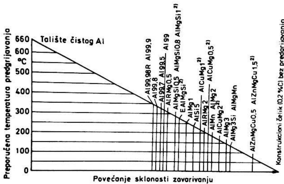
Slika 7. Temperature predgrijavanja za aluminijске legure dobivene formulom (1) [6]
