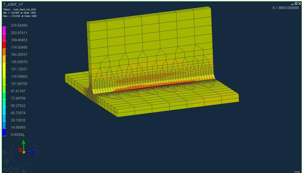
Slika 40. Prva iteracija (predgrijavanje radnog komada na  $50^\circ\text{C}$ ; vrijednosti su u  $\text{N/mm}^2$ )
