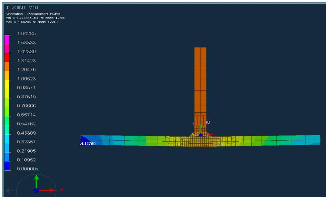
Slika 38. Deformacije kod paralelnog (istovremenog) zavarivanja (XY ravnina)
