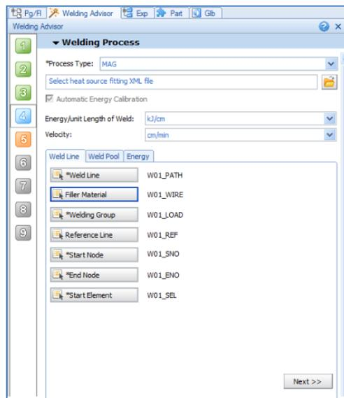
Slika 23. Odabir prvog kutnog zvara (Weld Line – W01\_PATH)
