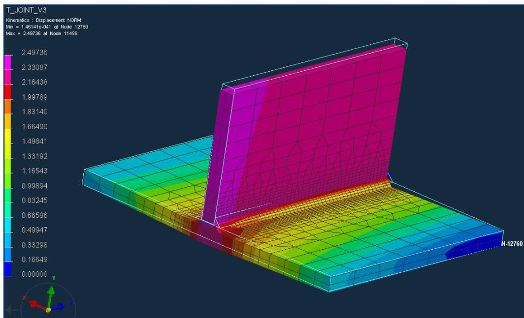
Slika 29. Deformacije kod unosa topline 8 kJ/cm
