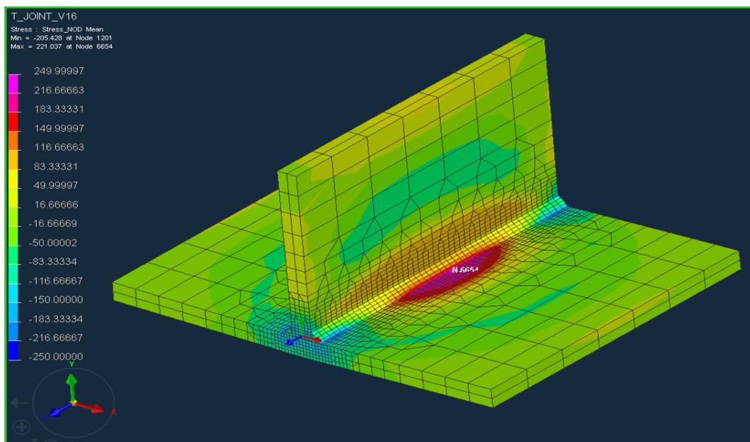
Slika 40. Zaostala naprezanja kod paralelnog (istovremenog) zavarivanja (srednja naprezanja)
