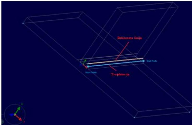
Slika 17. Gotova trajektorija i referentna linija jednog kutnog zavara
