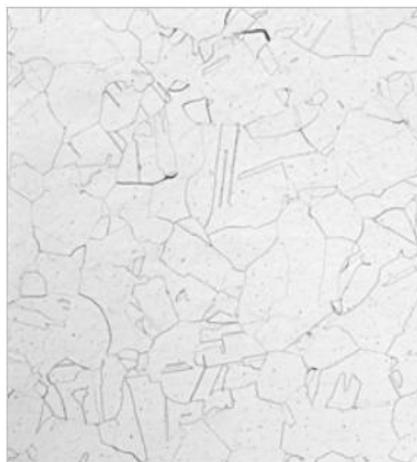
Slika 3. Mikrostruktura austenitnog nehrđajućeg čelika [8]
