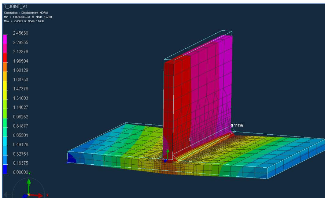
Slika 33. Deformacije kod unosa topline 6,4 kJ/cm
