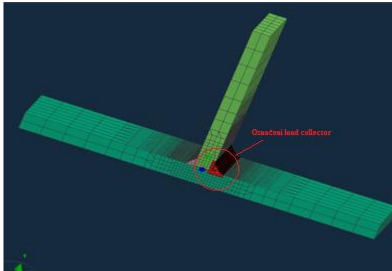
Slika 12. Označavanje kod izrade kolektora za izvor topline
