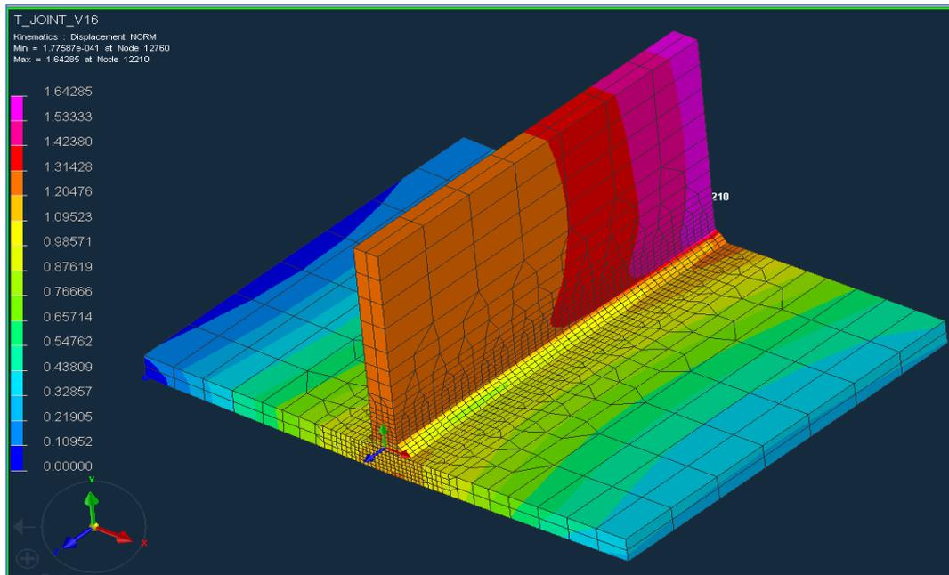
Slika 37. Deformacije kod paralelnog (istovremenog) zavarivanja
