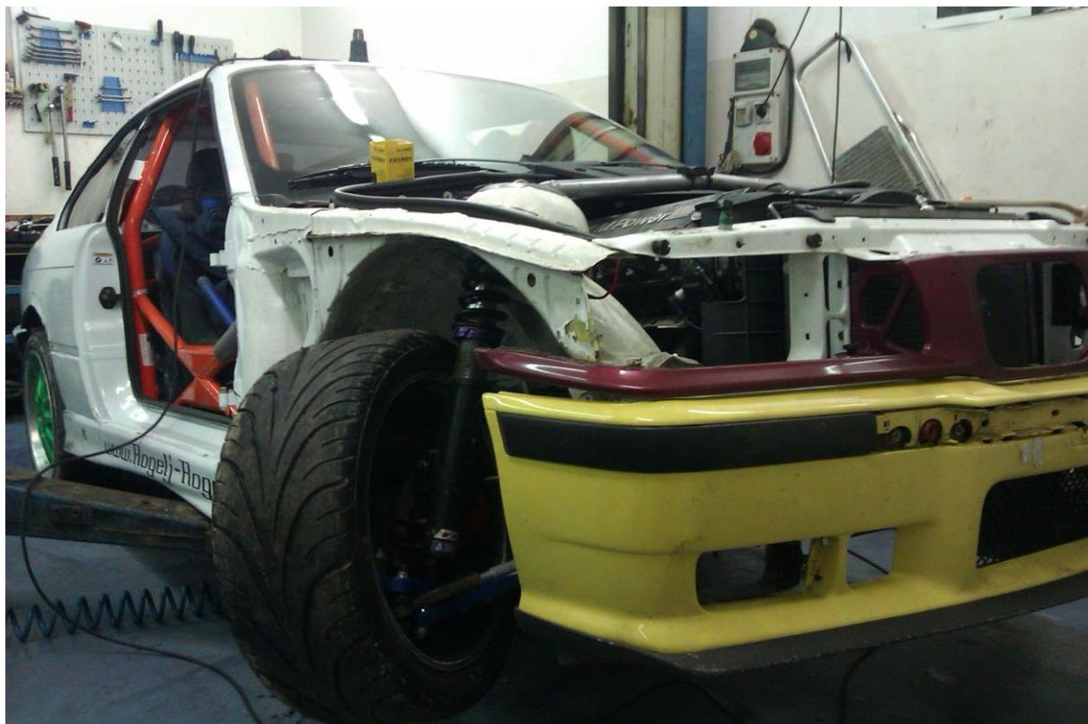
**Slika 95** Kut od 60 stupnjeva zakreta prednjih kotača
