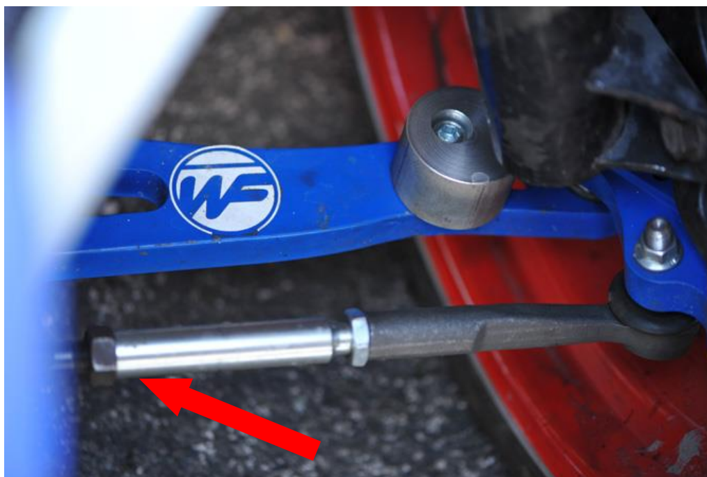
Slika 89 Podešavanje usmjerenosti kotača
