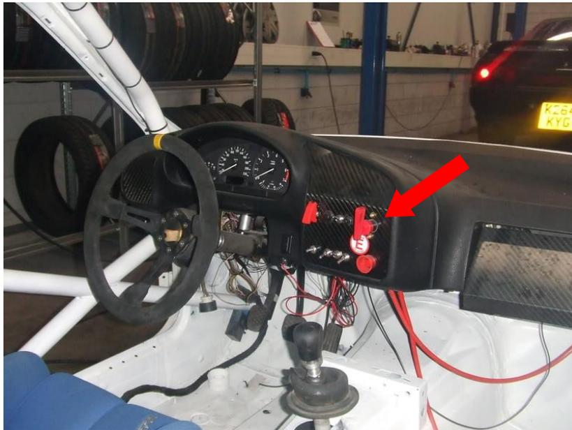
Slika 37 Unutrašnjost automobila sa prekidačem za isključivanje struje
