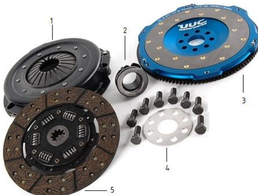
**Slika 47 Jednomaseni zamašnjak i dijelovi spojke**
