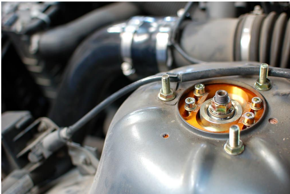
Slika 87 Podešavanje bočnog kuta
