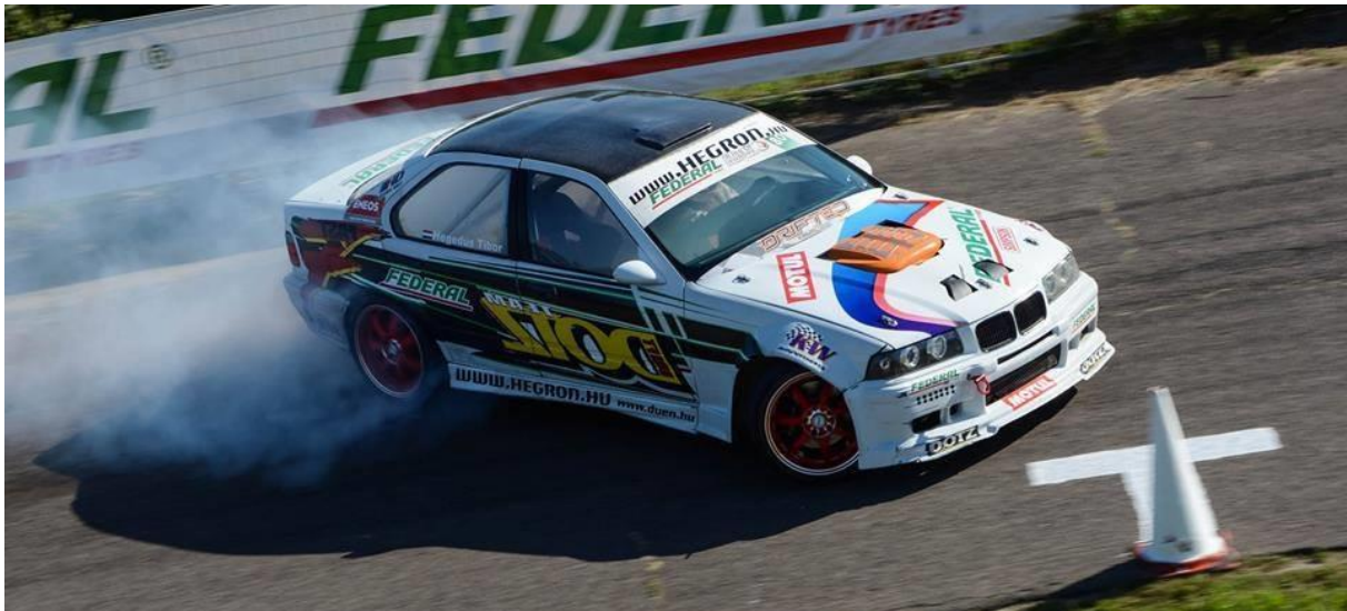
Slika 25 Kotači usmjereni u smjeru zanošenja
