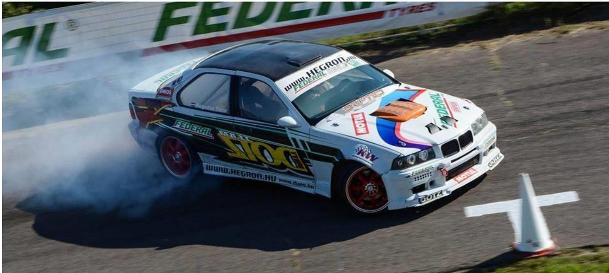
Slika 25 Kotači usmjereni u smjeru zanošenja
