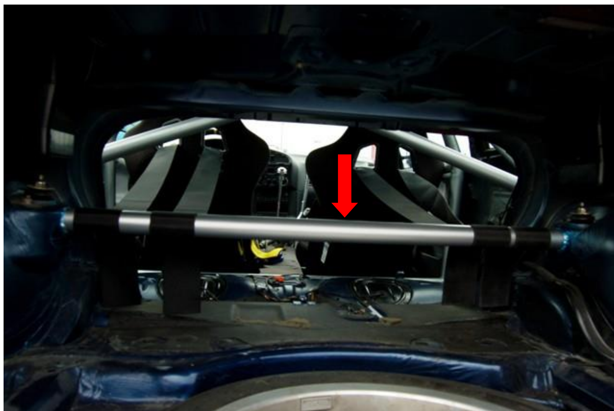
Slika 74 Ugrađen stražnji povezičać unutrašnjih blatobrana
