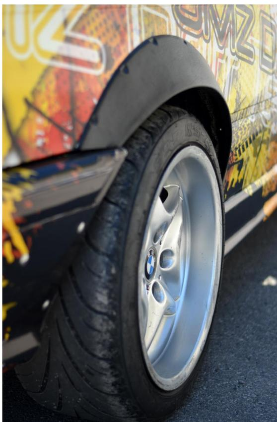
**Slika 58** Stražnji pneumatici u dimenziji 245/40 ZR17
