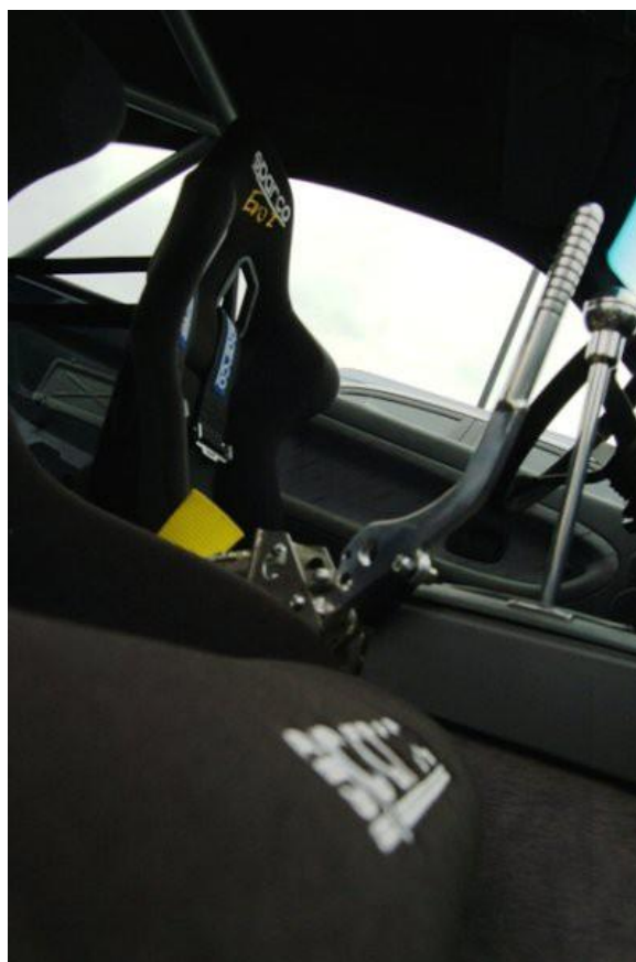
Slika 57 Ugrađena ručna kočnica
