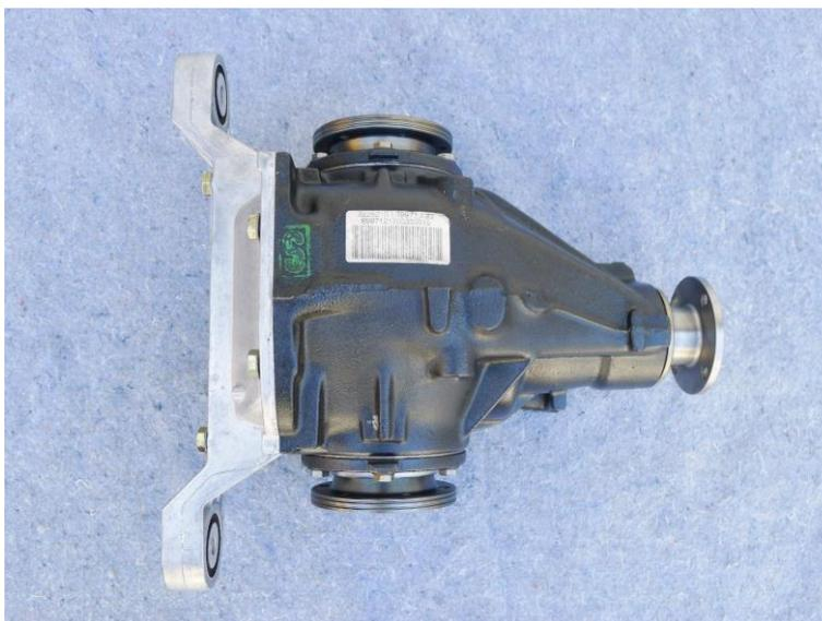
Slika 54 Samoblokirajući diferencijal u kućištu 210
