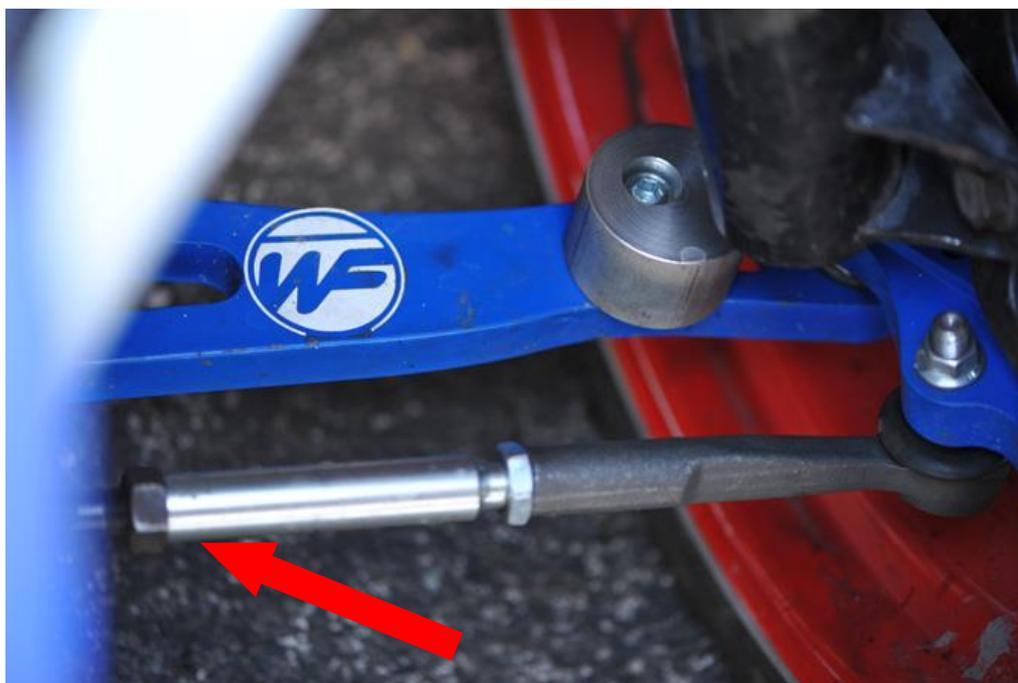
**Slika 89 Podešavanje usmjerenosti kotača**
