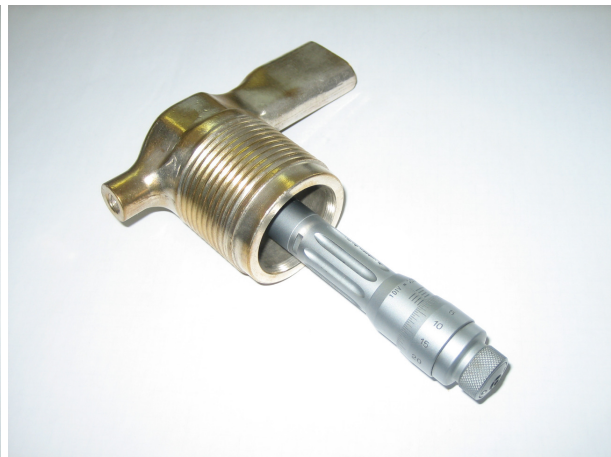
Slika 16. Primjer dimenzionalnog ispitivanja slijepe rupe
