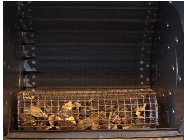
Slika 32. Priključnice u bubnju sačmarilice
