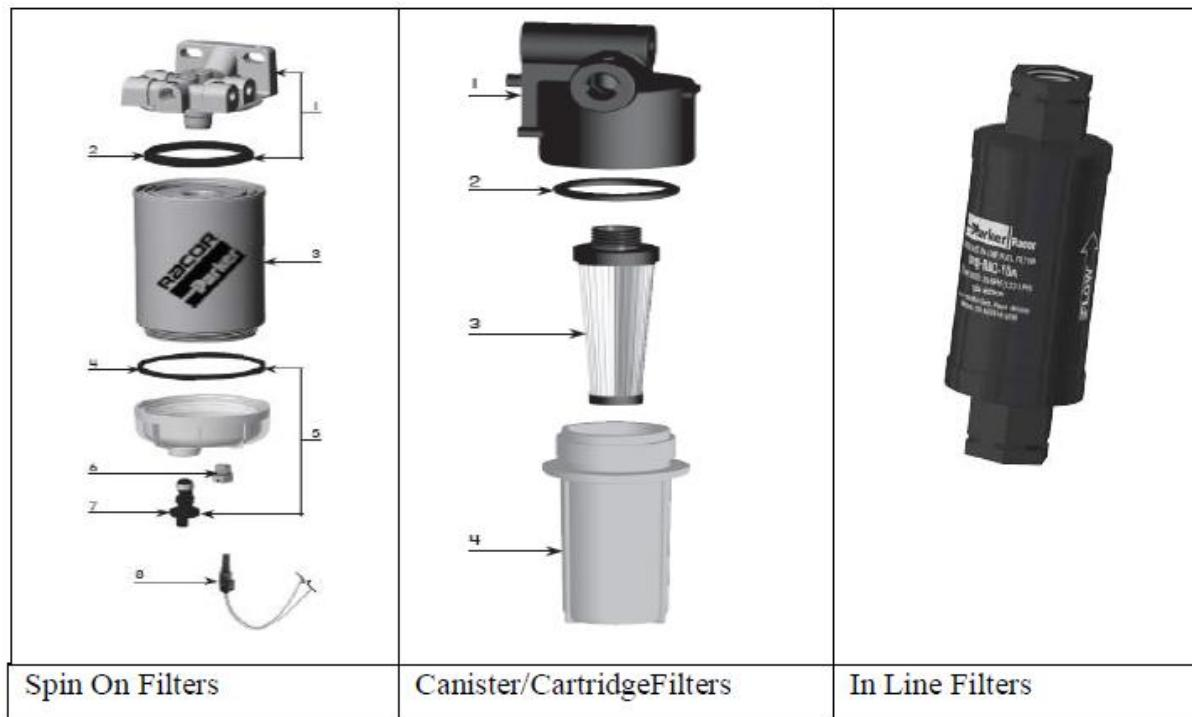
Slika 18. Usporedba filtera prema strukturi
