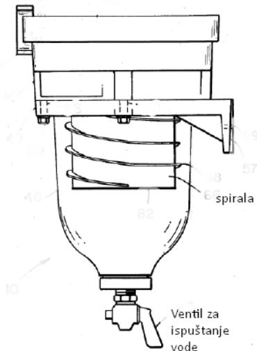
**Slika 21. Centrifugalni separator**
