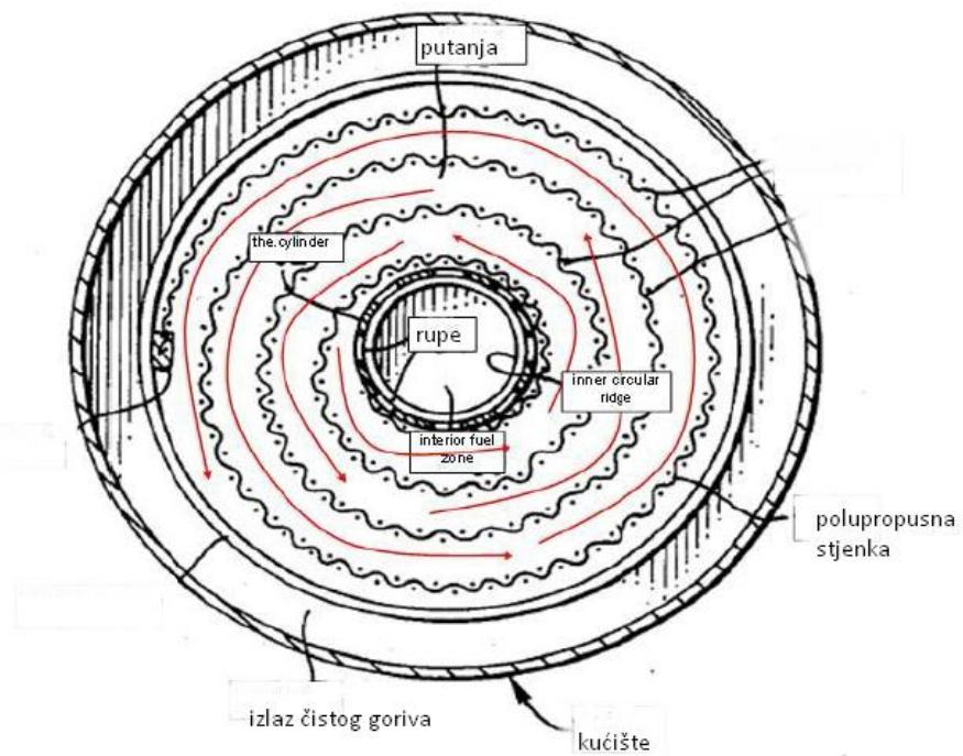
**Slika 22. Polupropusni separator vode**
