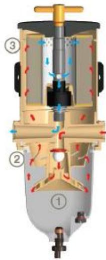
**Slika 23. Turbinski filter i separator**
