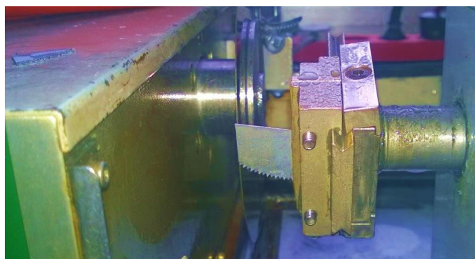
Slika 22: Prikaz postupka izrezivanja dijela uzorka pile.
