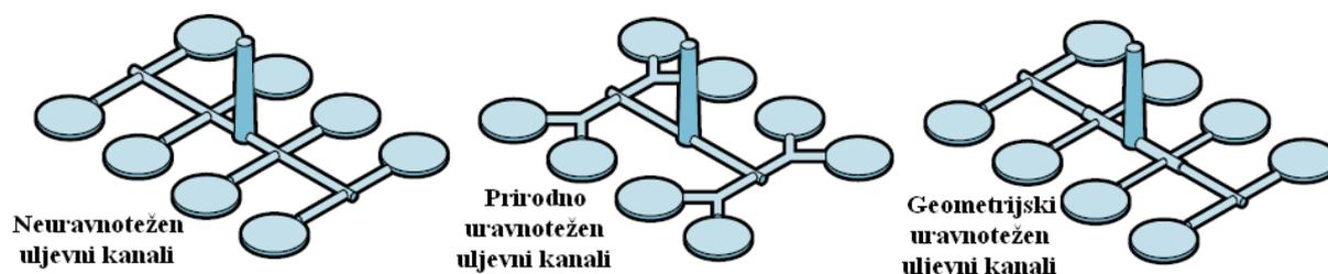
Slika 4.3 Uljevni kanali [8]
