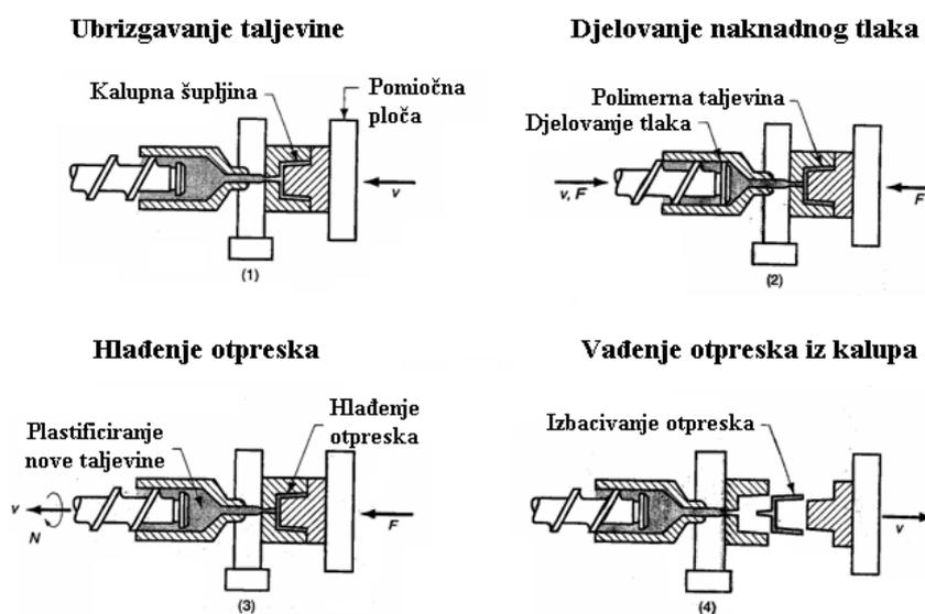
Slika 4.6 Ciklus injeksijskog prešanja plastomernog otpreska [5]
