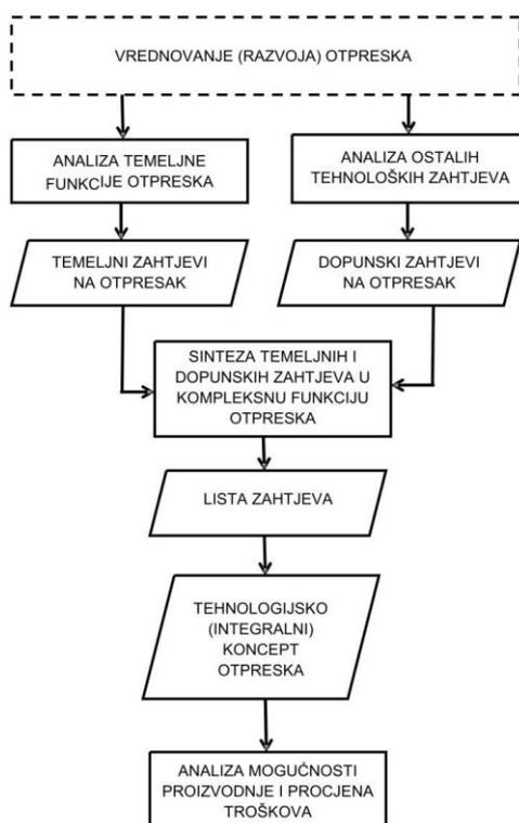
**Slika 3.1 Polazišni postupci tehnologijskog konstruiranja otpreska [1]**
