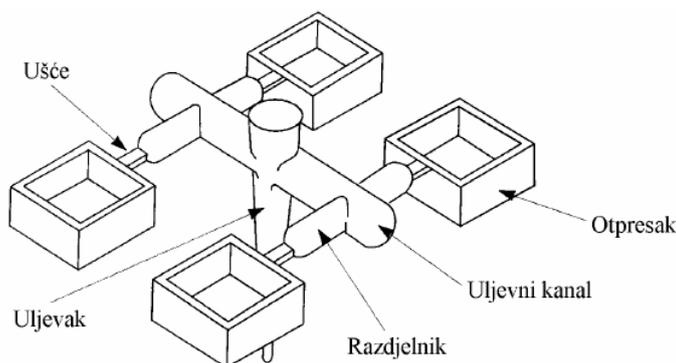
**Slika 4.4 Hladni uljevni sustav (grozd) [2]**
