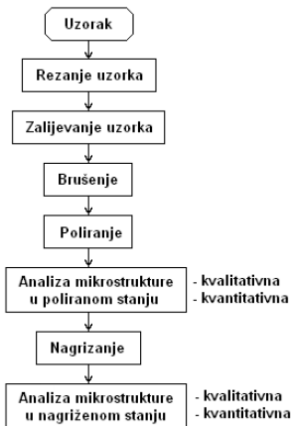
Slika 8. Shema pripreme i ispitivanja uzorka
