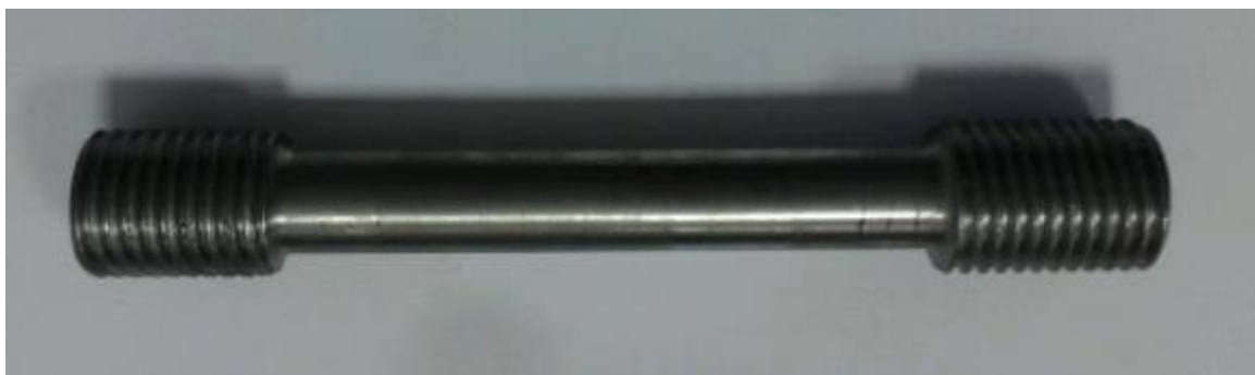
Slika 37. Epruveta za statičko vlačno ispitivanje
