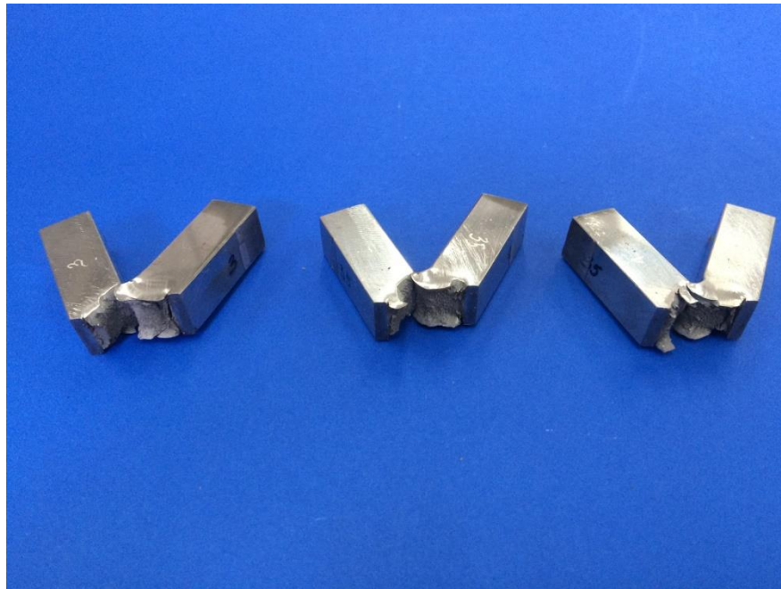
Slika 42. Epruvete nakon provedenog ispitivanja
