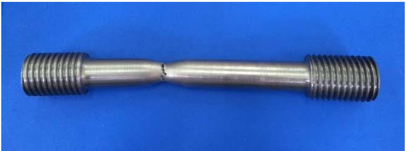
Slika 39. Epruveta nakon statičkog vlačnog ispitivanja
