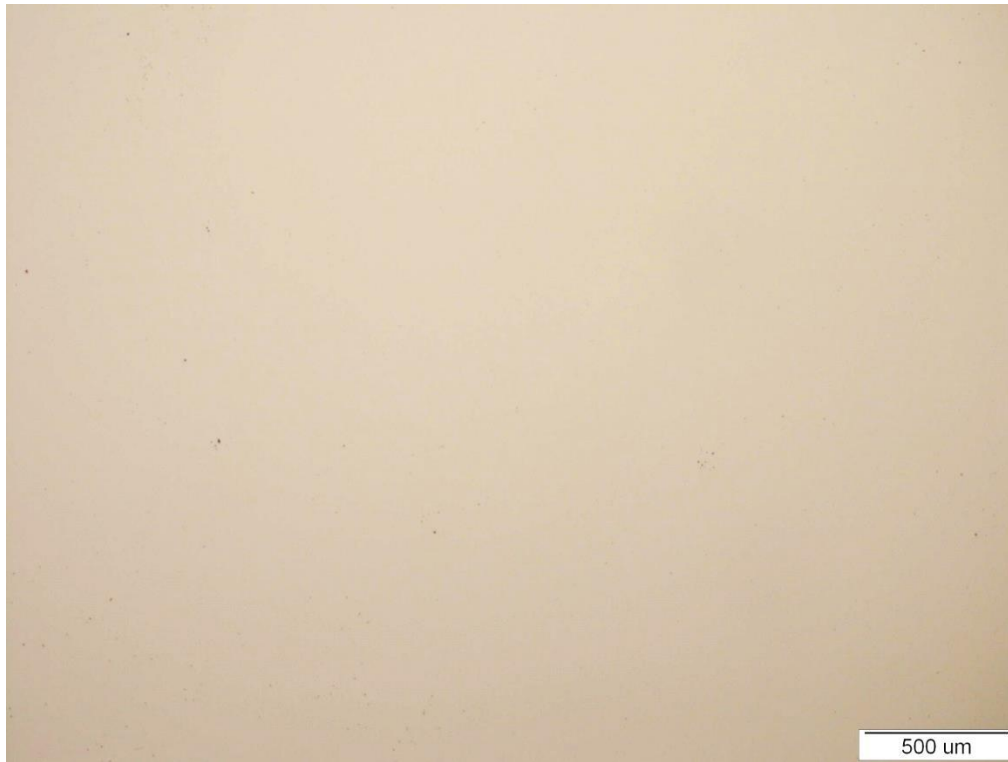
Slika 25. Površina uzorka u poliranom stanju
