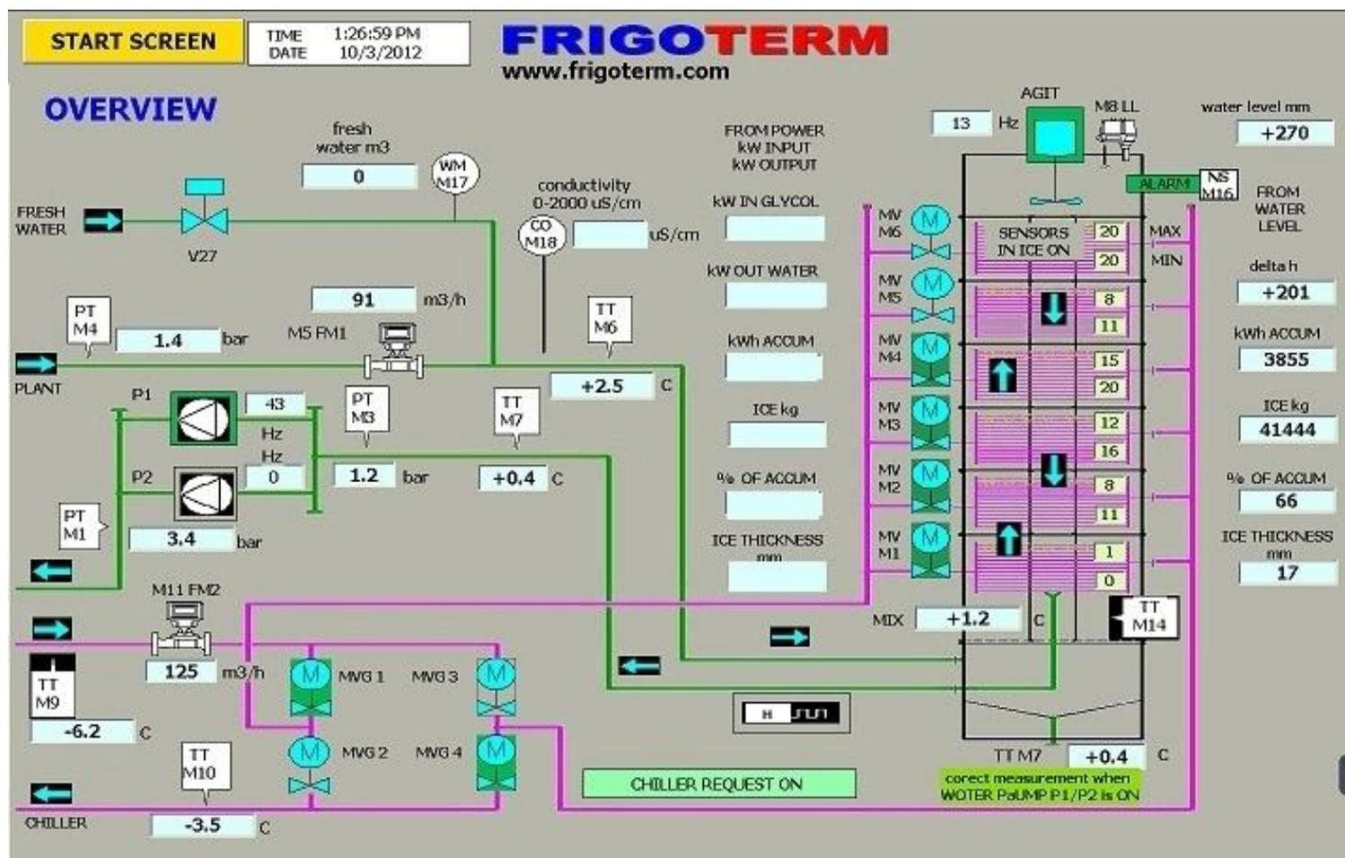
Slika 4. Shema silosa leda i instalacije (Frigoterm d.o.o)
