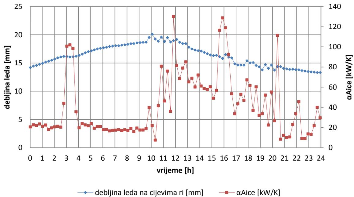
Slika 26.  $\alpha A$  produkt u ovisnosti o topljenju leda u vremenu
