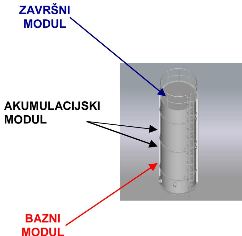
Slika 2. Prikaz modularne konstrukcije silosa (Frigoterm d.o.o)
