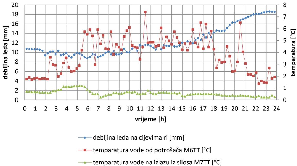
Slika 8. Akumulirani led u ovisnosti o temperaturi vode na ulazu u silos
