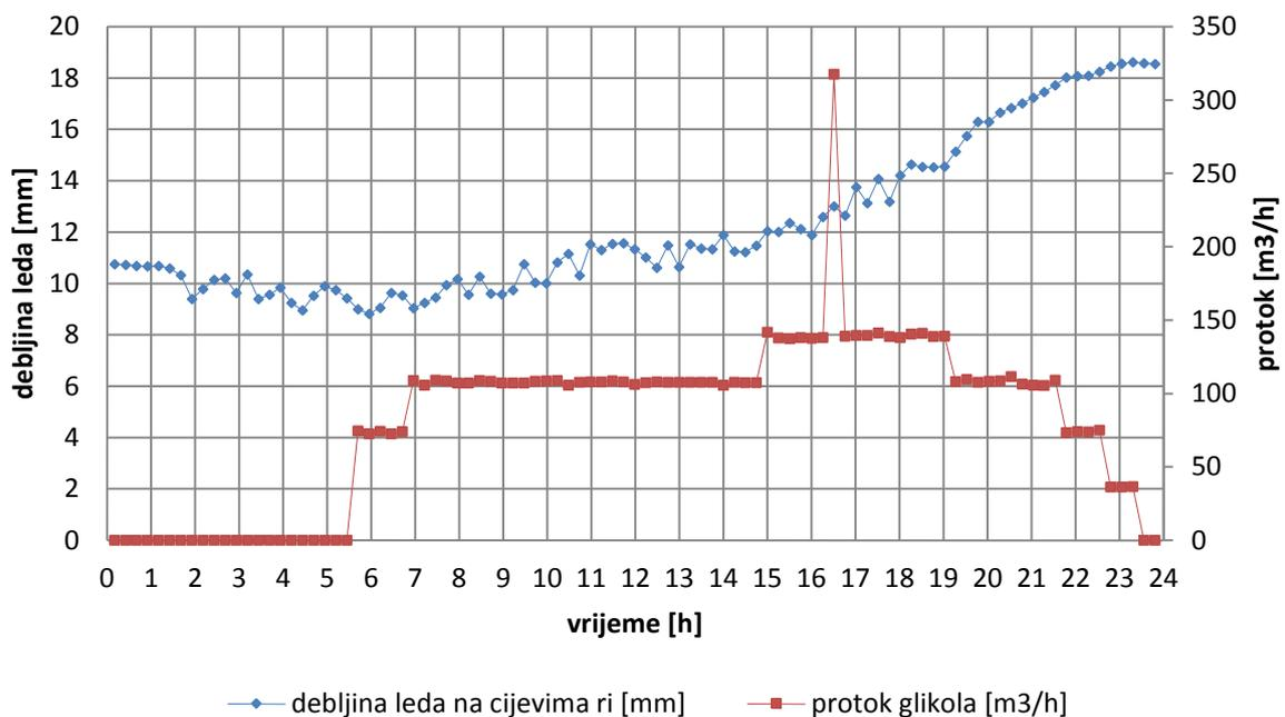
Slika 5. Akumulirani led na cijevima u ovisnosti o protoku propilen glikola kroz cijevi
