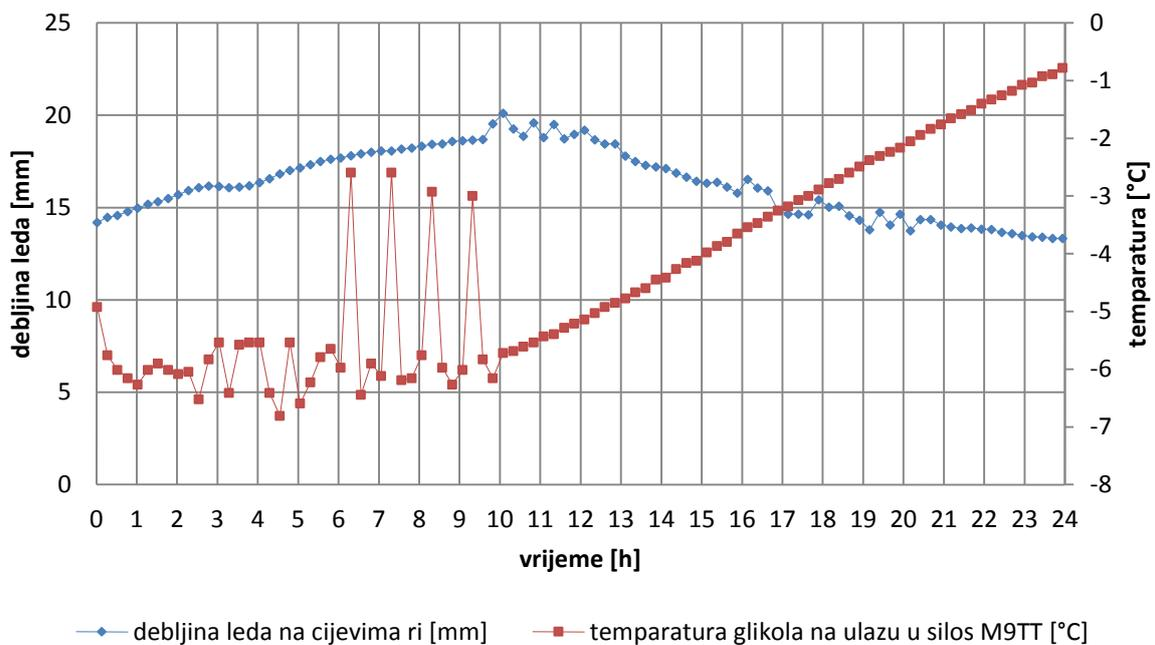
Slika 20. Ovisnost akumulacije leda o ulaznoj temperaturi propilen glikola u silos
