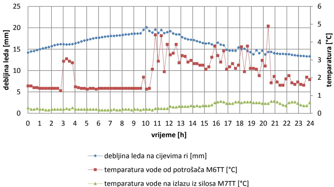
Slika 22. Ovisnost akumulacije leda o ulaznoj i izlaznoj temperaturi vode u silosu
