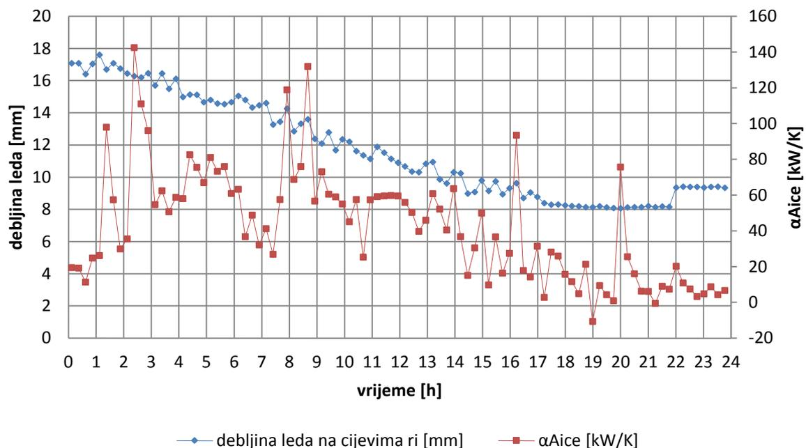
Slika 18.  $\alpha A$  produkt u ovisnosti o topljenju leda u vremenu
