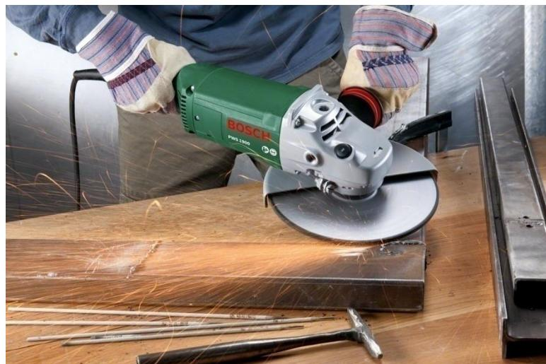
Slika 7. Brušenje zavarenog spoja [10]
