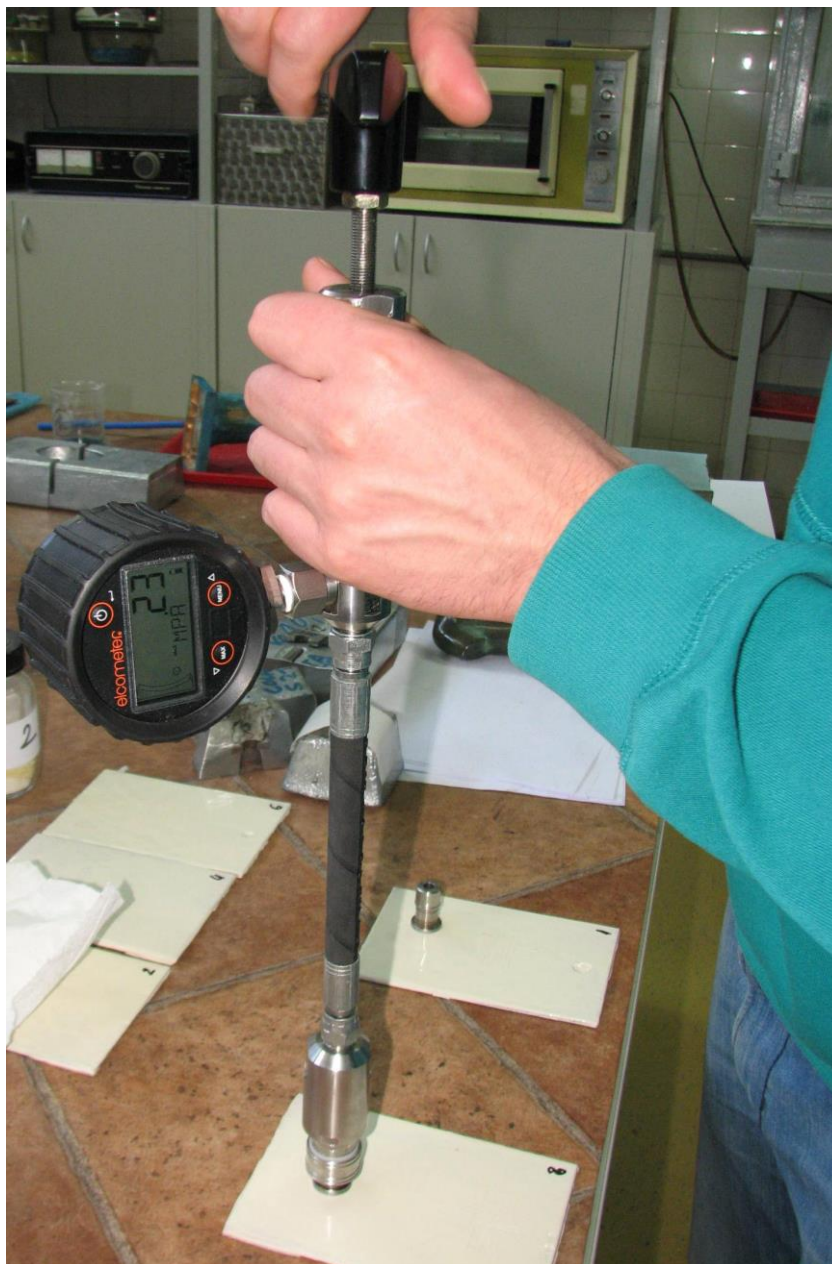
Slika 19. Ispitivanje prionjivosti metodom povlačenja
