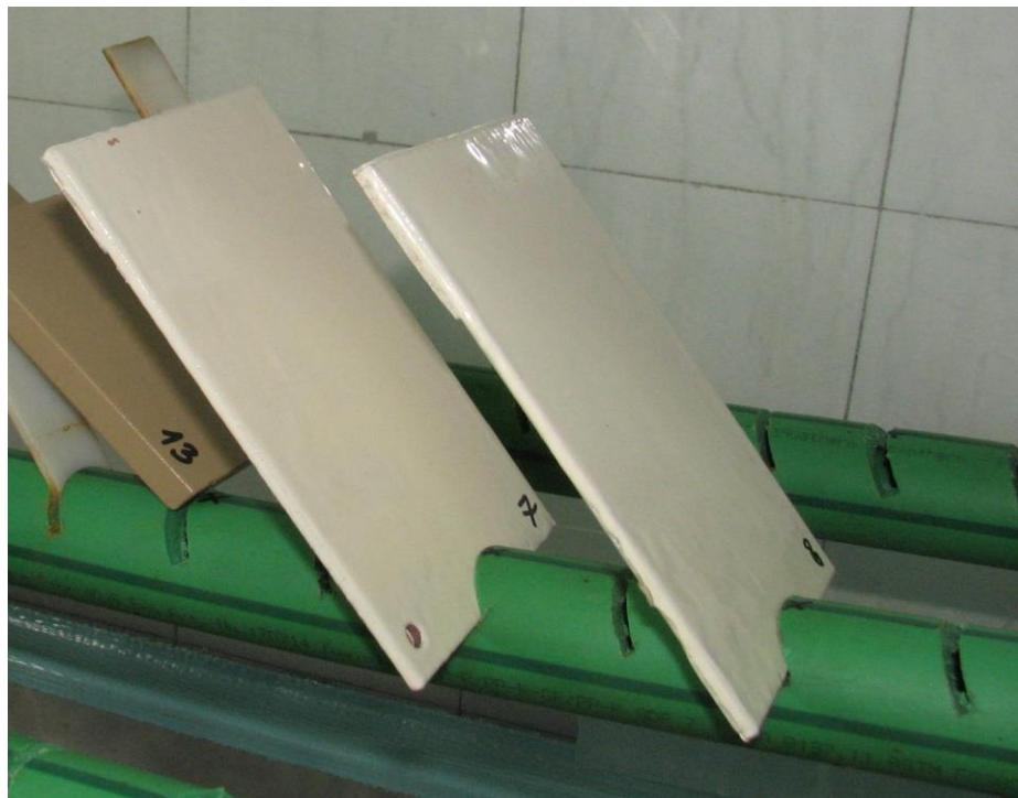
**Slika 16. Uzorci 7 i 8 u vlažnoj komori**
