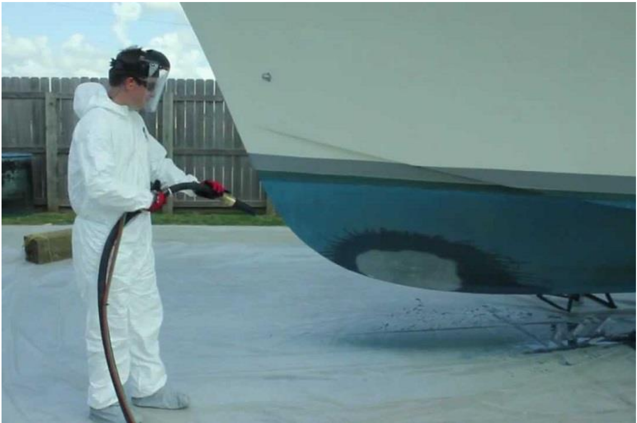
Slika 9. Čišćenje oplata broda mlazom abraziva [12]
