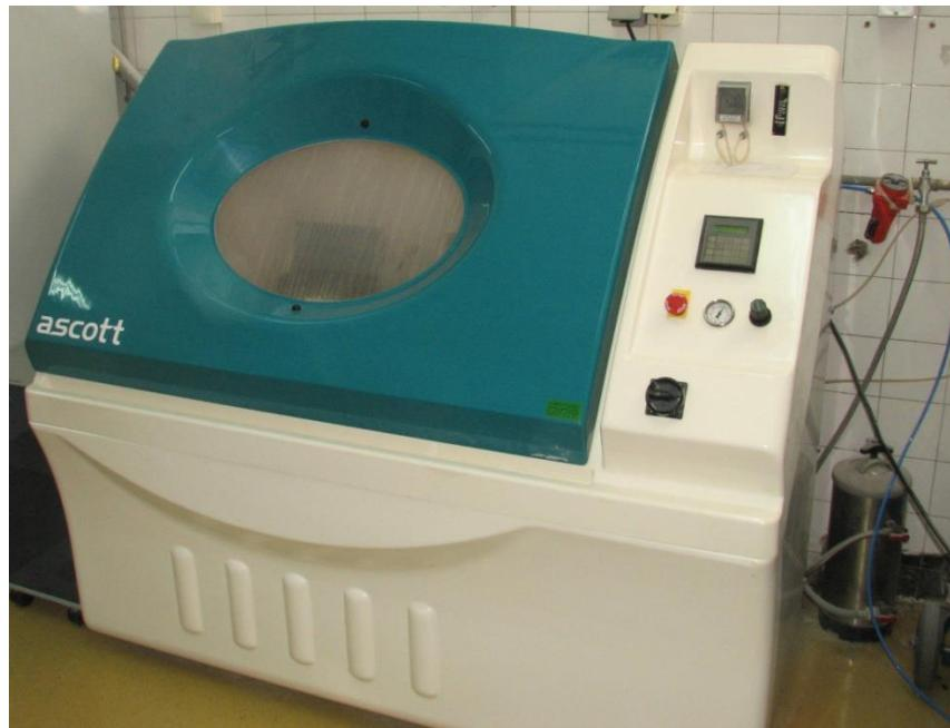
Slika 17. Slana komora Ascott, Laboratorij za zaštitu materijala
