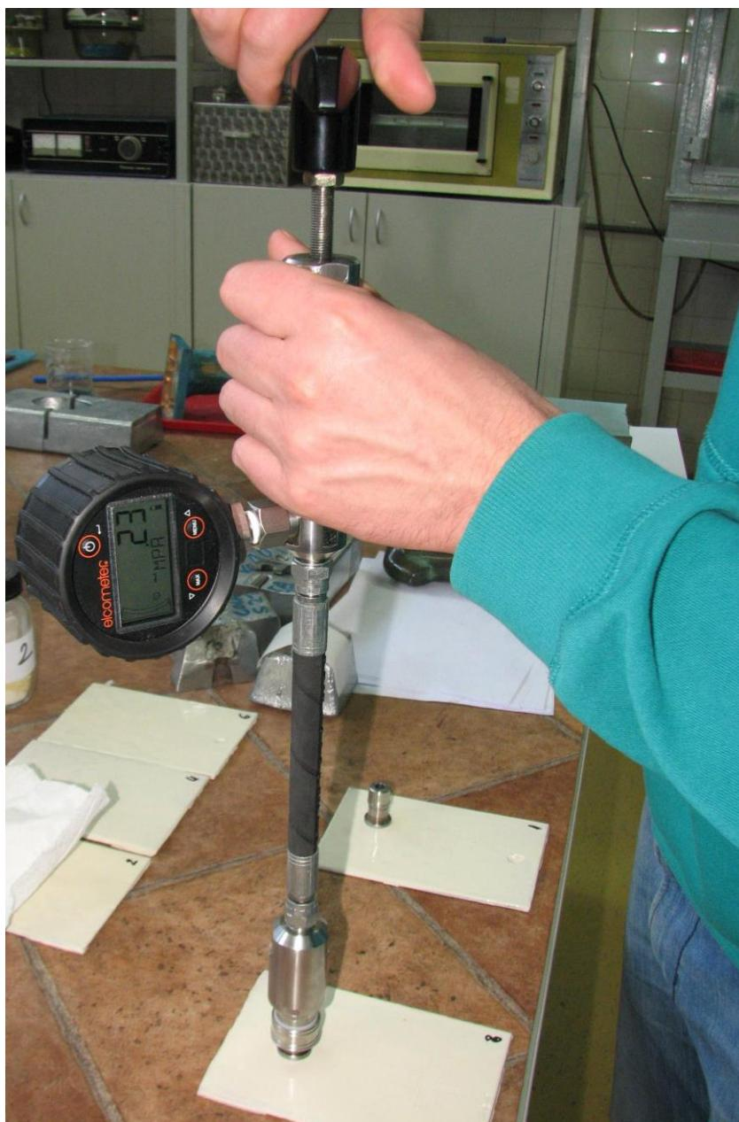
Slika 19. Ispitivanje prionjivosti metodom povlačenja
