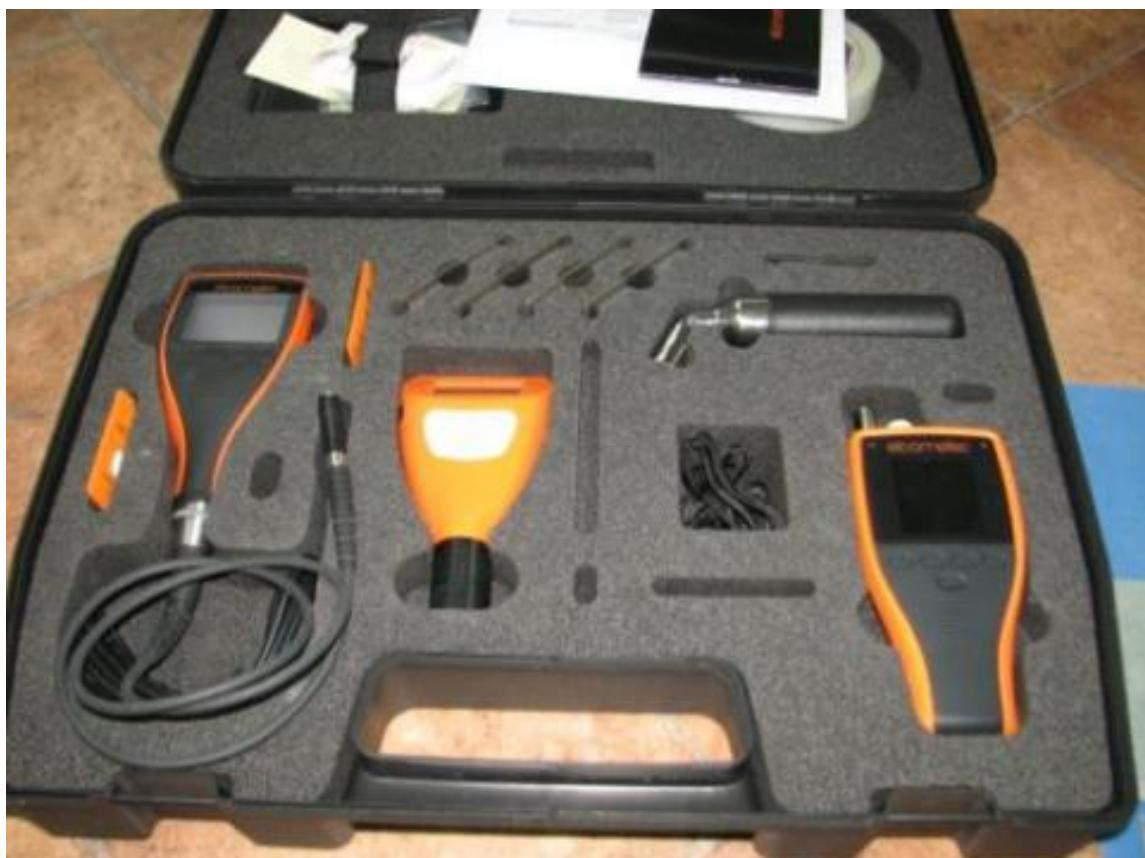
**Slika 14. Uređaj „Elcometer 456“ za mjerjenje debljine prevlake**
