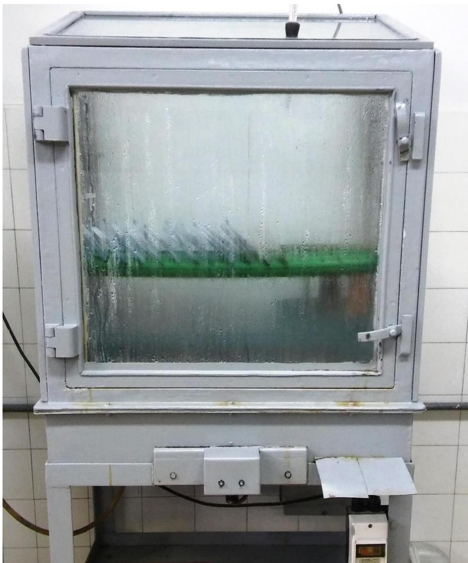
**Slika 15. Vlažna komora, Laboratorij za zaštitu materijala**
