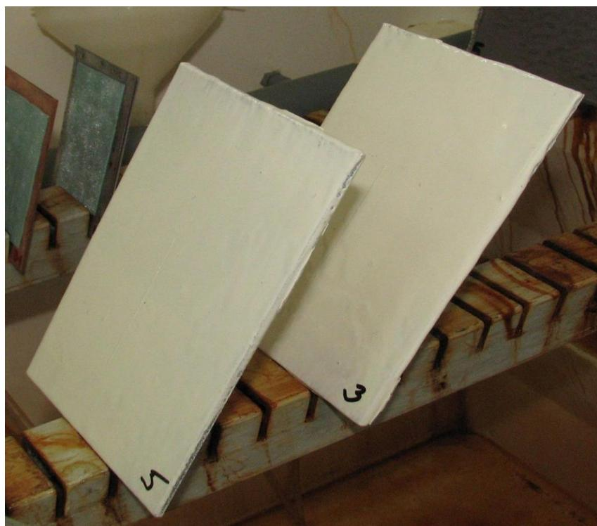
Slika 18. Uzorci 3 i 5 u slanoj komori
