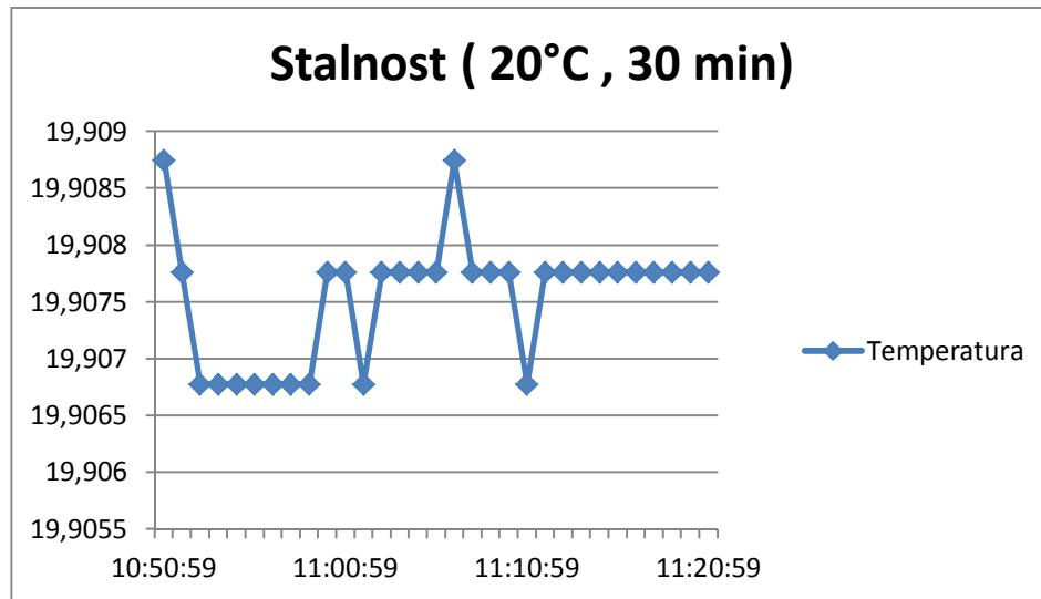
Slika 17: Stalnost temperature za 20°C – kupka Kambič/voda
