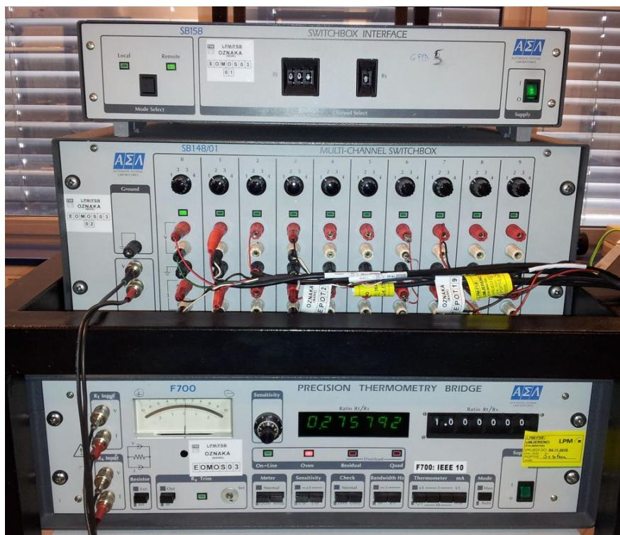
Slika 10: Otpornički most sa spojenim svim navedenim komponentama
