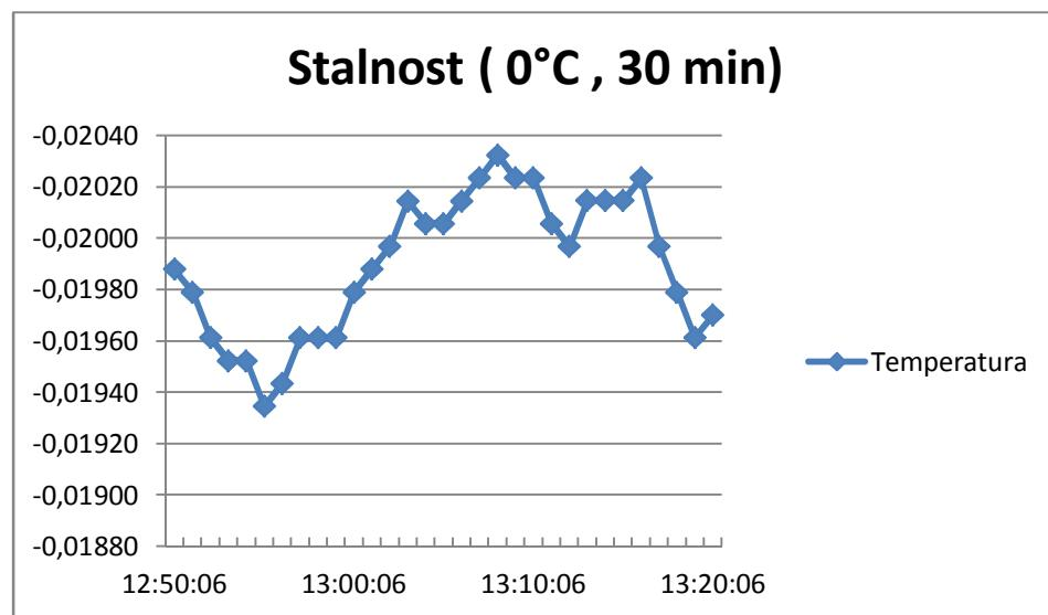
Slika 15: Stalnost temperature za  $0^{\circ}\text{C}$  - kupka Kambič/etanol
