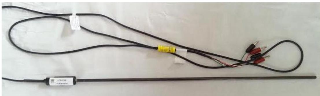
Slika 9: Termometar korišten za umjeravanje
