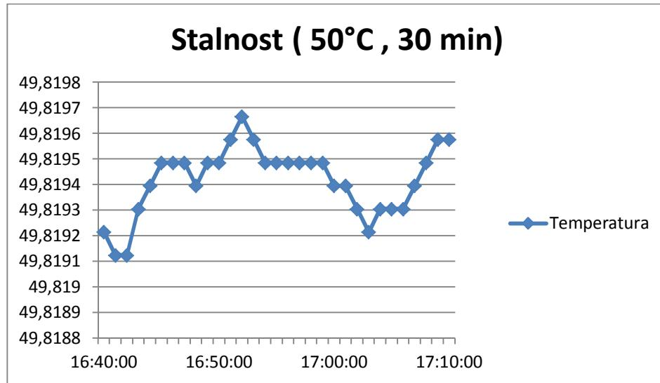
Slika 18: Stalnost temperature za 50°C - kupka Kambič/voda
