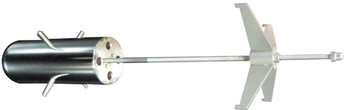
Slika 2: Izotermalni blok za termostatirane kupke
