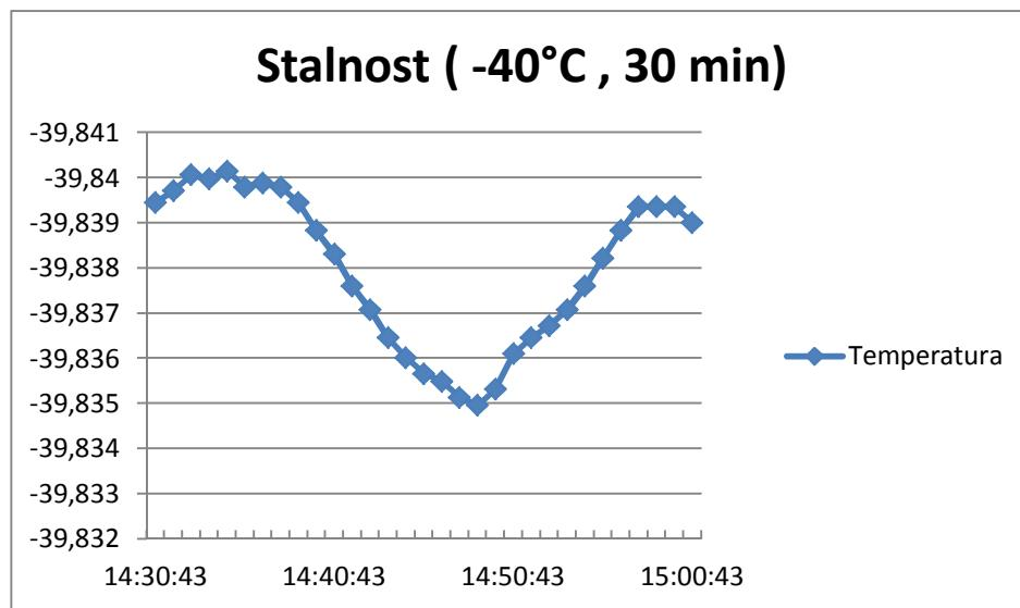
Slika 21: Stalnost temperature za  $-40^{\circ}\text{C}$  - kupka Isotech
