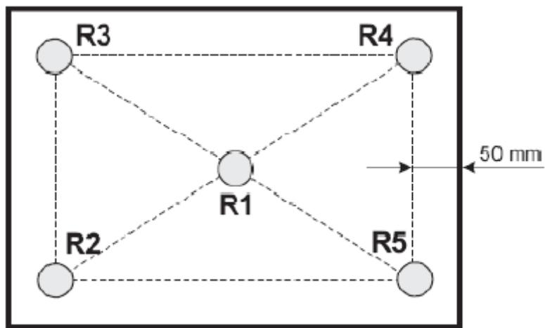
Slika 4: Primjer specifikacije mjernih mesta
