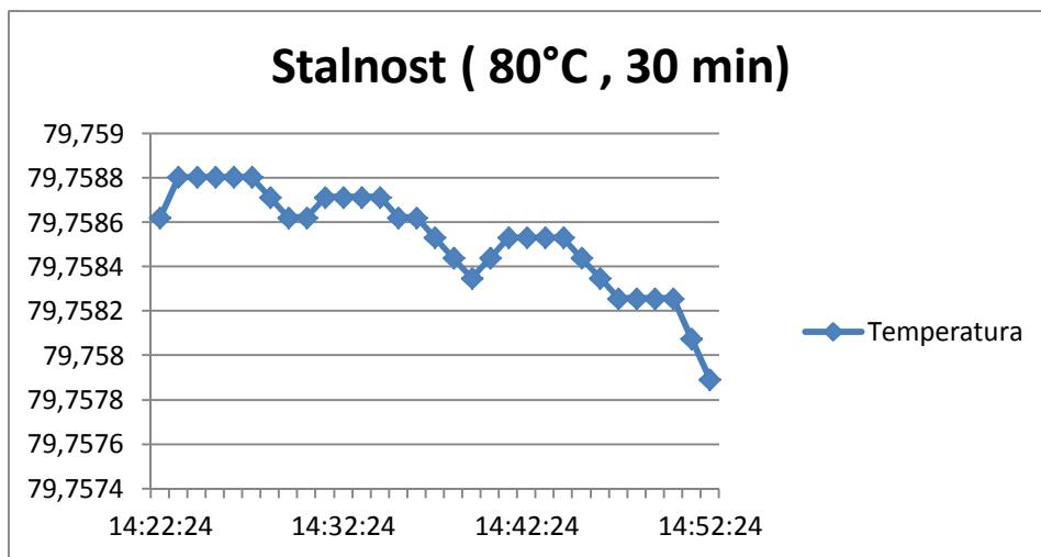
Slika 19: Stalnost temperature za 80°C - kupka Kambič/voda
