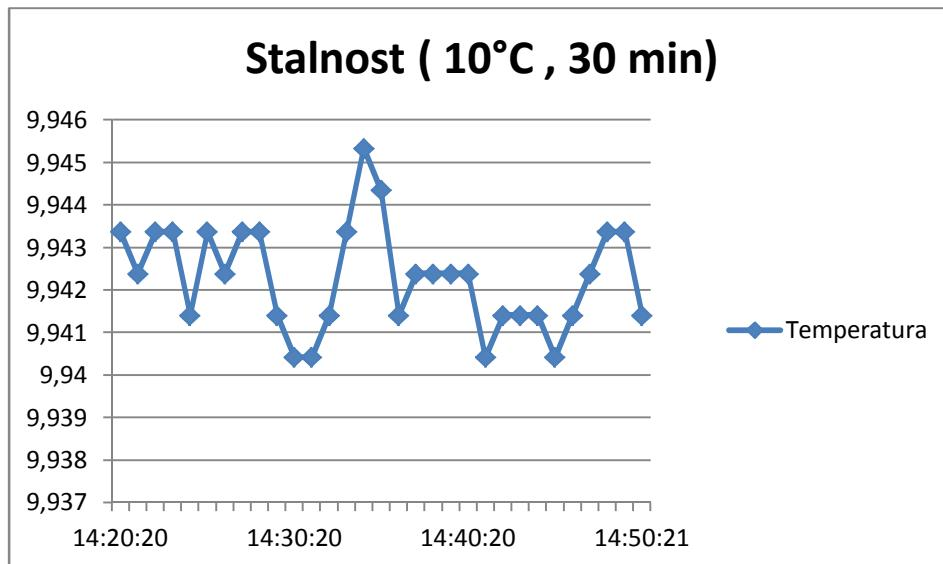
Slika 16: Stalnost temperature za 10°C - kupka Kambič/etanol
