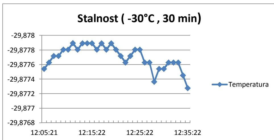
Slika 13: Stalnost temperature za -30°C – kupka Kambič/etanol
