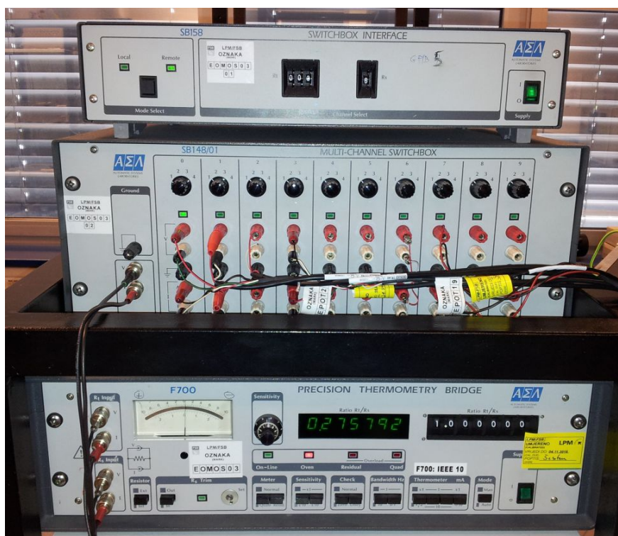
Slika 10: Otpornički most sa spojenim svim navedenim komponentama
