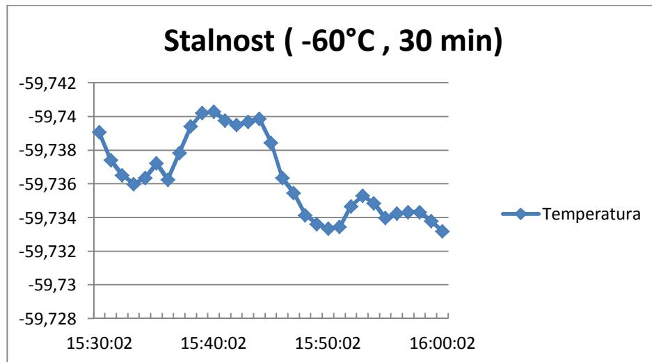
Slika 20: Stalnost temperature za  $-60^{\circ}\text{C}$  - kupka Isotech
