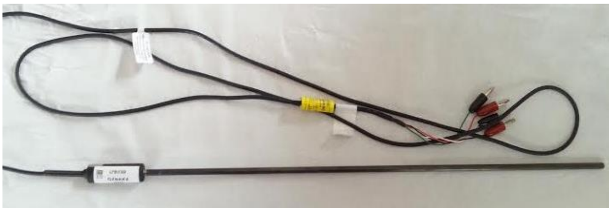
Slika 9. Termometar korišten za mjerenje temperature peći
