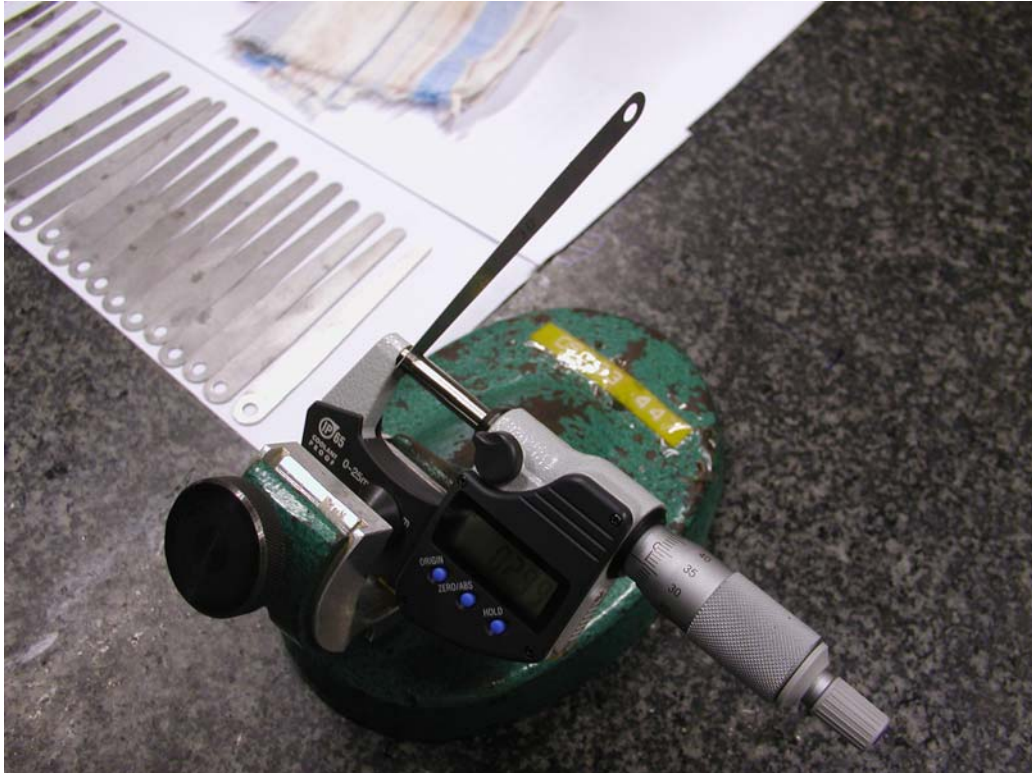
Slika 11. Mjerenje pomoću digitalnog mikrometra
