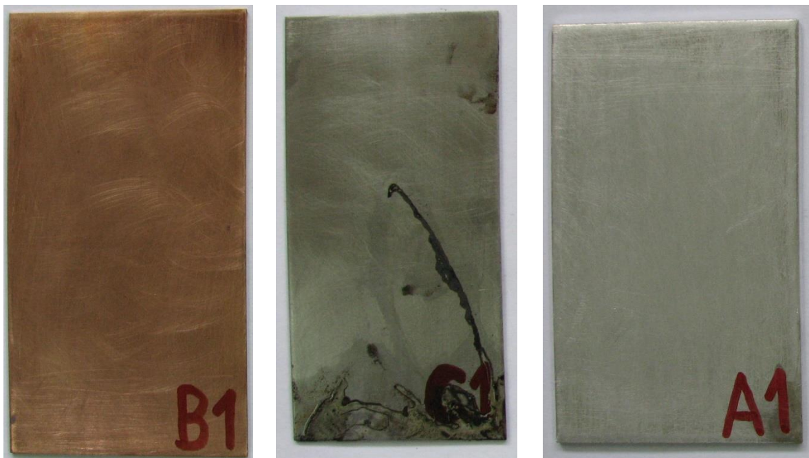
Slika 29. Nulte probe uzoraka aluminija (A1), čelika (C1) i bakra (B1) u vlažnoj komori nakon 10 dana
