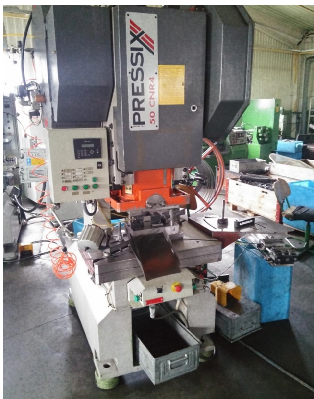
Slika 8. Slika preše prilikom izmjene alata
