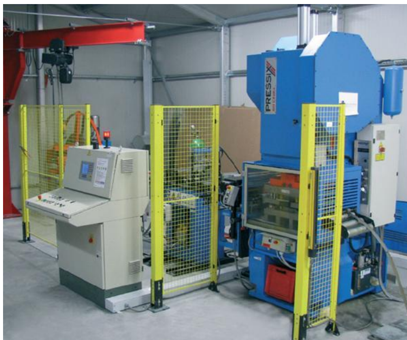
Slika 1. Mehanička preša na koju se najčešće postavlja slijedni alat
