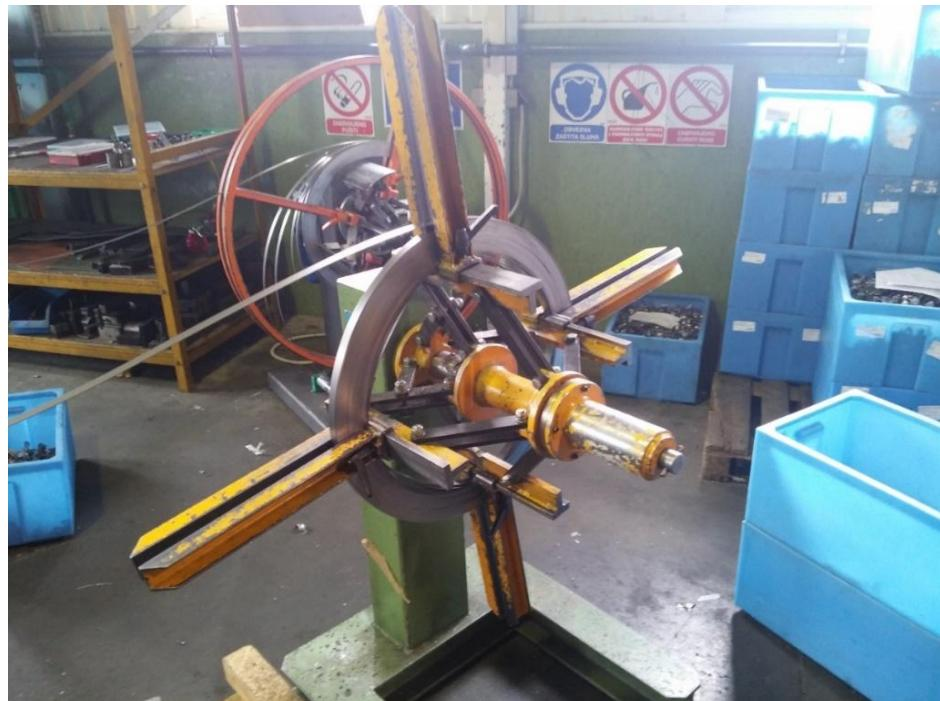
Slika 6. Kolut lima postavljen na odmotač s kojeg se lim pomoću dodavača transportira do štance (alata)
