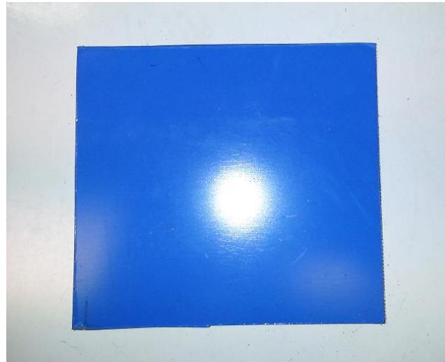
Slika 5.19: Izrezana tiskana pločica sa zaštitnom folijom
