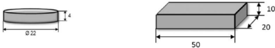
Slika 22. Oblik i dimenzije uzoraka za ispitivanje [16]
