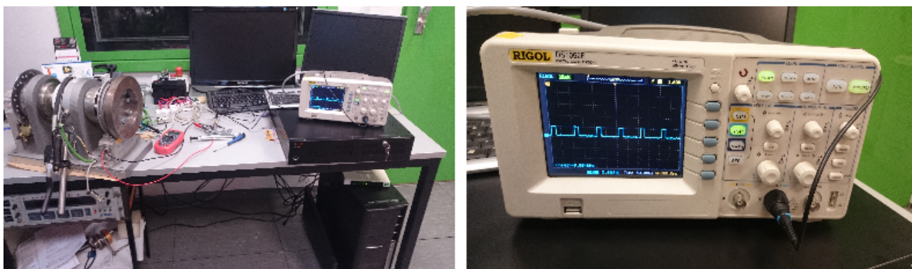
Slika 23. Spajanje prirubnice na osciloskop i izlazni signal
