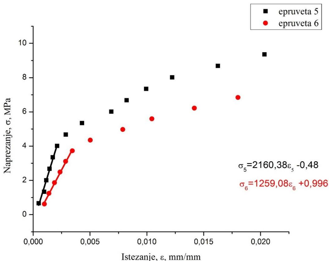
**Slika 31.** Dijagram naprezanje-istezanje Safix plus epruveta (5 i 6) slaganih u 15 slojeva
