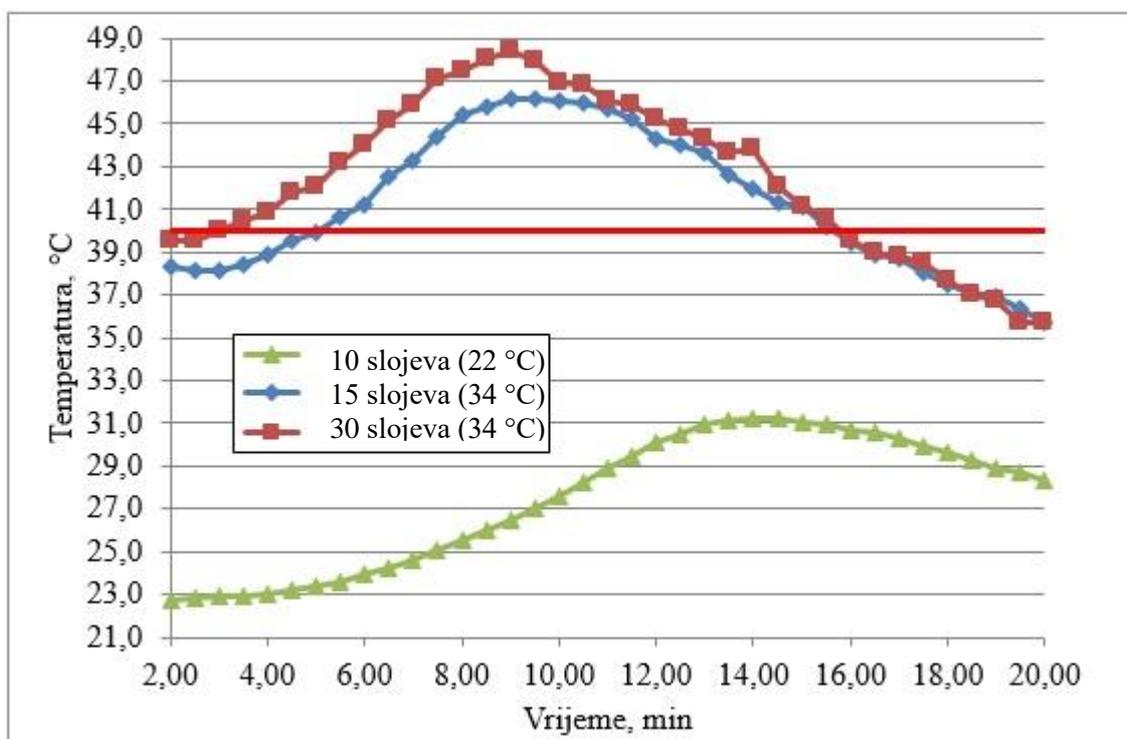
**Slika 17.** Vrijednosti srednjih temperatura sadrenih pločica Gipsan za 10, 15 i 30 slojeva [12]
