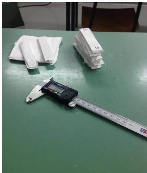
Slika 21. Mjerenje dimenzija ispitnih epruveta
