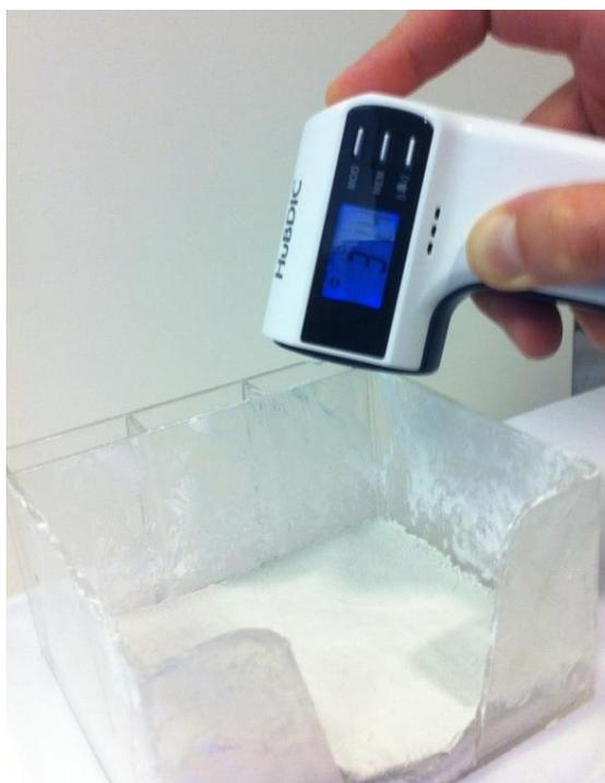
**Slika 14.** Mjerenje površinske temperature [12]
