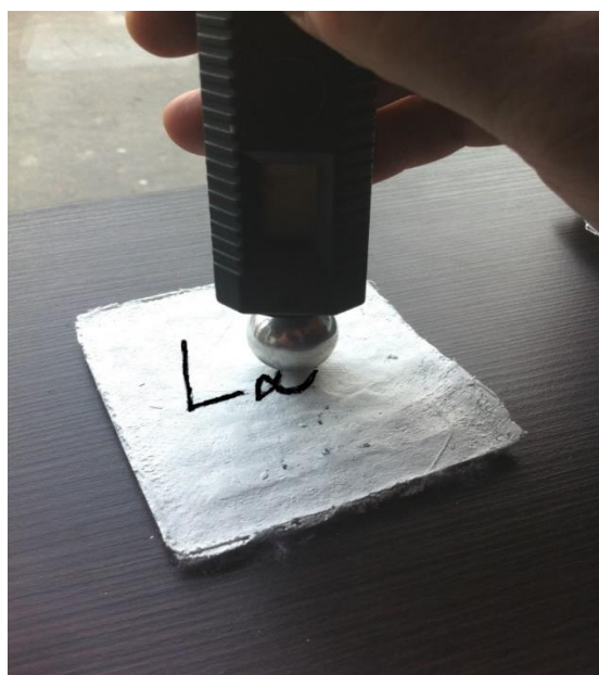
Slika 12. Mjerenje vlažnosti sadrene pločice [22]
