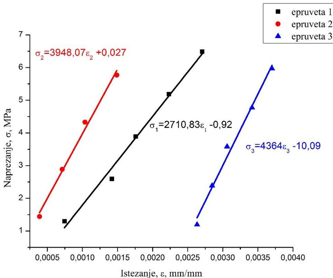
**Slika 26.** Dijagram naprežanje-istežanje Cellona epruveta (1, 2 i 3) slaganih u 10 slojeva
