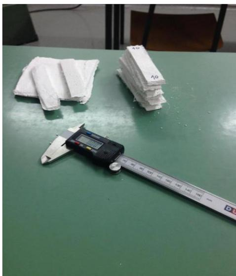
**Slika 21.** Mjerenje dimenzija ispitnih epruveta
