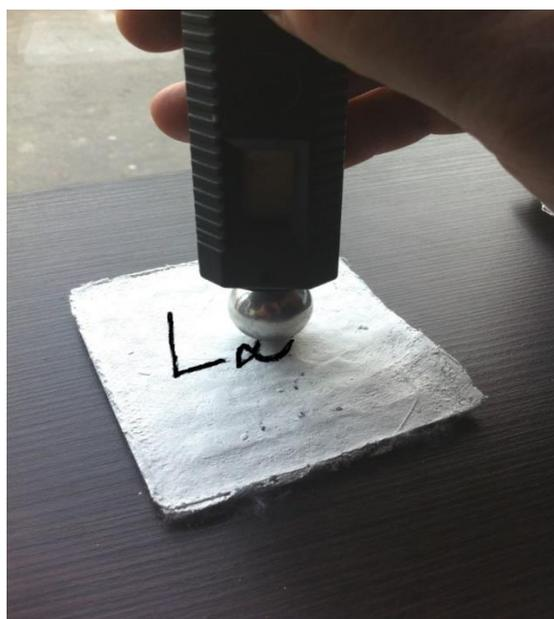
Slika 12. Mjerenje vlažnosti sadrene pločice [22]
