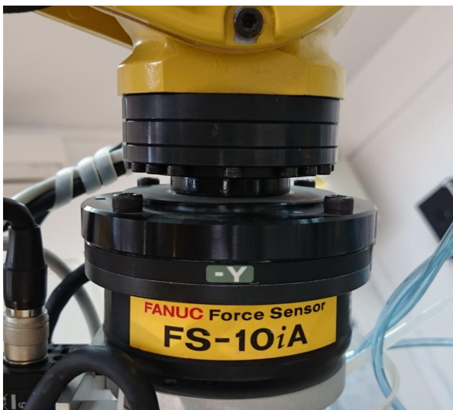
Slika 2. Senzor sile Fanuc FS-10iA
