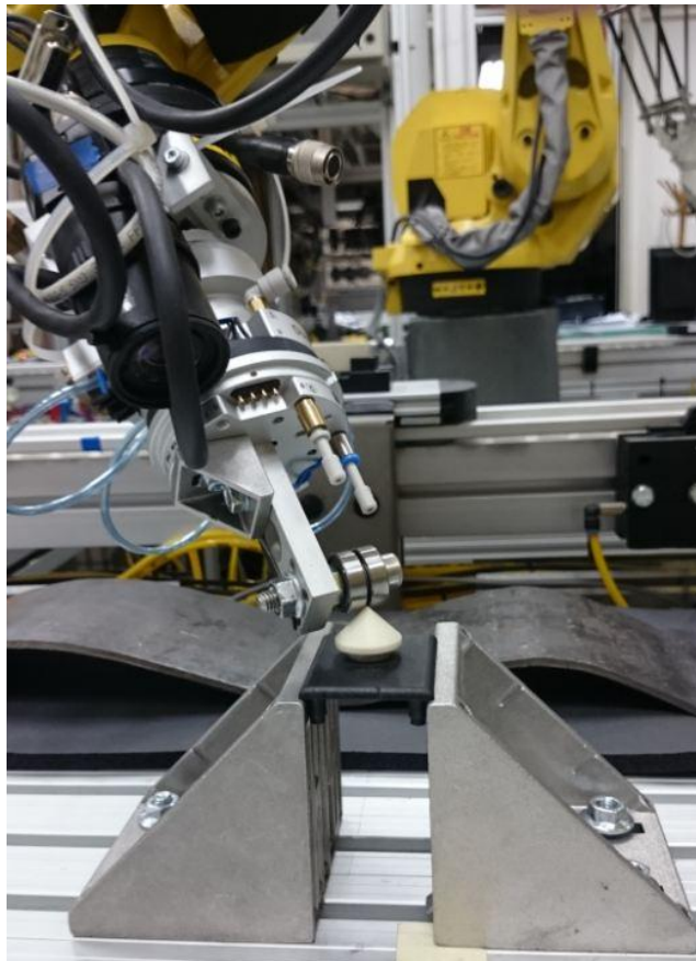
Slika 8. Dovođenje vrha alata u fiksnu točku
