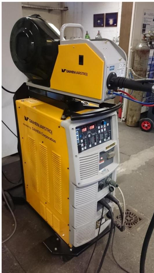
Slika 24. Izvor struje za zavarivanje WB - P500L
