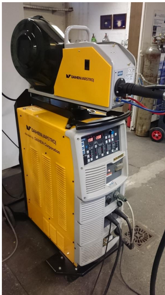
Slika 24. Izvor struje za zavarivanje WB - P500L
