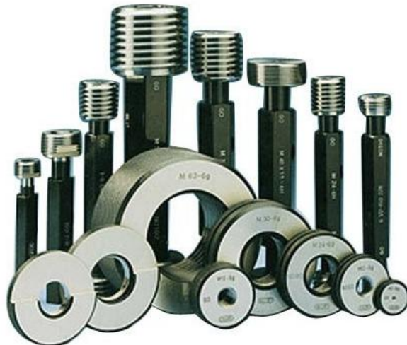
Slika 6. Granična mjerila za srednji promjer
