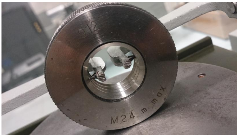
Slika 17. Mjerenje jednostavnog srednjeg promjera metodom s mjernim čeljustima
