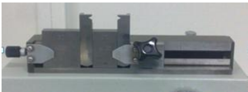
Slika 16. Stezna naprava za mjerke s V-utorom
