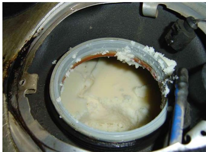
Slika 17. Nakupine voska na filteru u dizelskom motoru [8]
