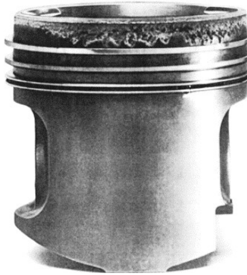
Slika 15. Oštećen klip kao posljedica udaranja u Ottovom motoru [8]
