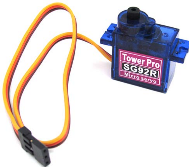
Slika 9. Električni motor Tower pro Micro Servo SG92R
