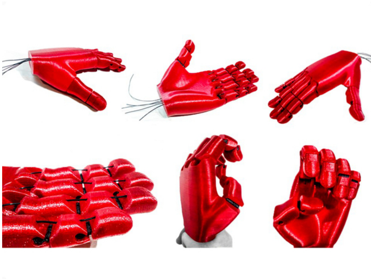
Slika 34. Animatronička šaka izrađena na 3D printeru
