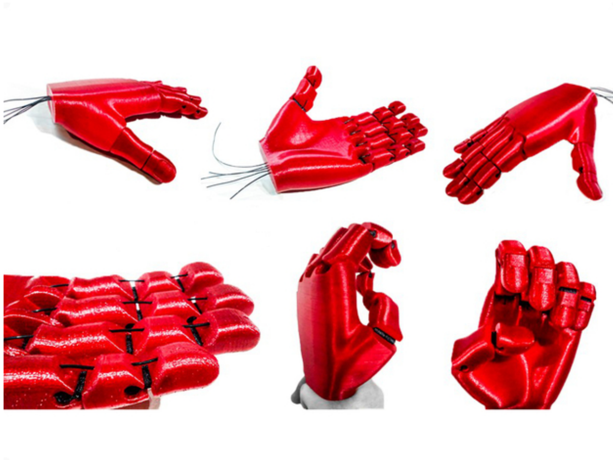
Slika 34. Animatronička šaka izrađena na 3D printeru
