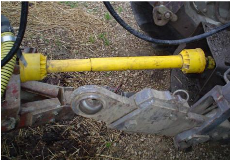
Slika 20. Priključak preko kardanskog vratila
