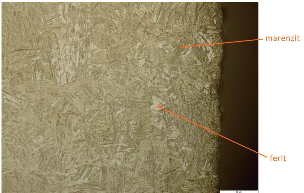
Slika 34. Mikrostruktura uzorka 2 u nagriženom stanju, povećanje 500x
