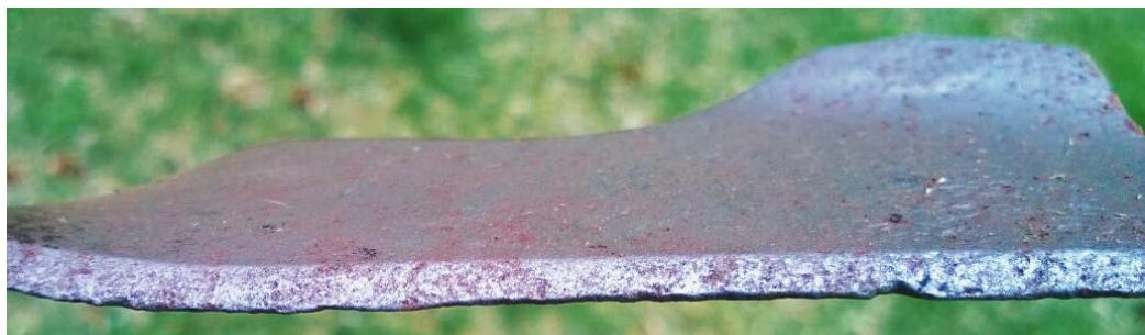
Slika 18. Potrošena oštrica noža nakon razdoblja vegetacije, [31]
