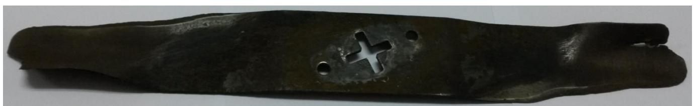
**Slika 21. Nož na kojem su provedena ispitivanja (pričvršćujući utor)**
