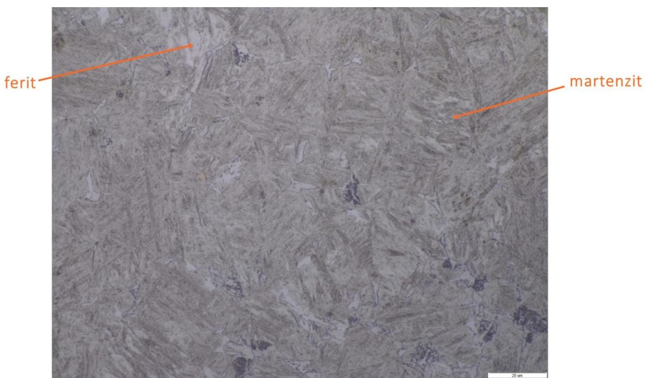
Slika 31. Mikrostruktura sredine uzorka 1 u nagriženom stanju, povećanje 1000x
