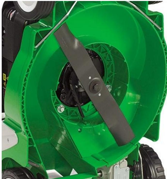
Slika 8. Bubanj kosilice sa rotirajućim nožem, [7]
