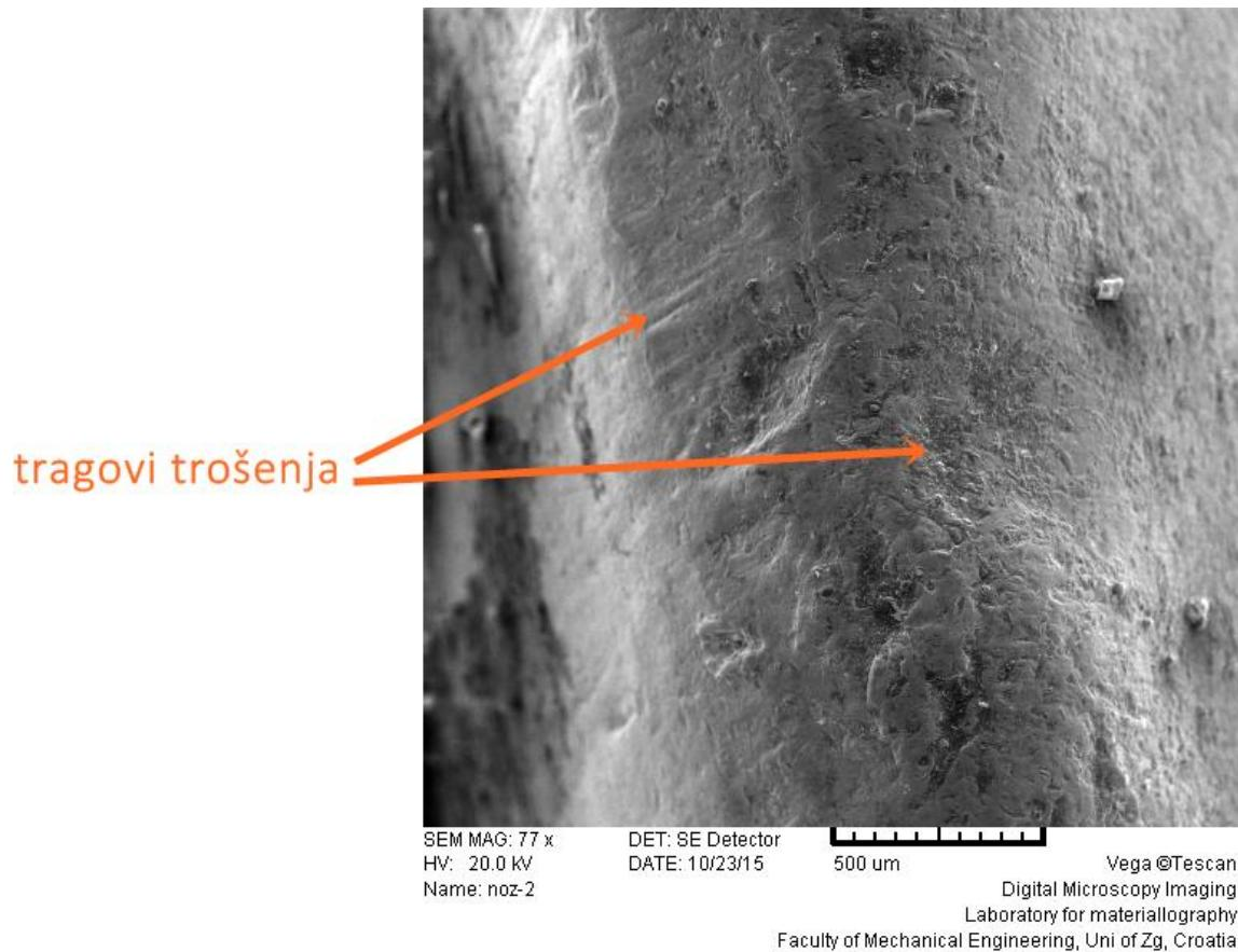
Slika 27. Prikaz oštice noža snimljene na SEM-u
