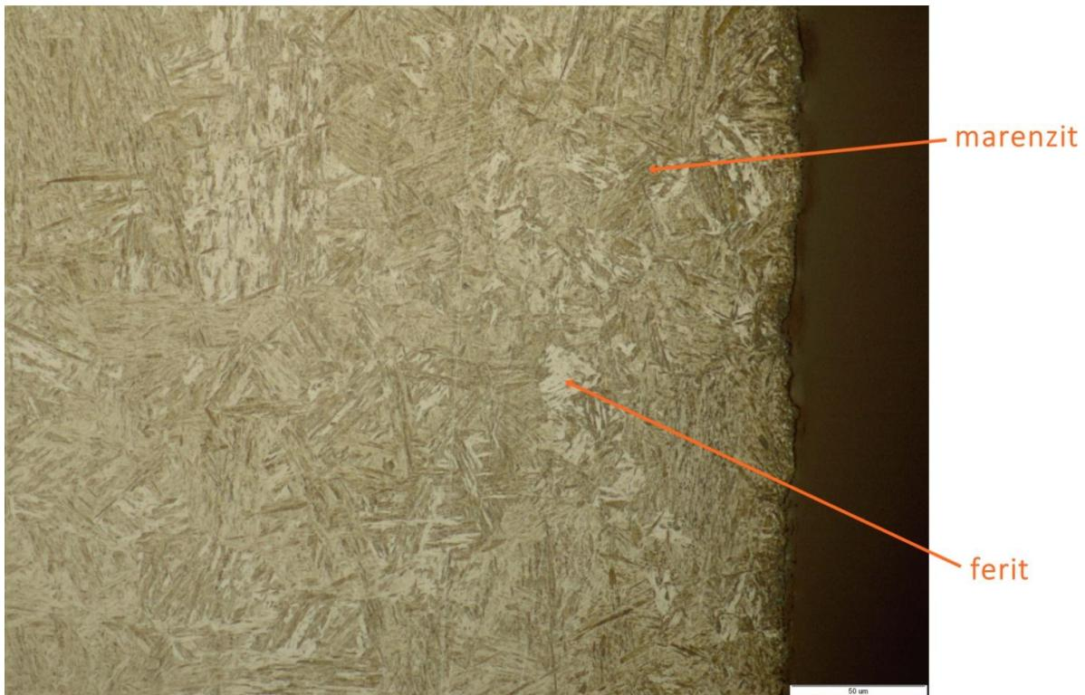
**Slika 34. Mikrostruktura uzorka 2 u nagriženom stanju, povećanje 500x**
