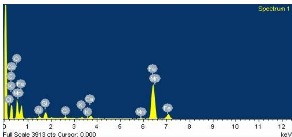
**Slika 40. Prikaz kemijskih elemenata oštice noža****Tablica 4. Atomski i maseni udio elemenata oštice noža**
