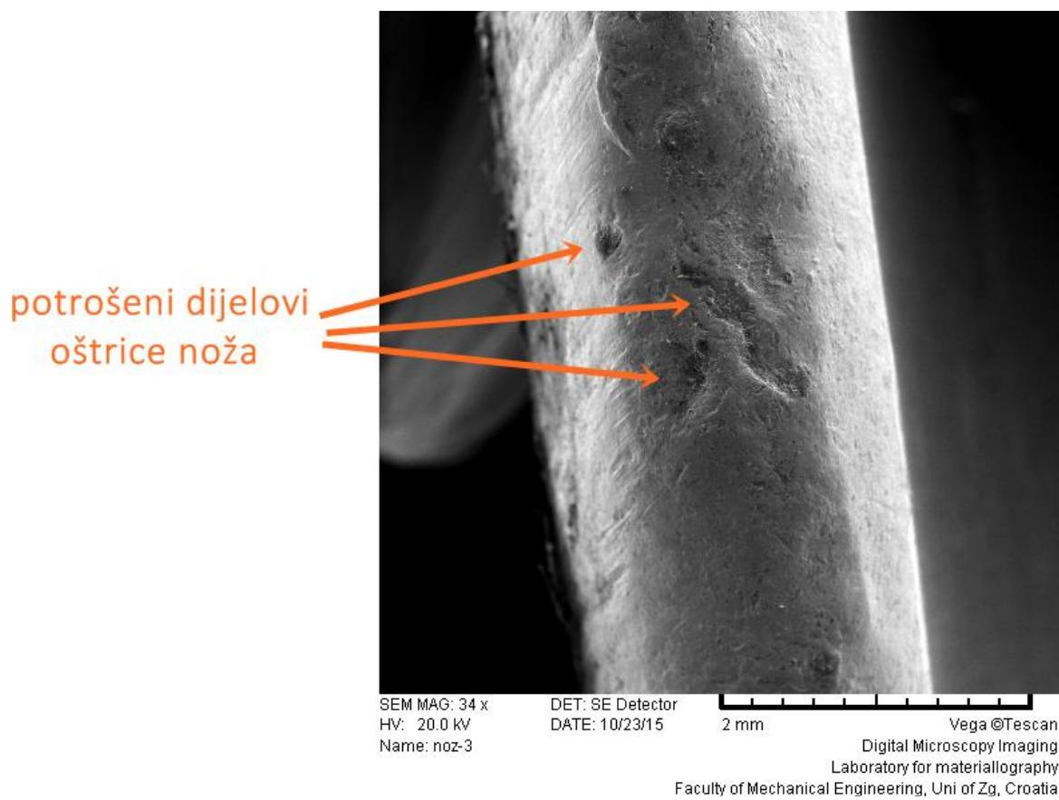
Slika 28. Prikaz oštice noža snimljene na SEM-u
