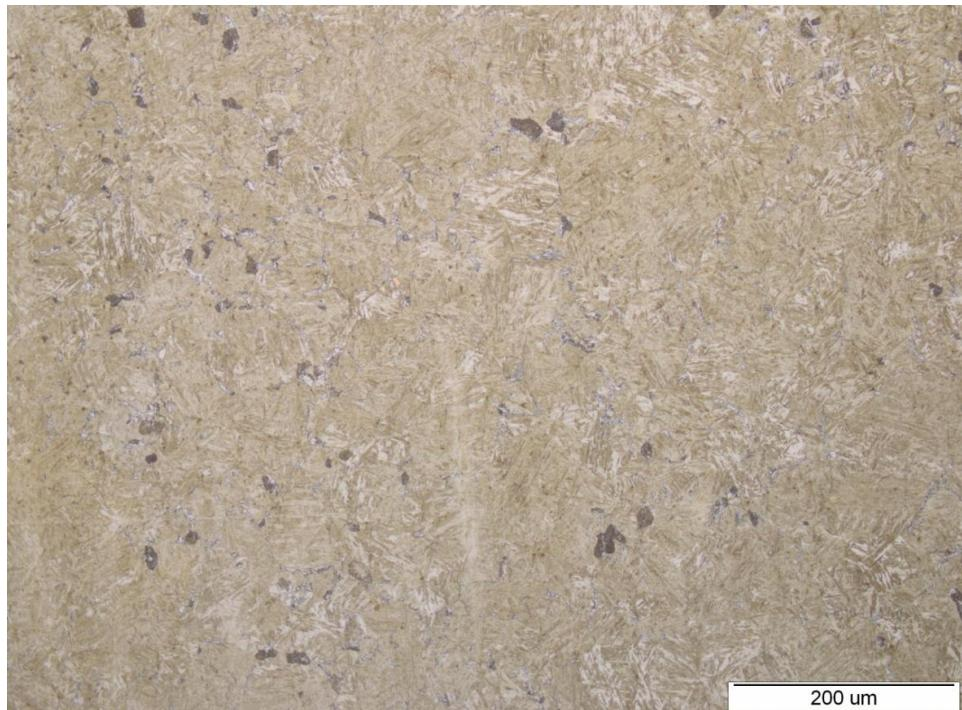
Slika 30. Mikrostruktura sredine uzorka 1 u nagriženom stanju, povećanje 200x
