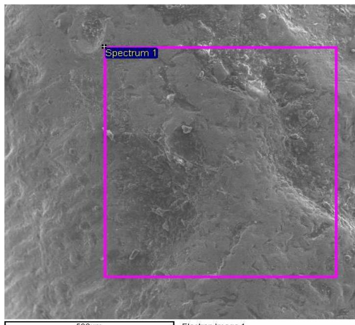
**Slika 39. EDS analiza oštice noža**
