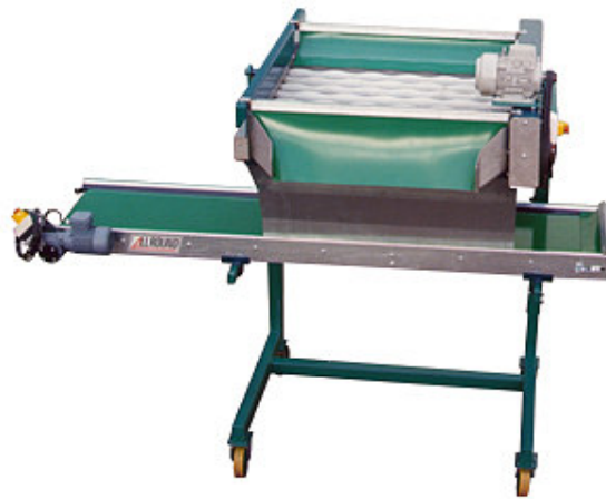
Slika 3.4. Stroj za četkanje krumpira Schouten
