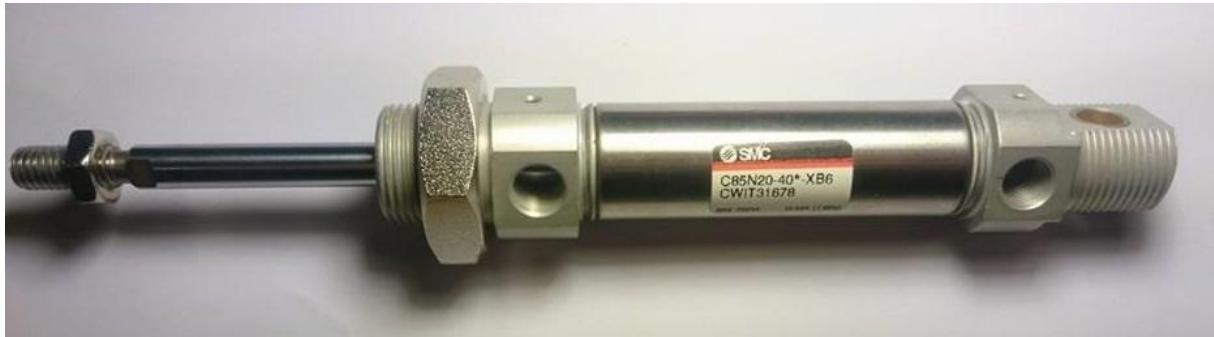
Slika 19. Cilindar C85N20-40\*-XB6
