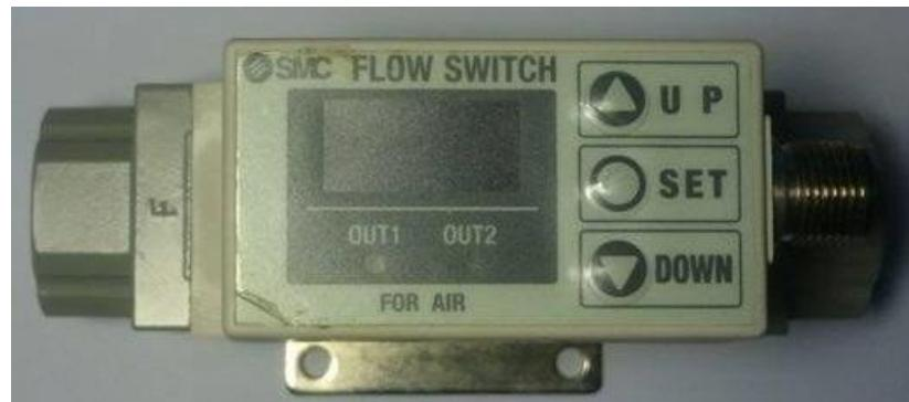
**Slika 60. Digitalni prekidač protoka**
