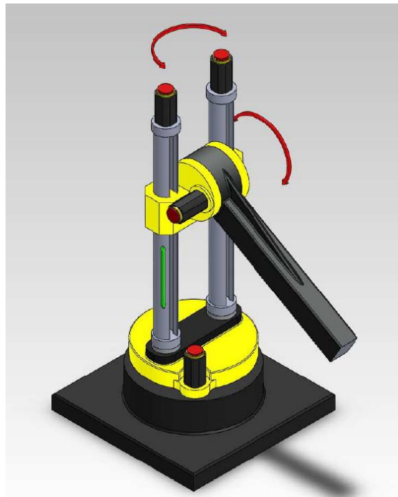
Slika 2. Stupnjevi slobode običnog manipulatora
