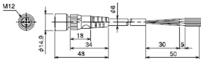
**Slika 65. Kabel za spajanje napajanja upravljačkog uređaja**
