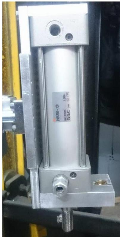
Slika 36. Spoj cilindra C95SB50-100
