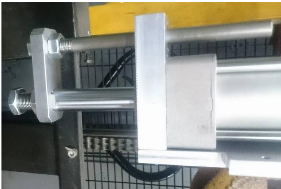
Slika 37. Vodilica cilindra C95SB50-100
