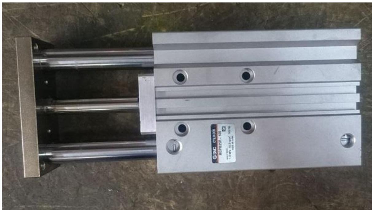
**Slika 16. Cilindar MGPM25R-100**
