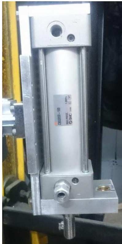
Slika 36. Spoj cilindra C95SB50-100
