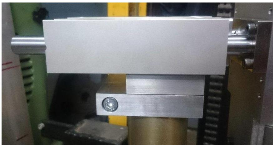
Slika 35. Spoj rotirajuće osovine i cilindra MGPM25R-100
