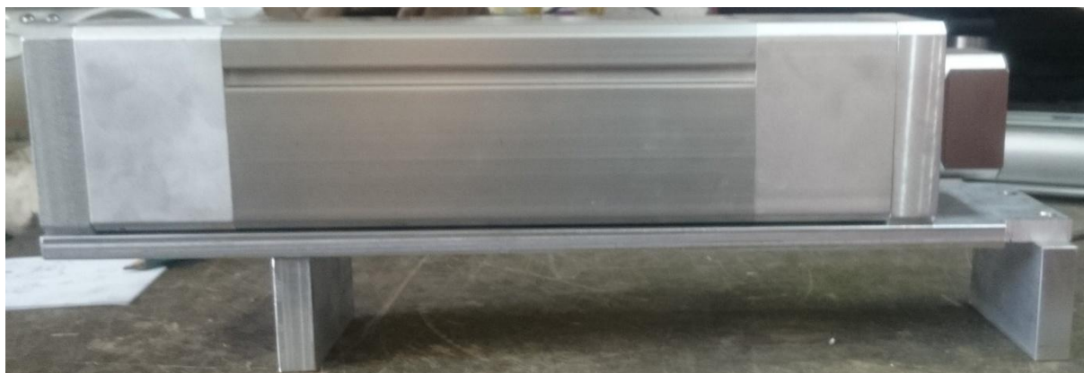
Slika 31. Nosač cilindra MGZ63TF-150
