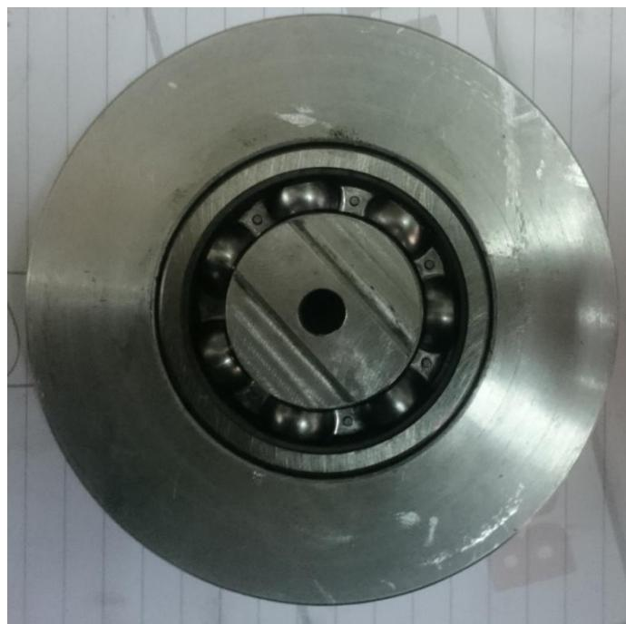
**Slika 27. Remenica 2 s kugličnim ležajem**
