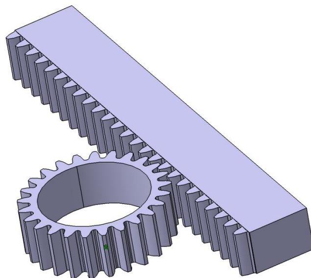
Slika 9. Prikaz spoja zupčanika i zupčaste letve
