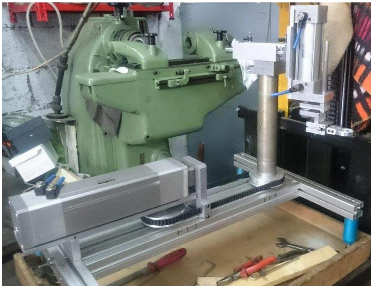
**Slika 22. Prikaz pneumatskog manipulatora**
