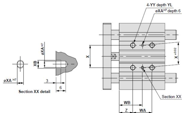
Slika 18. Prikaz definiranih dimezacija priključaka cilindra MGPM25R-100
