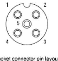
**Slika 66. Način spajanja napajanja upravljačkog uređaja**
