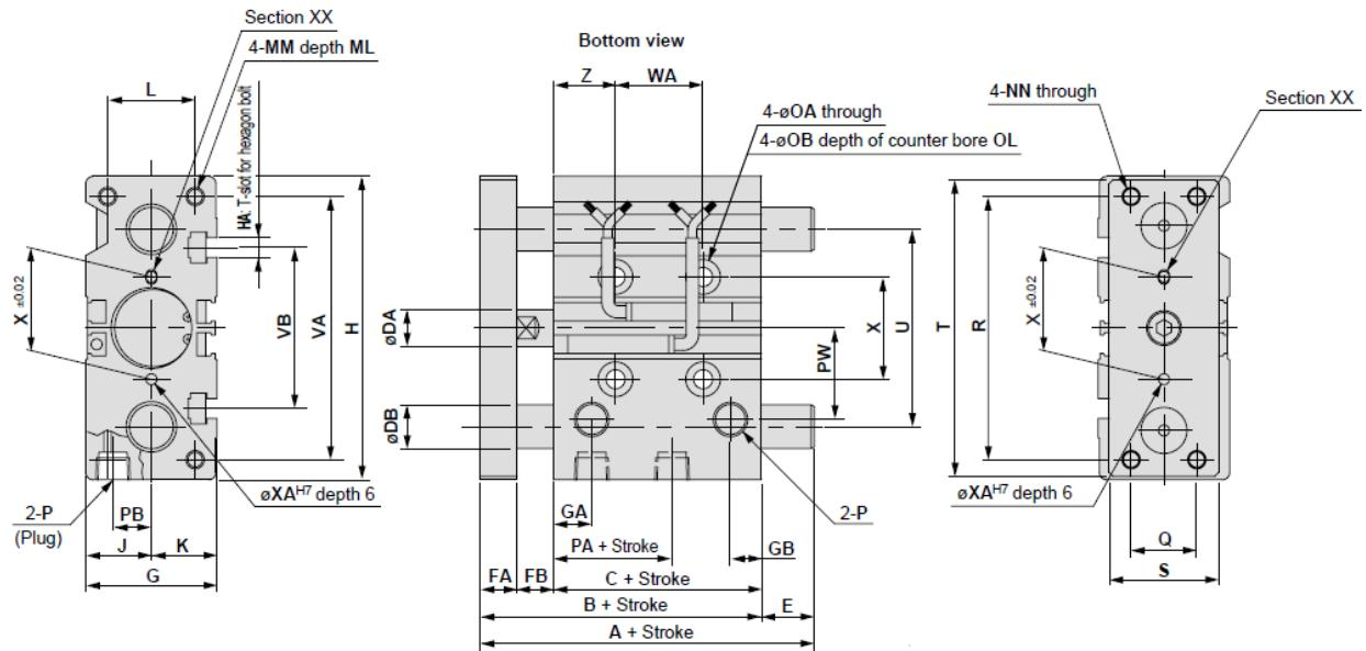
**Slika 17. Prikaz definiranih dimenzija za cilindar MGPM25R-100**
