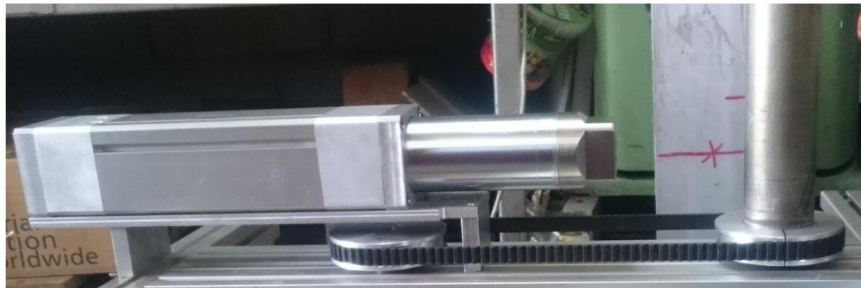
**Slika 32. Spoj nosača za cilindar za profilirani stol**
