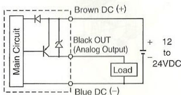
**Slika 58. PNP izlazni spoj za digitalni prekidač ZSE30**
