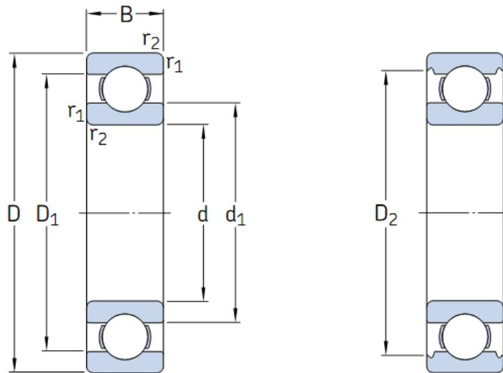
**Slika 29. Prikaz definiranih dimenzija kugličnog ležaja**
