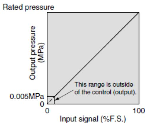
**Slika 55. Ulazno / izlazna karakteristika tlaka i električnog signala**
