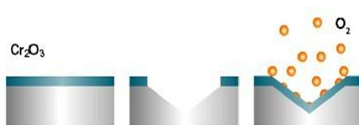
Slika 13. Pasivni sloj na nehrđajućem čeliku [12]
