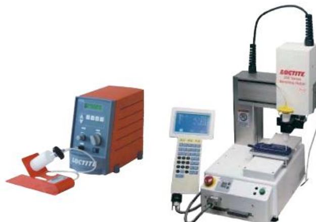
Slika 15. Poluautomatski uređaj i robot za nanašanje ljepila [16]
