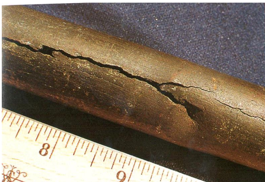
Slika 12. Pukotina uzrokovana napetosnom korozijom [13]
