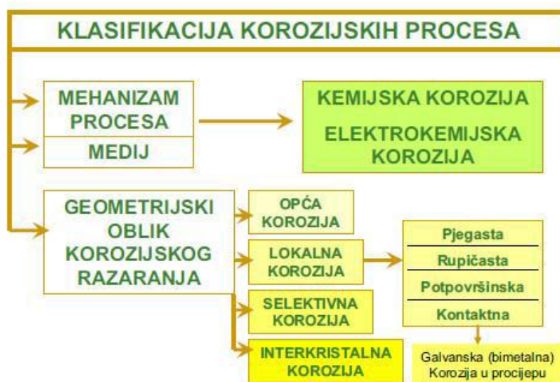
Slika 2. Klasifikacija korozijskih procesa [1]
