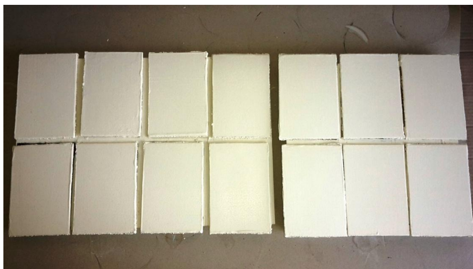
Slika 22. Uzorci sa nanesenom protupožarnom bojom
