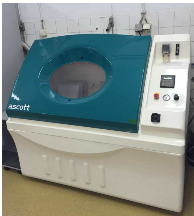
Slika 24. Slana komora, Laboratorij za zaštitu materijala, FSB
